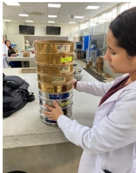
Ilustración 5. Granulometría de los agregados
