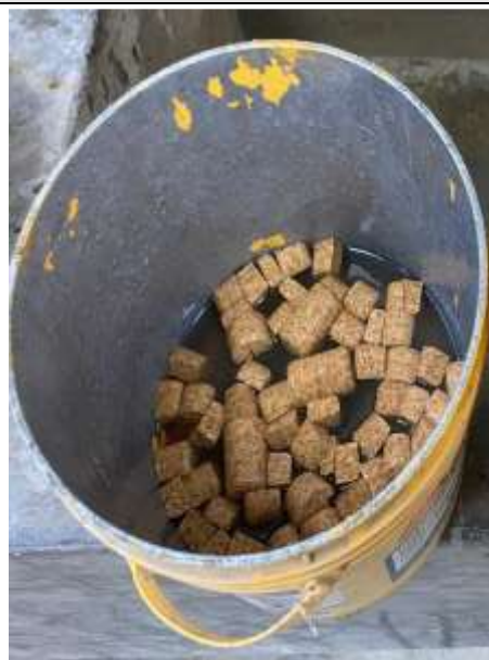
Figura N°137. Muestra 2 del corcho secado en horno (50.38 gr.).
