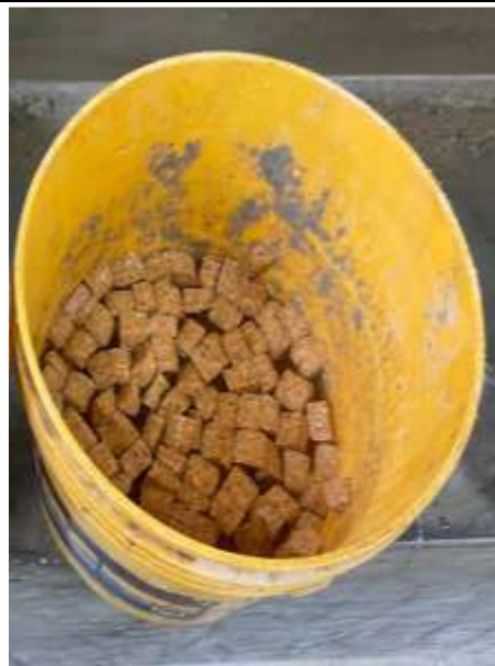
Figura N°133. Muestra 1 del corcho secado en horno (50.16 gr).
