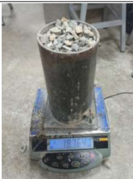
Figura N°113. Peso 3 de la muestra + recipiente (18.764 kg.).
