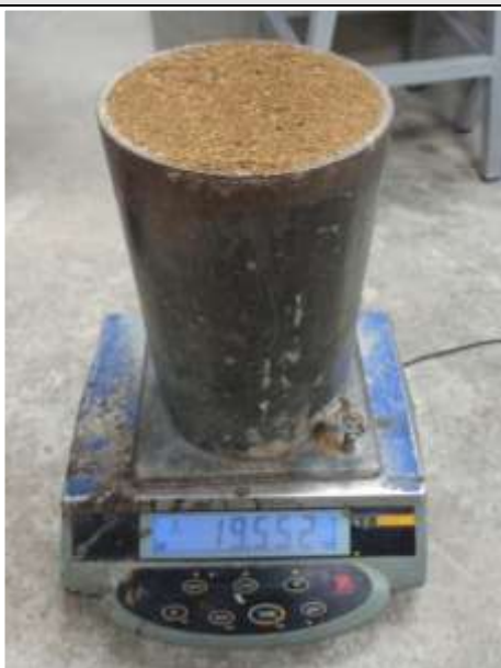
Figura N°108. Peso 2 de la muestra + recipiente (19.552 kg.).
