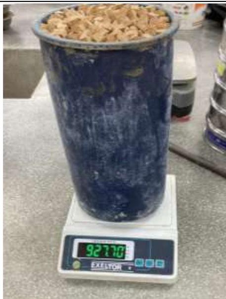
Figura N°140. Peso del corcho en recipiente (927.70 gr.).
