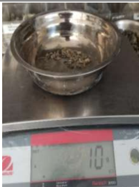
Figura N°69. Agregado fino retenido en el fondo (40 gr.).
