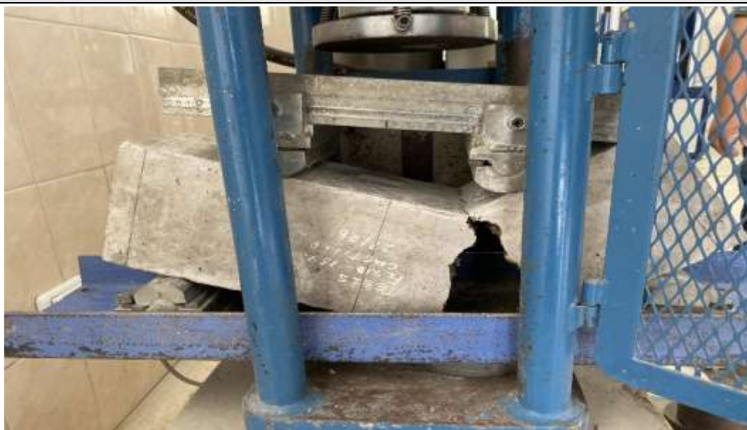
Figura N°179. Ensayo a flexión 15% Patrón - falla
