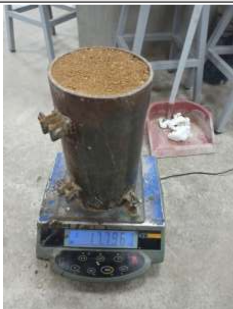
Figura N°100. Peso 2 de la muestra + recipiente (17.796 kg.).
