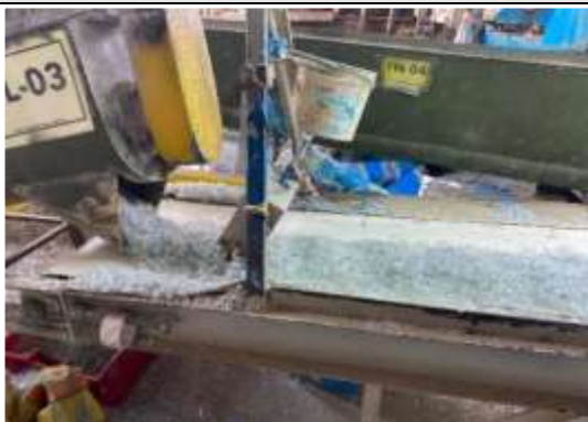
Figura N°39. Proceso de tamizado de plástico PET.
