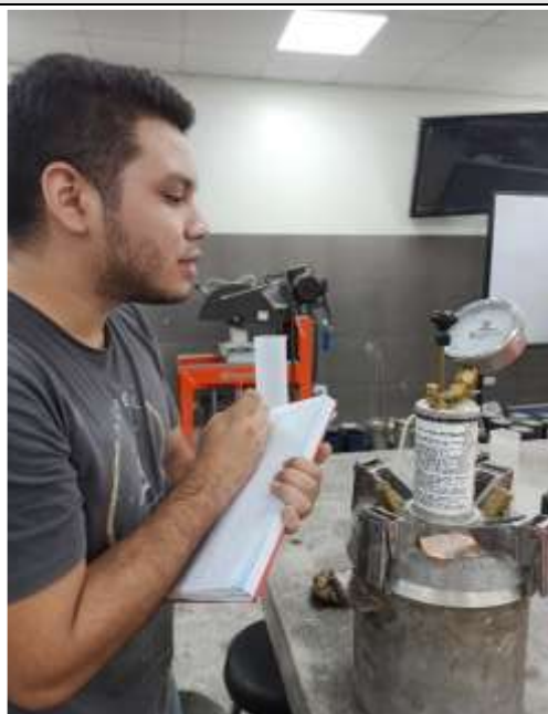
Figura N°151. Contenido de aire Diseño 15% (6%)
