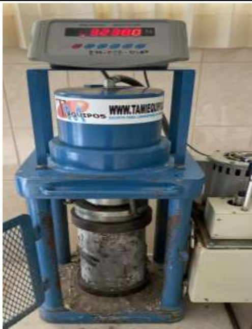
Figura N°158. Ensayo a la compresión Diseño 15%
