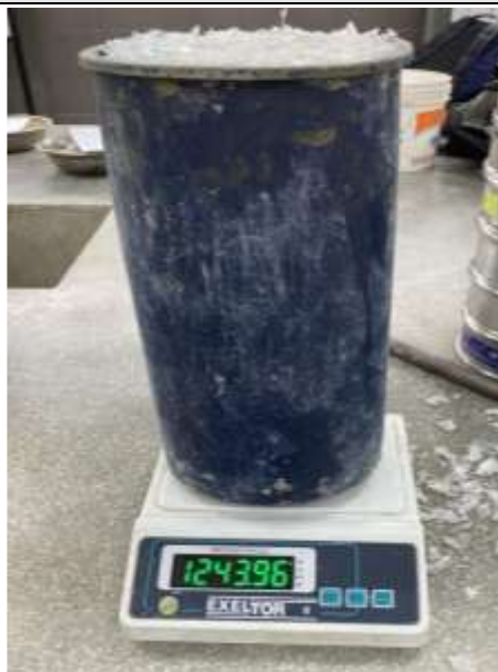
Figura N°141. Peso del PET en recipiente (1243.96 gr.).
