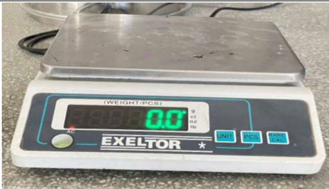
Figura N°181. Balanza electrónica con precisión de 0.5g ó 0.1% de la masa de la muestra.
