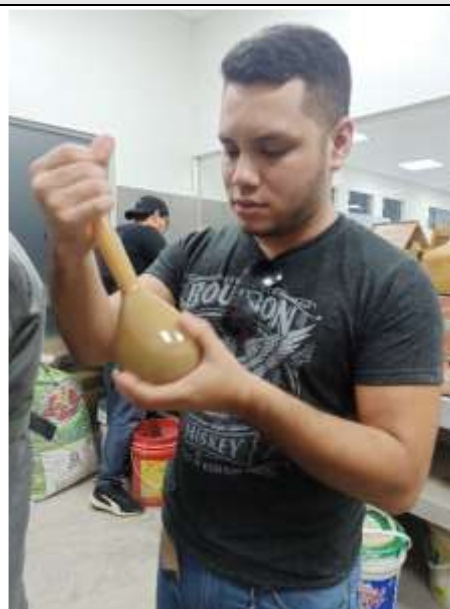
Figura N°81. Saturación de la muestra del agregado fino.
