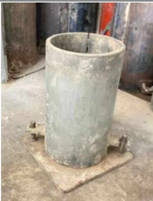
Figura N°195. Molde cilíndrico de Acero 6"x12"
