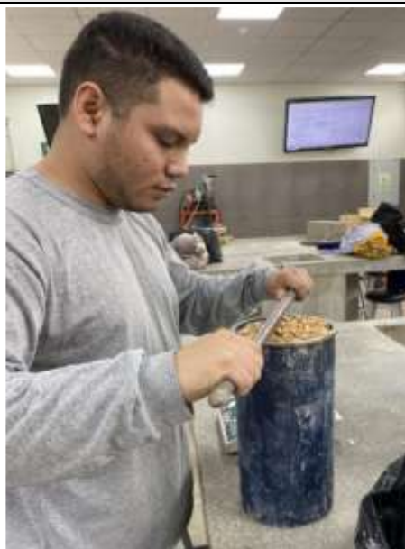
Figura N°141. Peso del PET en recipiente (1243.96 gr.).
