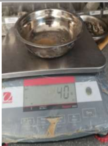
Figura N°69. Agregado fino retenido en el fondo (40 gr.).
