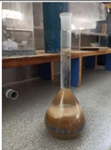
Figura N°85. Peso de la Muest. Seca al horno (486.53 gr.).
