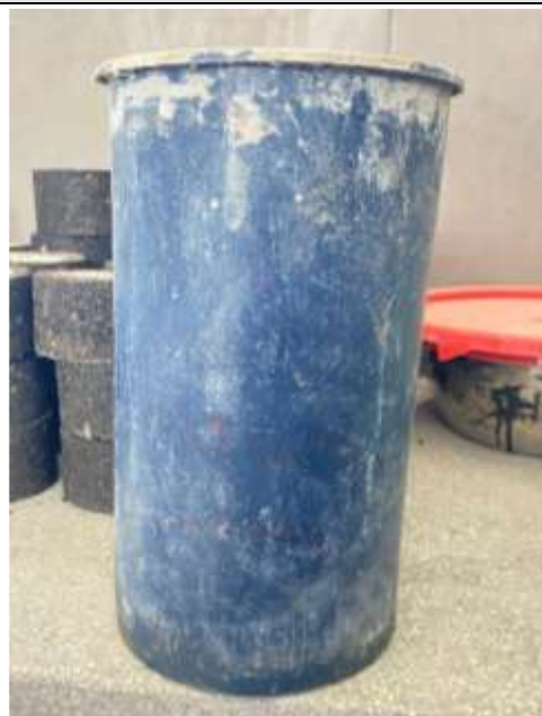
Figura N°196. Molde cilíndrico de Plástico 6"x12"
