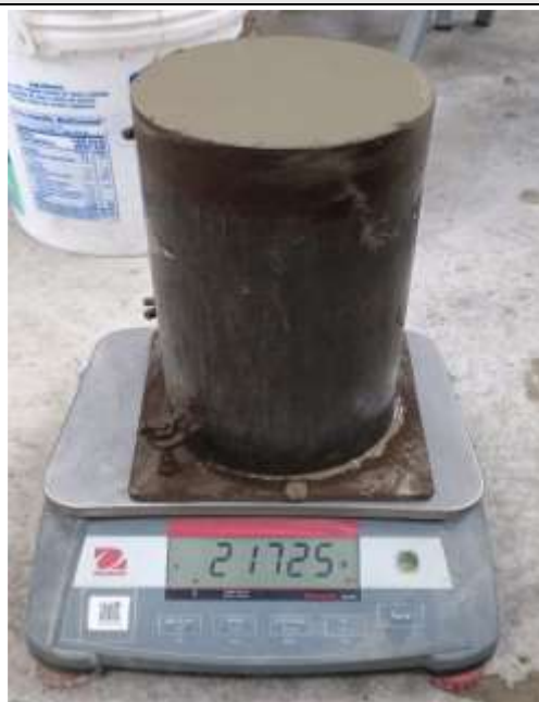
Figura N°148. Peso Unitario Diseño 10% (12440 gr)
