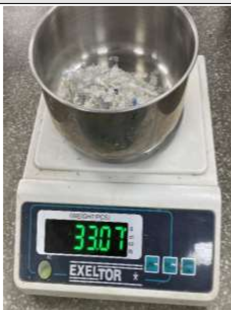
Figura N°124. Peso del PET retenida en la malla N°08 (33.07 gr.).
