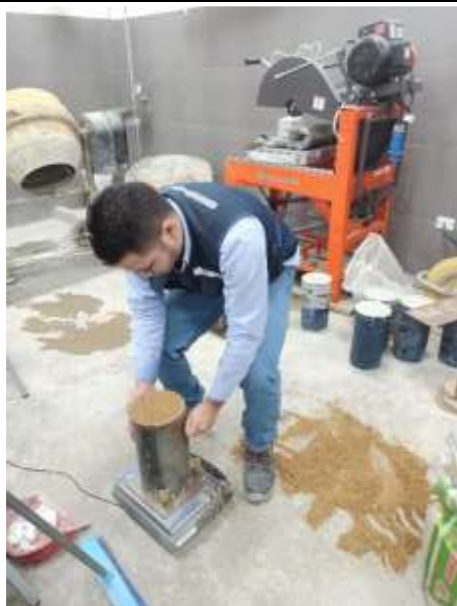
Figura N°100. Peso 2 de la muestra + recipiente (17.796 kg.).
