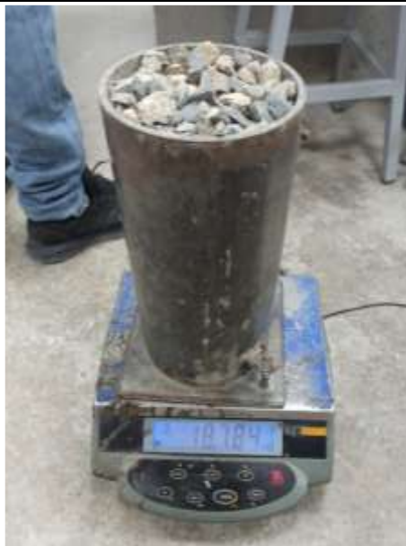
Figura N°113. Peso 3 de la muestra + recipiente (18.764 kg.).
