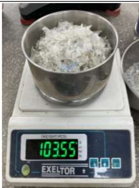
Figura N°125. Peso del PET retenida en la malla N°16 (2.11 gr.).
