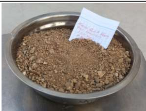
Figura N°32. Muestra de agregado fino de la Cantera la Victoria (Patapo).
