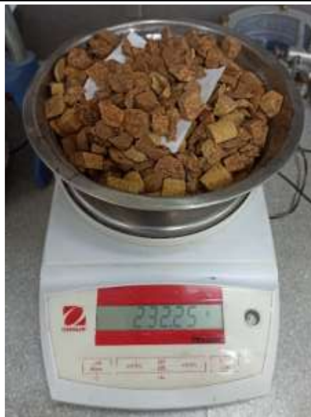
Figura N°129. Muestra 2 del corcho secado en horno (47.67 gr.).
