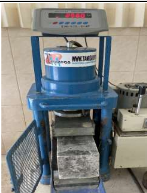
Figura N°176. Ensayo a flexión 10% Patrón - falla
