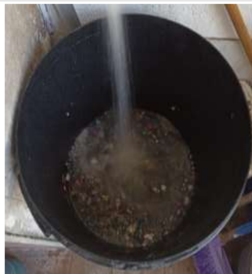
Figura N°38. Limpeza del plástico PET triturado.
