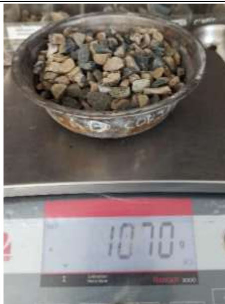
Figura N°65. Agregado fino retenido en el tamiz 3/8" (1070 gr).
