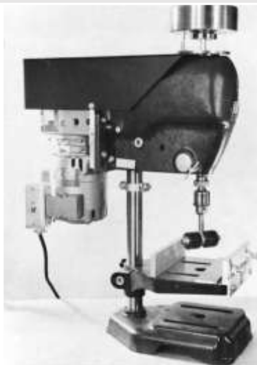
Figura N°12. Ensayo de Abrasion (Rotating-Cutter Drill Press).
