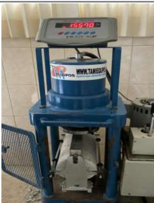
Figura N°162. Ensayo a la tracción Diseño 5%
