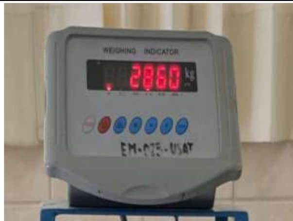
Figura N°169. Diseño Patrón carga = 2860 kg
