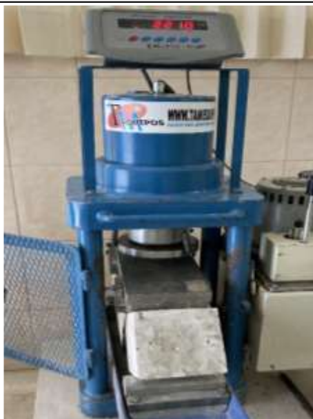
Figura N°179. Ensayo a flexión 15% Patrón - falla
