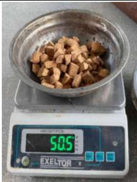
Figura N°132. Muestra 1 del corcho saturado (65.77 gr).
