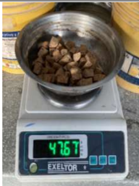
Figura N°129. Muestra 2 del corcho secado en horno (47.67 gr.).
