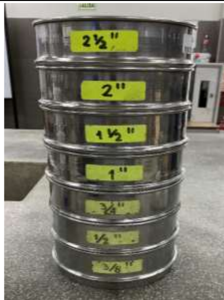
Figura N°121. Peso del PET retenida en la malla 1/2\" (8.18 gr.).
