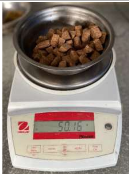
Figura N°133. Muestra 1 del corcho secado en horno (50.16 gr).
