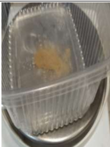
Figura N°56. Agregado fino retenido en el tamiz N°100 (80.40 gr.).
