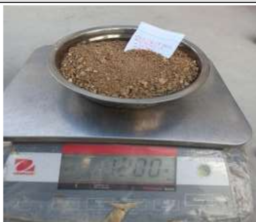
Figura N°73. Peso del agregado fino para ensayo de contenido de humedad (1200 gr.).
