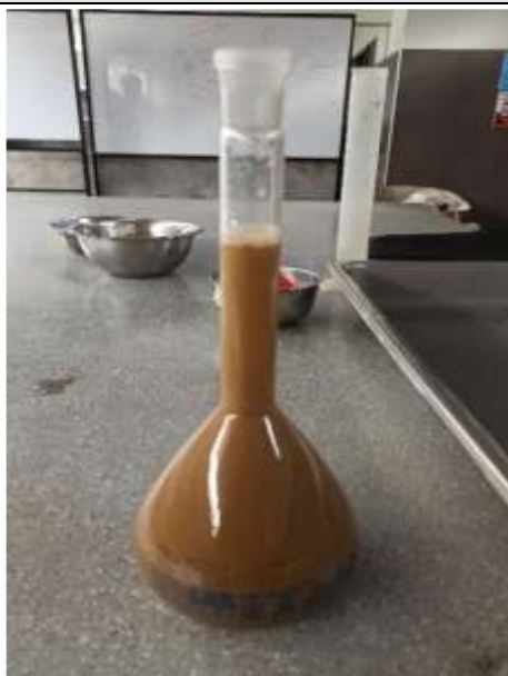
Figura N°84. Peso de la Muest. Sat. Sup. Seca + Peso frasco + Peso del agua (1051.10 gr.).
