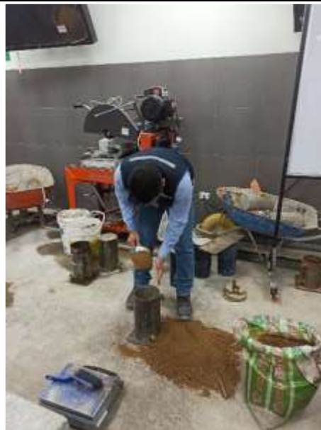
Figura N°97. Llenado del molde con agregado fino tercera capa (enrace).
