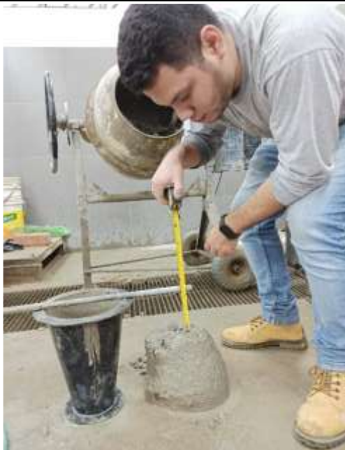
Figura N°144. Asentamiento Diseño 10% (Slump 2")
