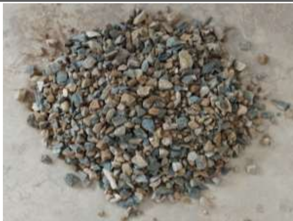
Figura N°34. Muestra de agregado grueso de la Cantera Tres Tomas (Ferreñafe).
