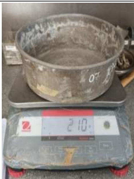
Figura N°68. Agregado fino retenido en el tamiz N°16 (210 gr.).
