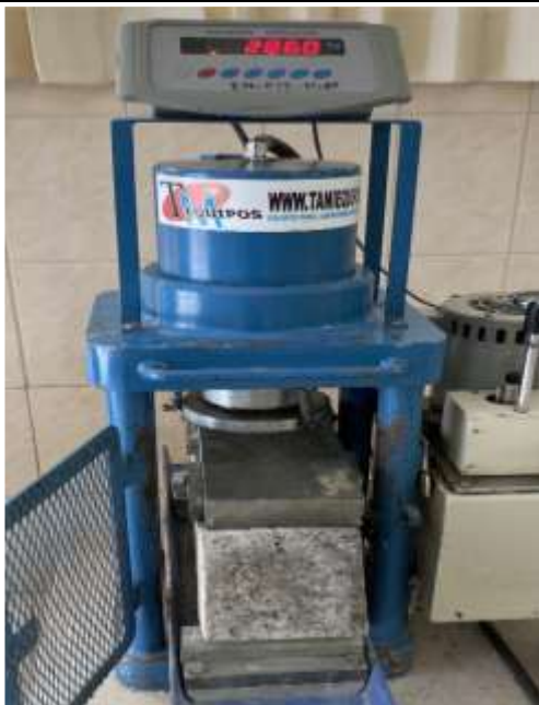
Figura N°170. Ensayo a flexión Diseño Patrón - falla
