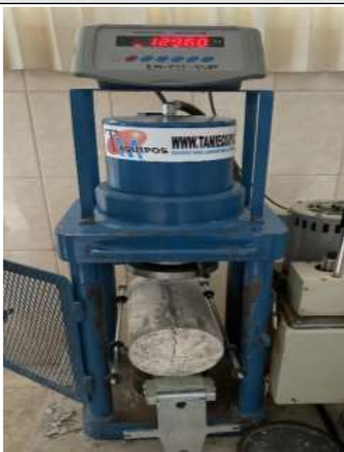
Figura N°166. Ensayo a la tracción Diseño 15%
