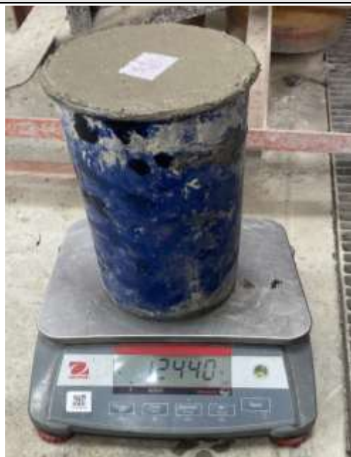
Figura N°148. Peso Unitario Diseño 10% (12440 gr)
