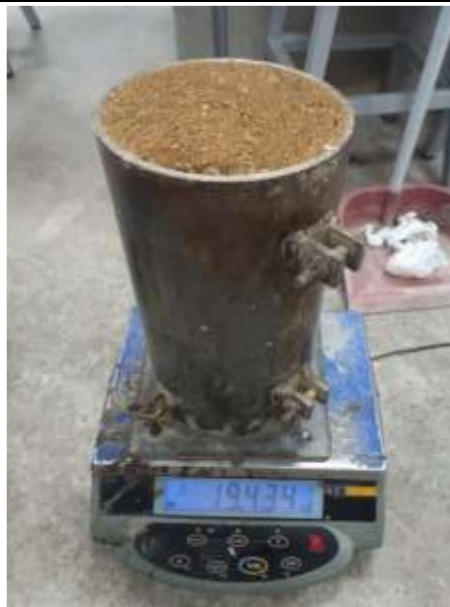
Figura N°109. Peso 3 de la muestra + recipiente (19.548 kg.).
