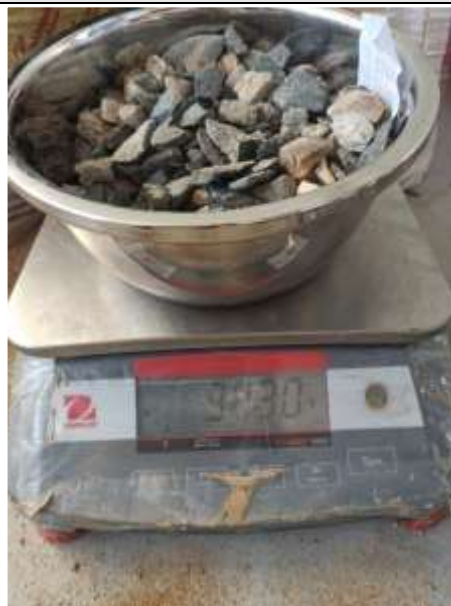
Figura N°93. Peso de la muestra secada al horno.
