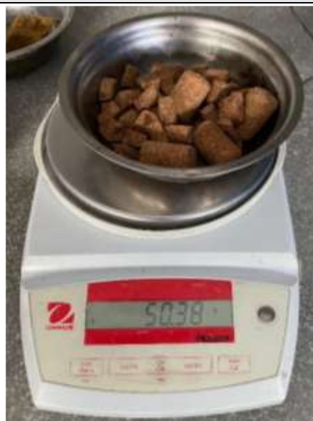
Figura N°137. Muestra 2 del corcho secado en horno (50.38 gr.).
