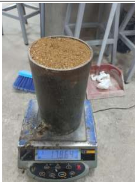
Figura N°101. Peso 3 de la muestra + recipiente (17.864 kg.).
