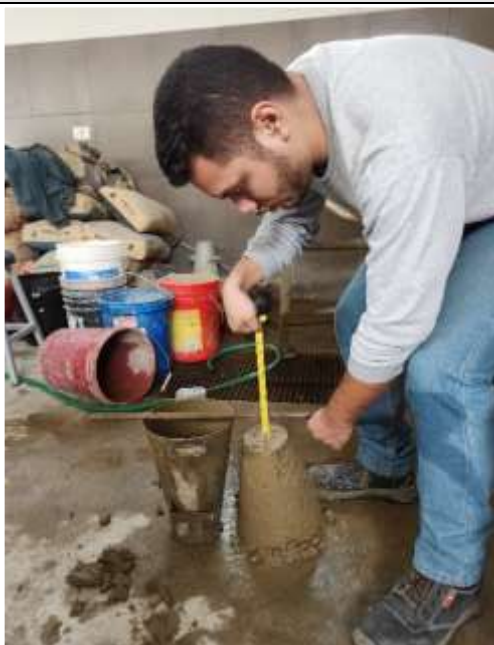
Figura N°144. Asentamiento Diseño 10% (Slump 2")
