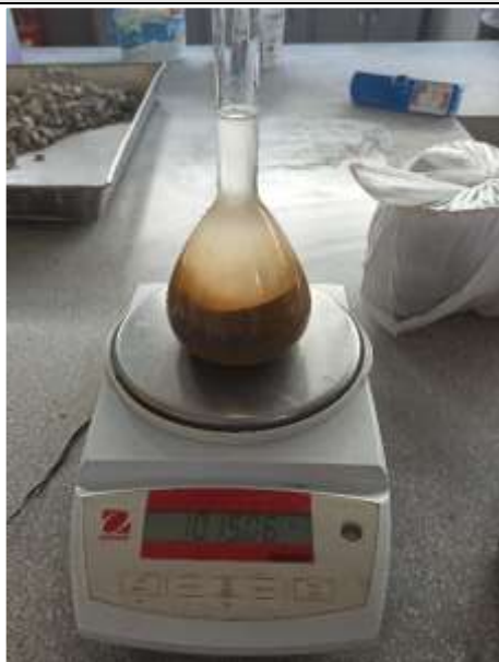
Figura N°84. Peso de la Muest. Sat. Sup. Seca + Peso frasco + Peso del agua (1051.10 gr.).
