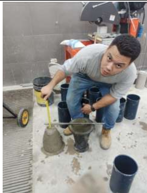
Figura N°145. Asentamiento Diseño 15% (Slump 0")
