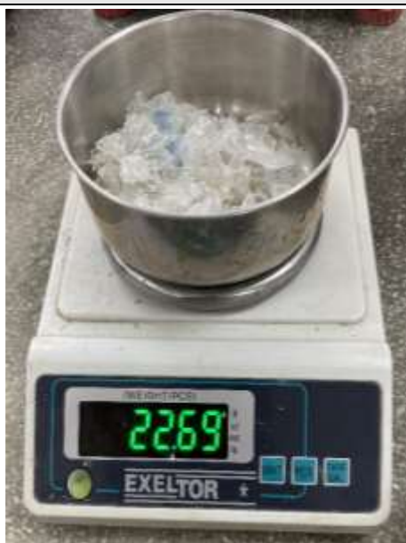
Figura N°124. Peso del PET retenida en la malla N°08 (33.07 gr.).
