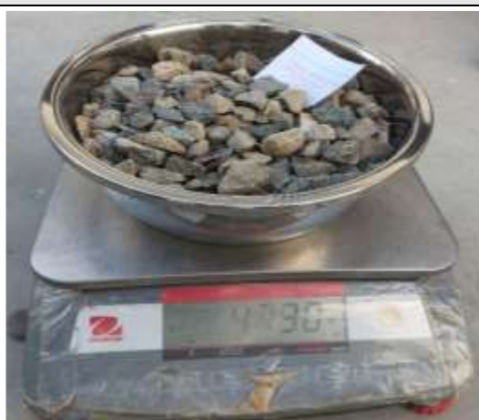
Figura N°77. Peso del agregado grueso para ensayo de contenido de humedad (4790 gr.).
