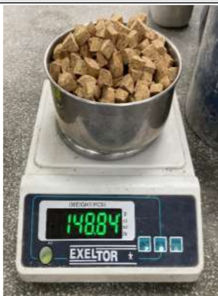
Figura N°117. Peso del corcho retenida en la malla 3/8\" (148.84 gr.).
