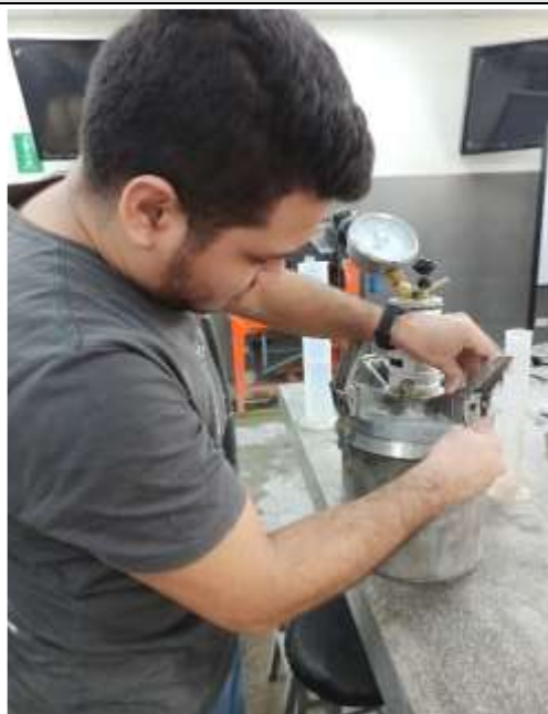
Figura N°151. Contenido de aire Diseño 15% (6%)
