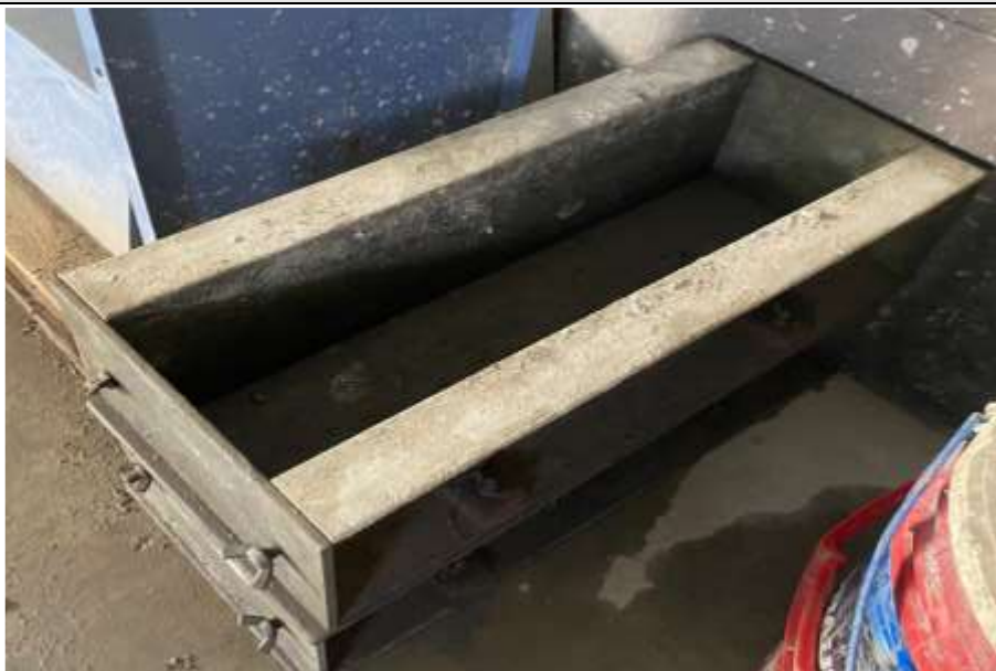
Figura N°207. Molde para vigueta
