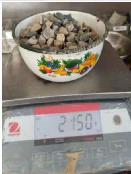
Figura N°64. Agregado grueso retenido en el tamiz 1/2" (2150 gr).
