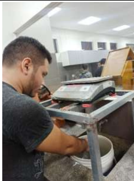
Figura N°93. Peso de la muestra secada al horno.
