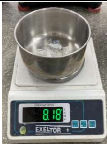
Figura N°121. Peso del PET retenida en la malla 1/2\" (8.18 gr.).
