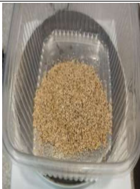
Figura N°53. Agregado fino retenido en el tamiz N°16 (82.30 gr.).
