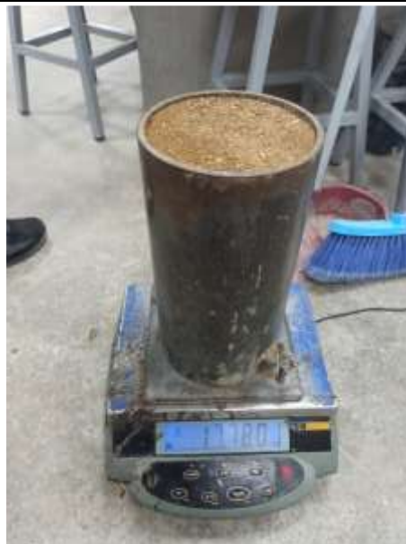
Figura N°101. Peso 3 de la muestra + recipiente (17.864 kg.).
