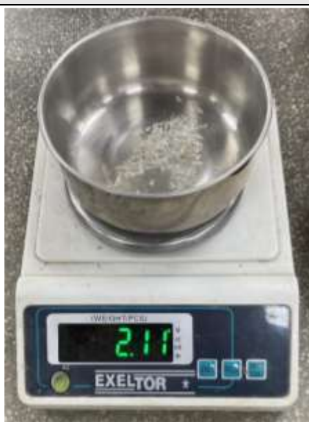
Figura N°125. Peso del PET retenida en la malla N°16 (2.11 gr.).
