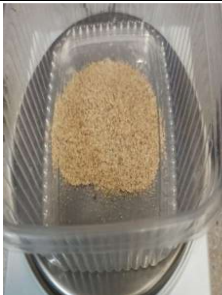
Figura N°56. Agregado fino retenido en el tamiz N°100 (80.40 gr.).
