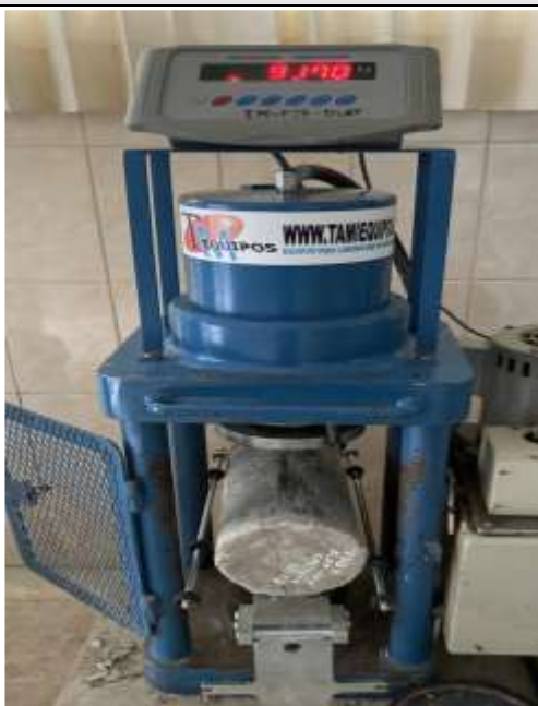
Figura N°166. Ensayo a la tracción Diseño 15%
