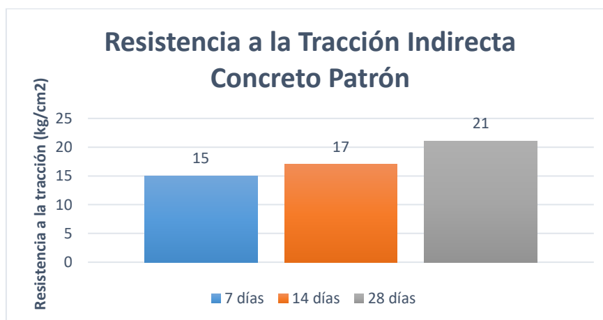
Gráfico N° 15. Ensayo de resistencia a la tracción indirecta en concreto Patrón resistencia f'c = 210 \text{ kg/cm}^2
