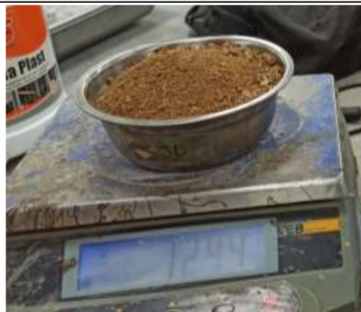
Figura N°73. Peso del agregado fino para ensayo de contenido de humedad (1200 gr.).
