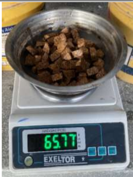
Figura N°132. Muestra 1 del corcho saturado (65.77 gr).
