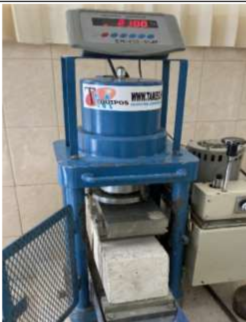
Figura N°173. Ensayo a flexión 5% Patrón - falla
