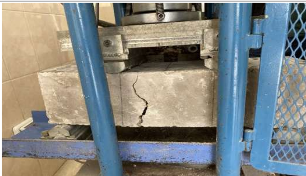
Figura N°176. Ensayo a flexión 10% Patrón - falla
