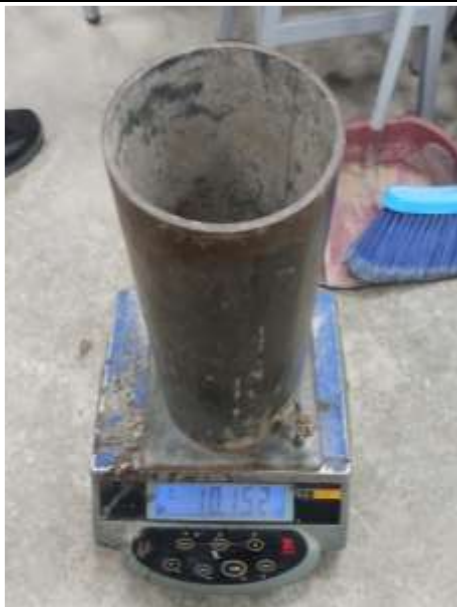
Figura N°112. Peso 2 de la muestra + recipiente (18.774 kg.).
