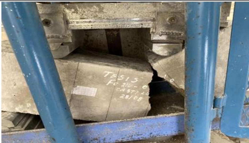
Figura N°170. Ensayo a flexión Diseño Patrón - falla
