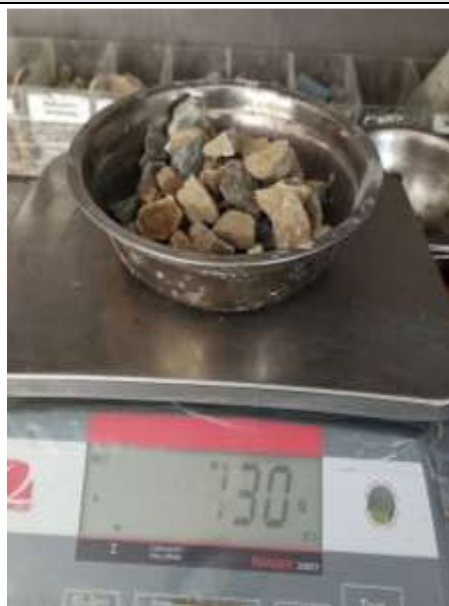
Figura N°65. Agregado fino retenido en el tamiz 3/8" (1070 gr).
