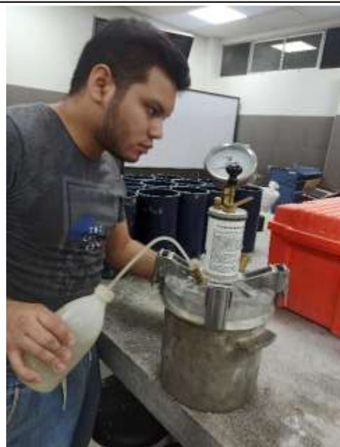
Figura N°150. Ensayo de Contenido de Aire Diseño 15%
