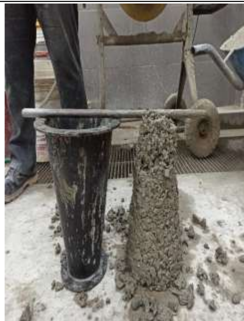
Figura N°145. Asentamiento Diseño 15% (Slump 0")
