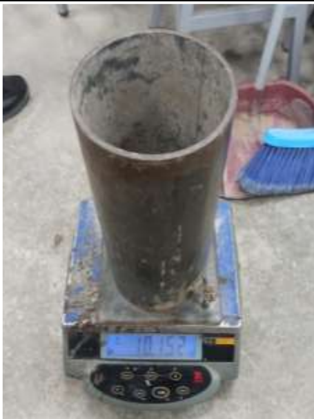
Figura N°96. Llenado del molde con agregado fino segunda capa.
