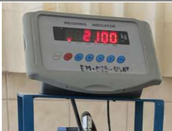
Figura N°172. Diseño 5% carga = 2100 kg
