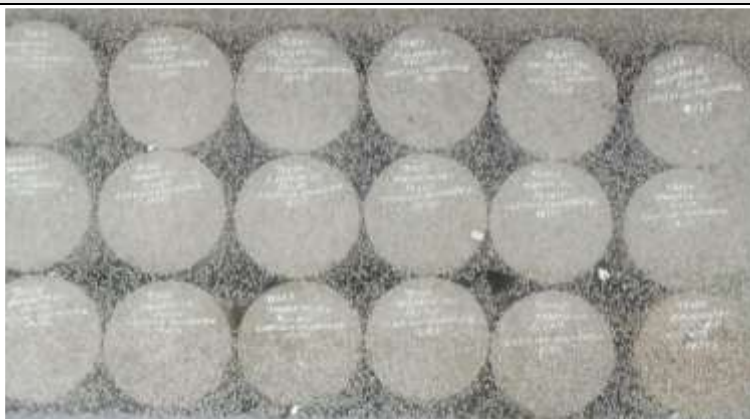
Figura N°09. Curado de probetas en pozas de curado en laboratorio USAT.
