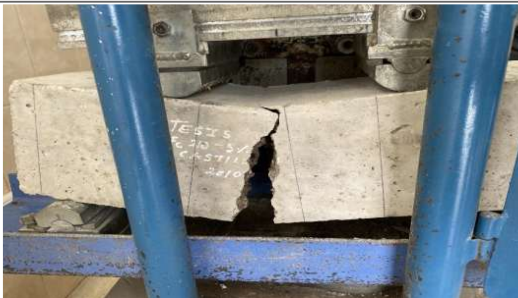
Figura N°173. Ensayo a flexión 5% Patrón - falla
