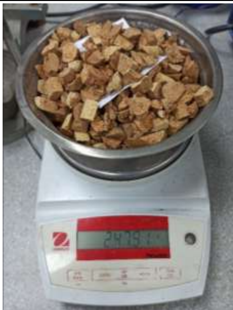
Figura N°128. Muestra 2 del corcho en estado natural (50.6 gr.).
