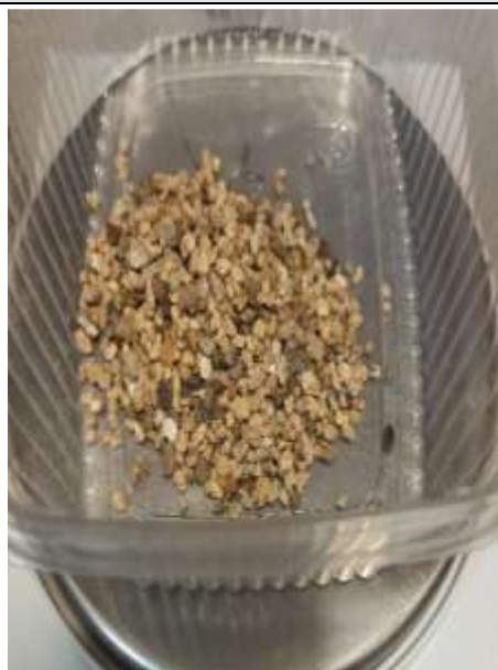
Figura N°53. Agregado fino retenido en el tamiz N°16 (82.30 gr.).
