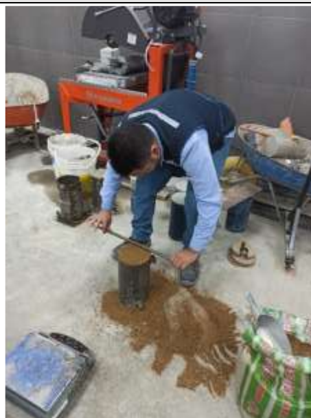
Figura N°97. Llenado del molde con agregado fino tercera capa (enrace).
