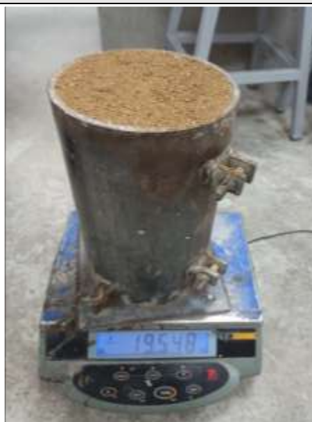
Figura N°109. Peso 3 de la muestra + recipiente (19.548 kg.).
