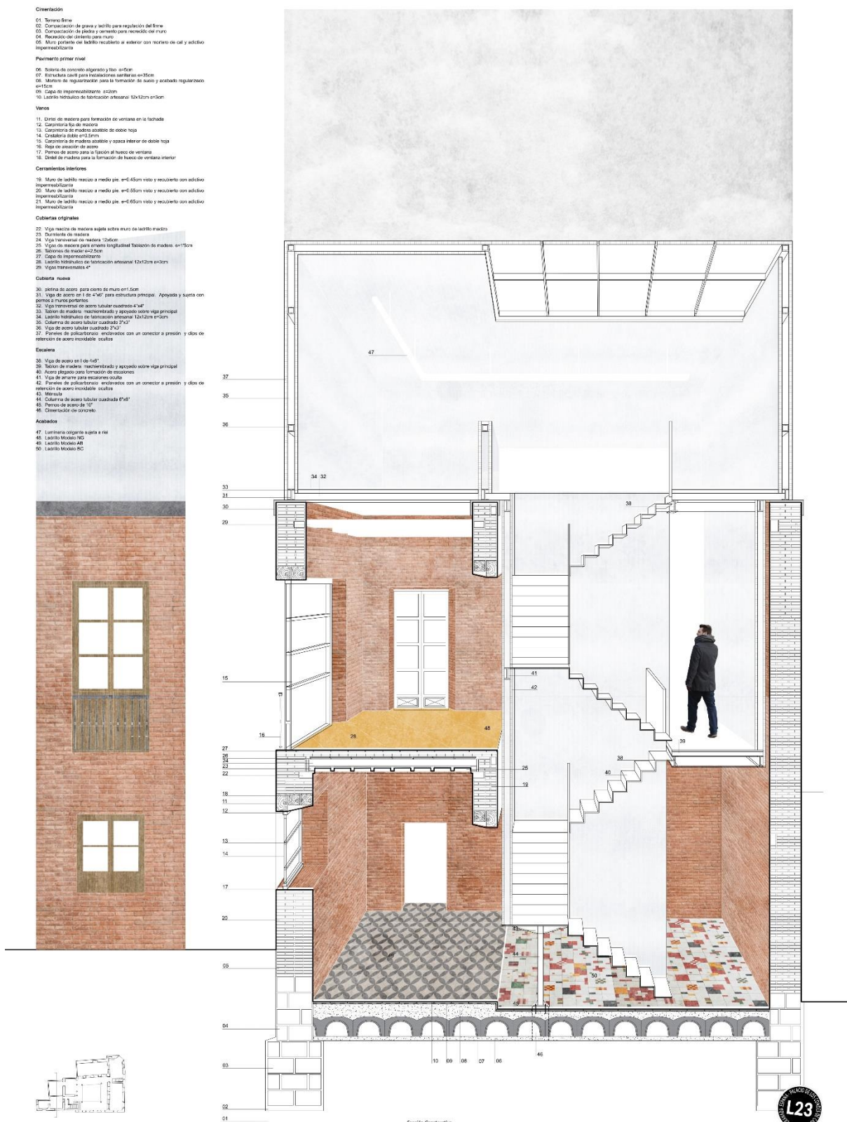
Sección Constructiva 2nd/3
