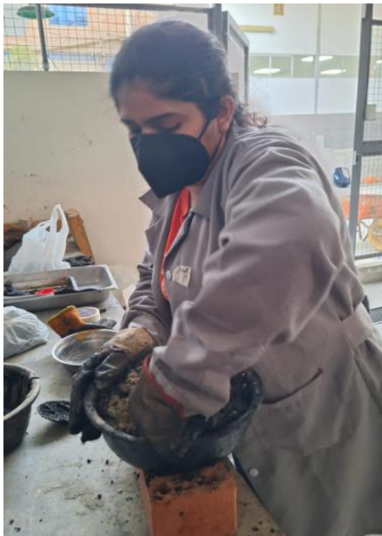
Ilustración 18: Desarrollo de la preparación de la mezcla asfáltica (Lab. USAT)
