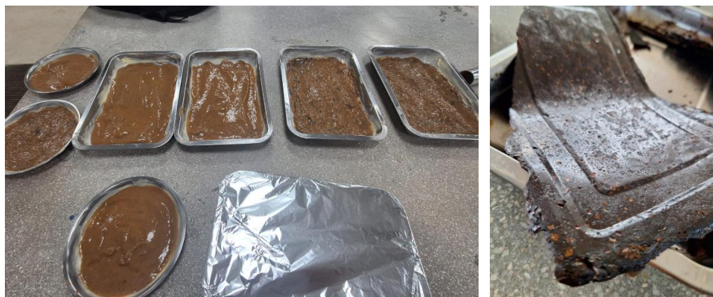
Ilustración 7: Muestra de la masa de biopolímero antes y después de ir al horno
