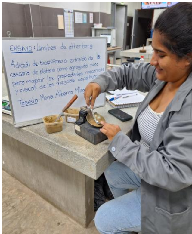
Ilustración 15: Desarrollo del ensayo de Límites de Atterberg
