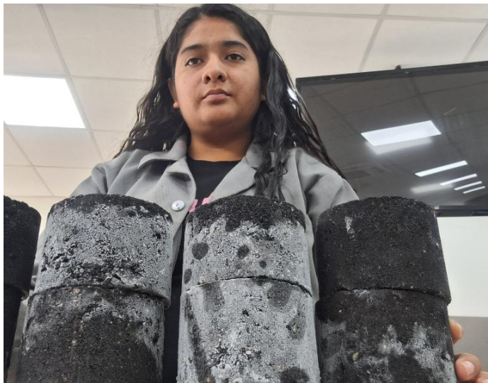
Ilustración 25: Desarrollo del Ensayo de Lottman Modificado
