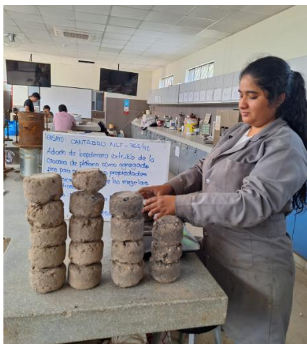
Ilustración 24: Desarrollo del ensayo de Cántabro NLT-362/92
