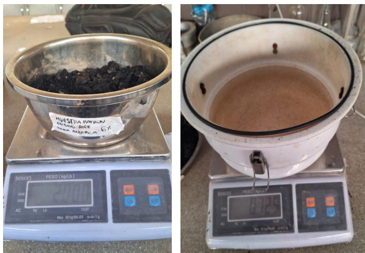
Ilustración 23: Desarrollo del Ensayo de Rice
