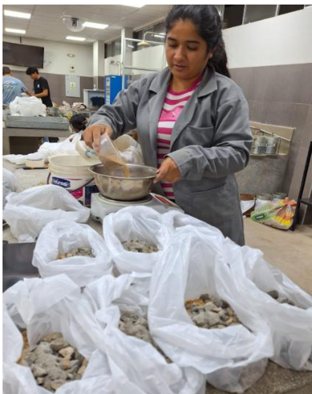
Ilustración 17: Desarrollo de la preparación de la mezcla asfáltica (Lab. USAT)
