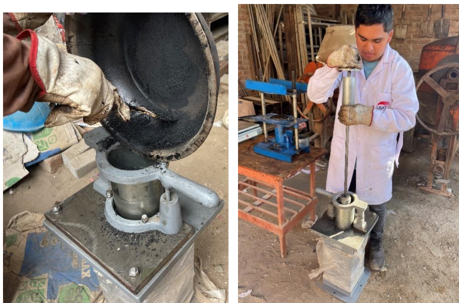
Figura 21. Compactación de la mezcla asfáltica
