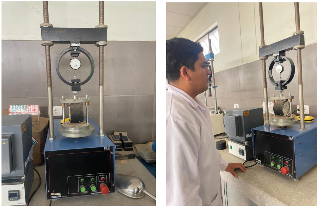
Figura 32. Aplicación de una carga de tensión indirecta en las briquetas
