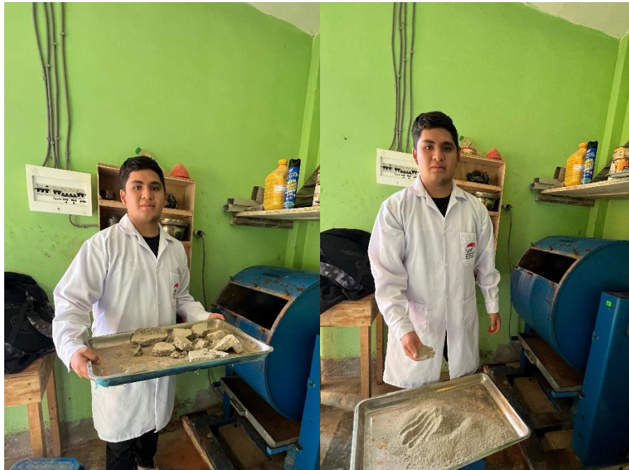
Figura 3. Trituración de concreto reciclado.
