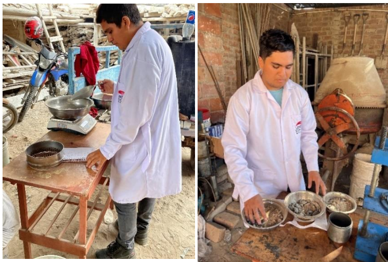
Figura 18. Dosificación de fibra de polipropileno
