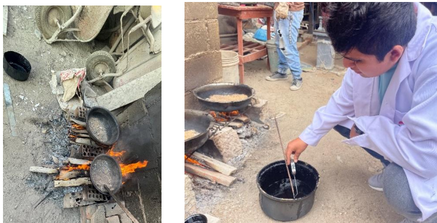
Figura 19. Calentamiento de los agregados y el betún
