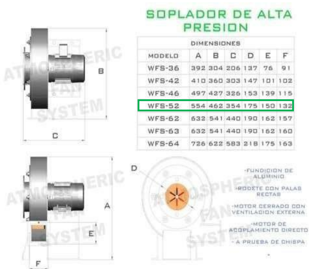
Figura 52:: Dimensiones del ventilador modelo WFS 52
