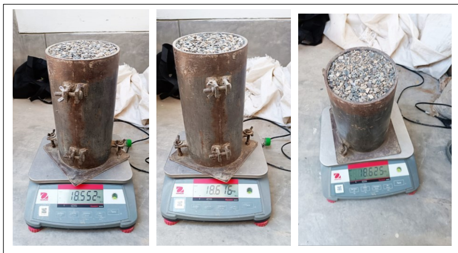
Ilustración 19 Procedimiento: Peso Unitario Compactado del confitillo
