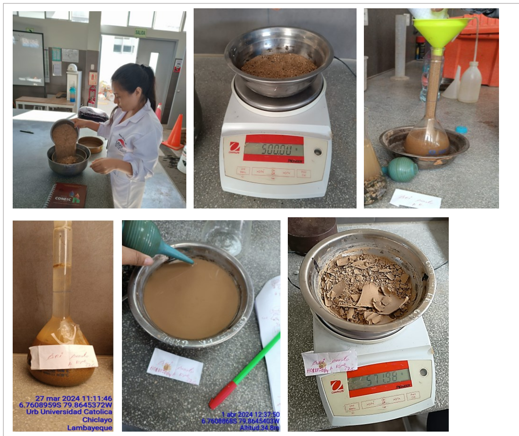
Ilustración 22 Procedimiento: Peso Específico y absorción del de la arena
