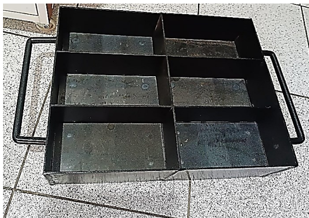
Ilustración 12 Molde para adoquines de (20 x 10 x 8) cm
