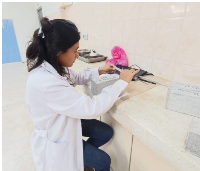
Ilustración 28 Procedimiento: Toma de medidas de los adoquines
