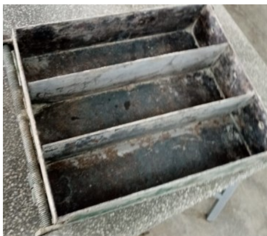
Ilustración 13 Molde para vigas prismáticas
