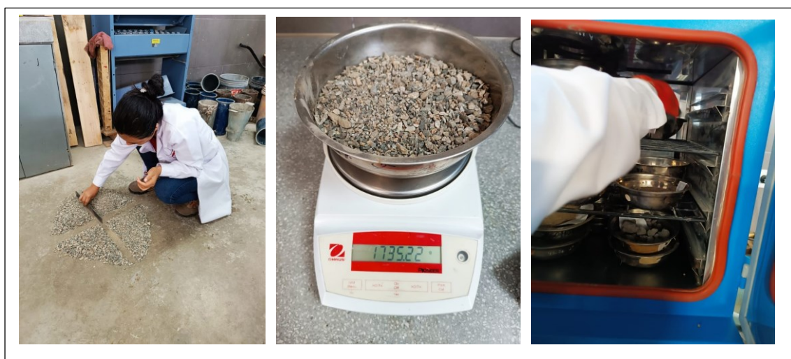
Ilustración 21 Procedimiento para contenido de humedad Agregado Grueso
