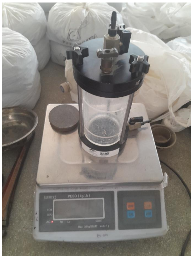
Fotografía 27 Permeámetro de carga constante
