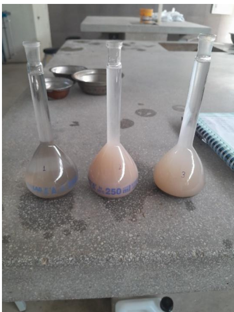
Fig. 19 Fiolas con muestra antes de ser colocadas en la bomba de vacío.
