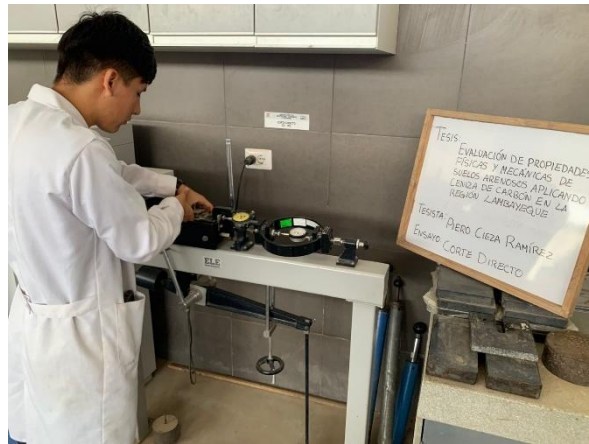
Fig. 21 Colocación de la muestra en la caja de corte
