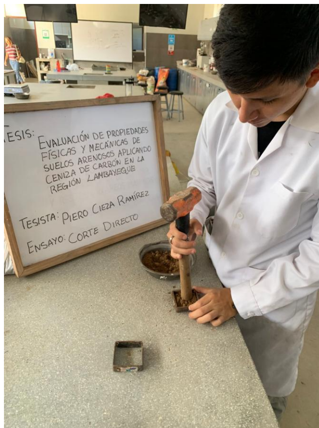
Fotografía 24 Remoldeo de la muestra en los moldes para corte directo
