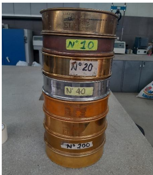
Fig. 13 Tamices utilizados para la granulometría
