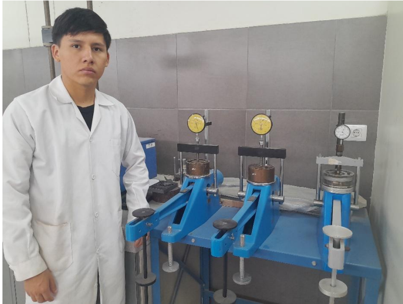
Fotografía 21 Realización del ensayo de consolidación
