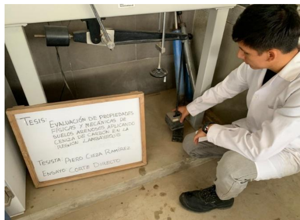
Fig. 22 Carga vertical de 2kg, 3.5kg y 5kg
