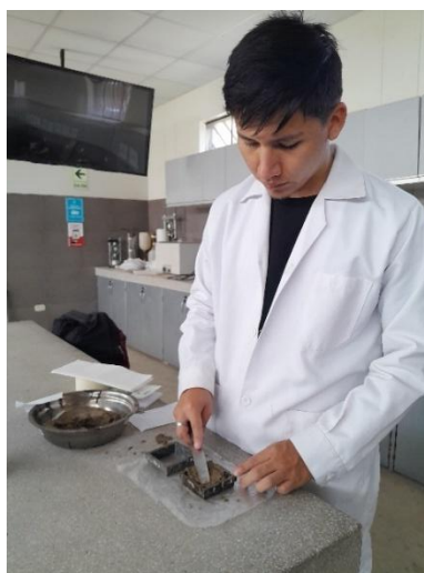
Fig. 20 Remoldeo de la muestra
