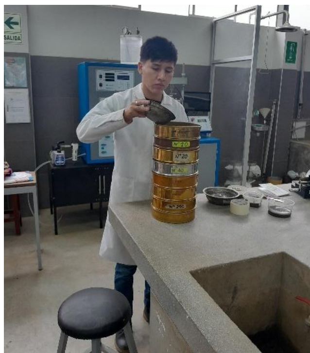
Fig. 14 Tamizado de la muestra de suelo natural
