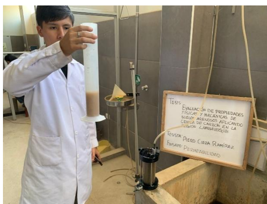
Fig. 28 Medición de volumen que pasa en un determinado tiempo
