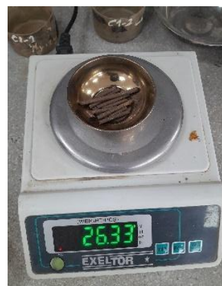
Fig. 16 Cilindros de 3.2mm de diámetro (LP)
