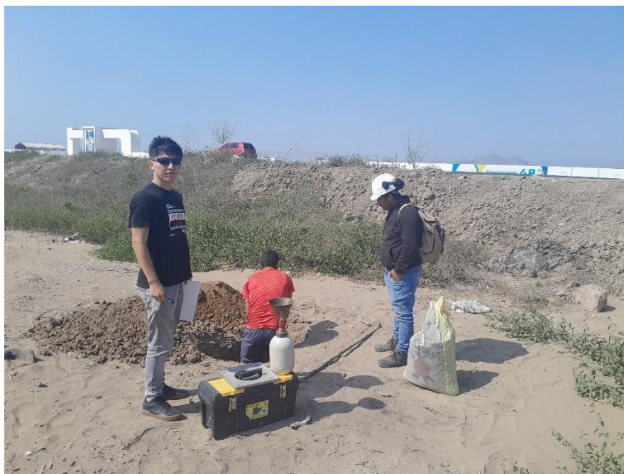
Fig. 7 Extracción de suelo y ensayo de Densidad de campo C-02
