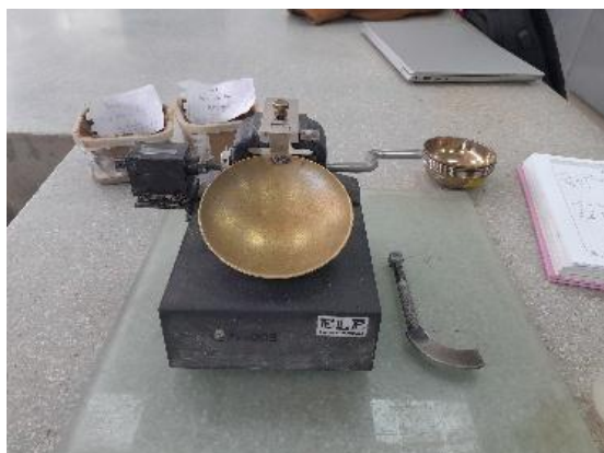
Fig. 15 Copa Casagrande usada para el ensayo de Límite líquido
