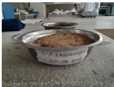
Fig. 12 Muestras de suelo luego de ser sacadas del horno
