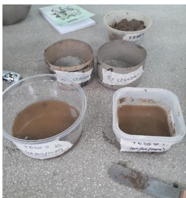
Fig. 17 Suelos con adiciones de ceniza en porcentajes
