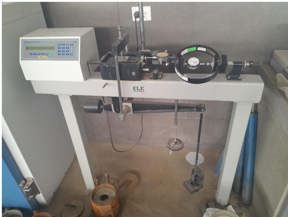
Fotografía 23 Máquina de corte directo
