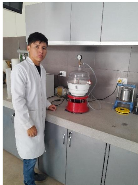
Fig. 18 Extracción del aire de las muestras
