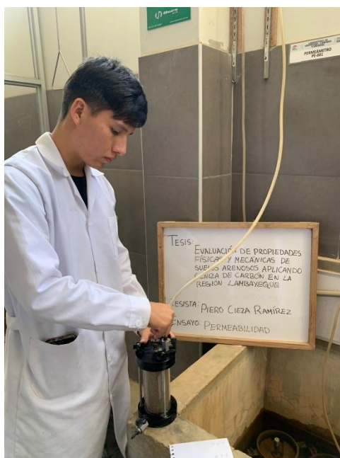
Fig. 27 Realización del ensayo de Permeabilidad
