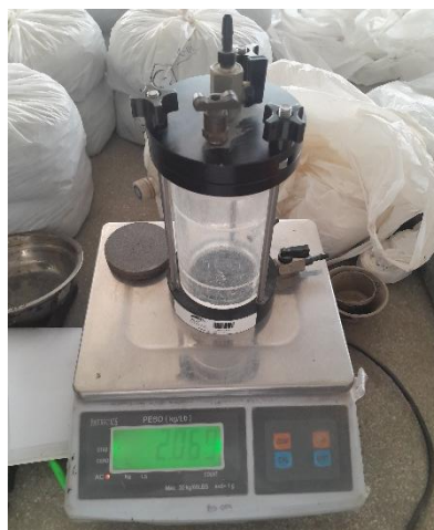
Fig. 26 Peso del permeámetro
