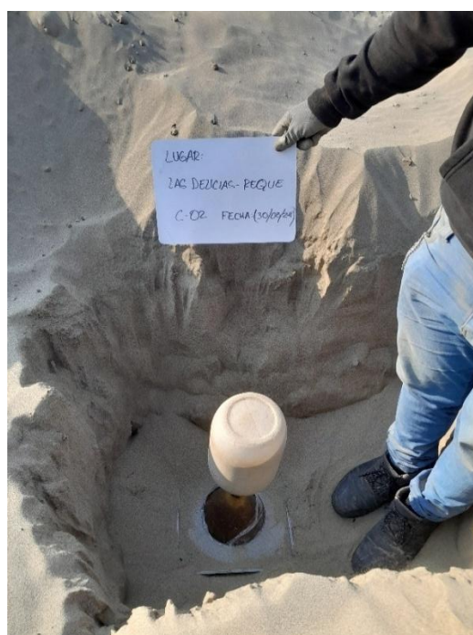
Fig. 9 Extracción de suelo y ensayo de Densidad de campo C-03
