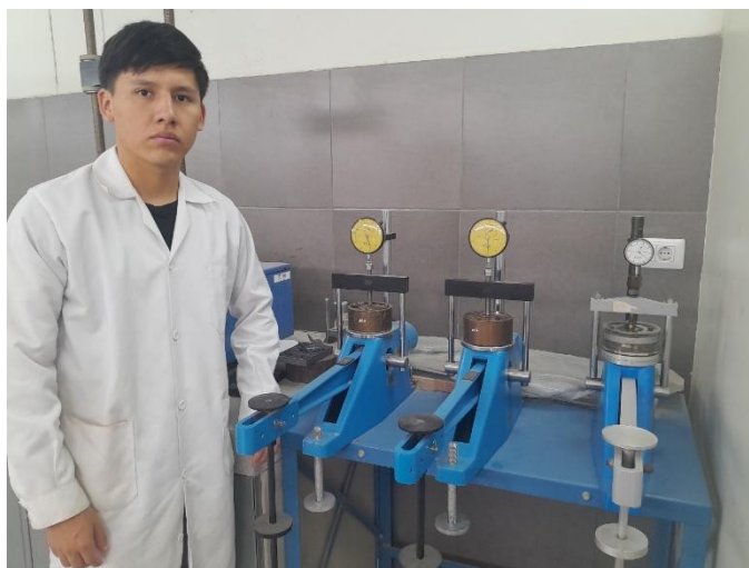
Fig. 24 Consolidómetro con muestras C-01: Natural, 5% y 15%
