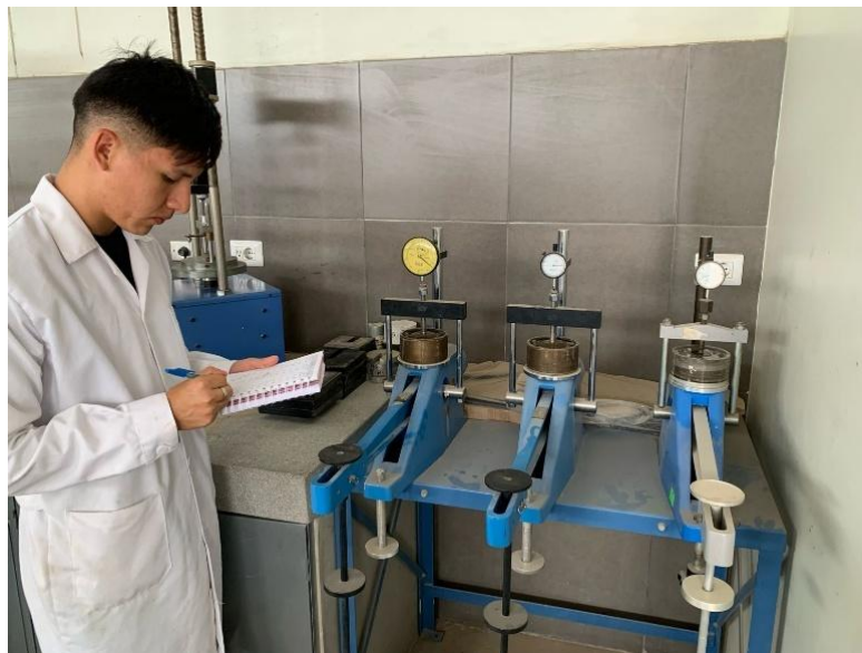
Fig. 25 Toma de lecturas de los deformímetros
