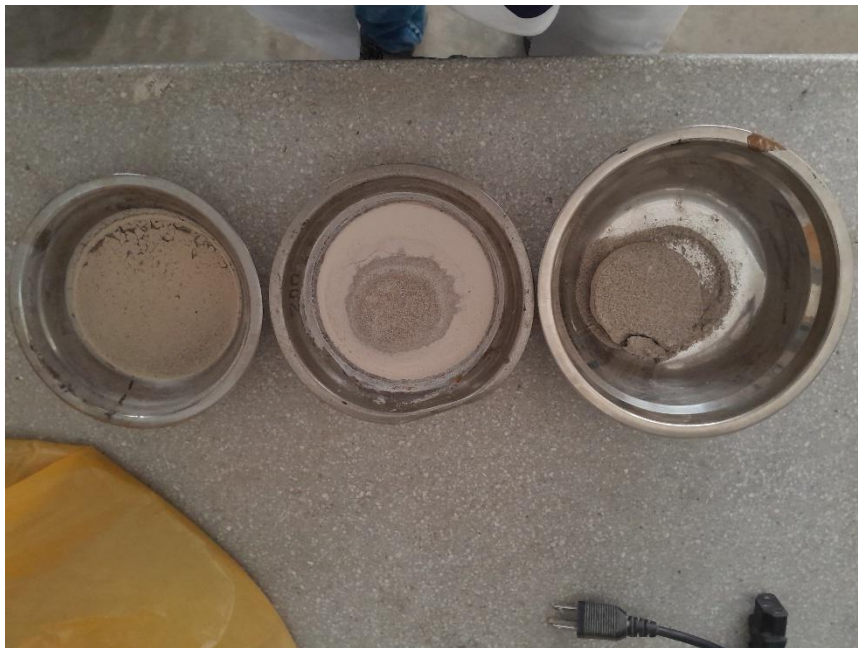
Fotografía 22 Muestras secas luego del ensayo de consolidación para la determinación de su humedad
