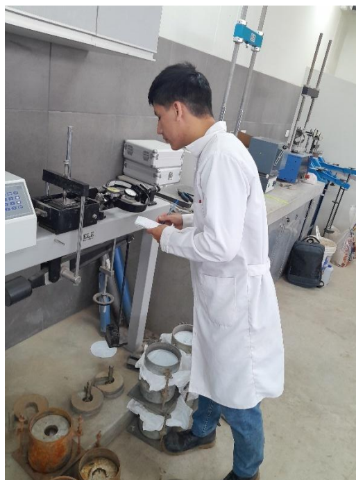
Fig. 23 Toma de lecturas del dial de deformaciones
