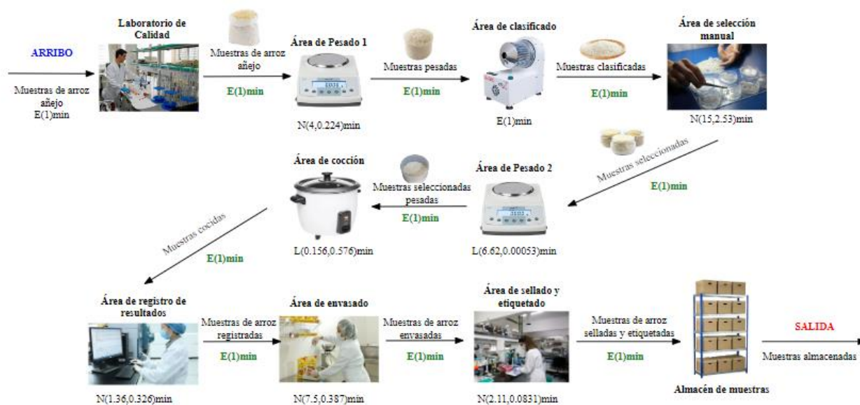
Figura 2: Diseño de la mejora del proceso de análisis de muestras de arroz añejo
