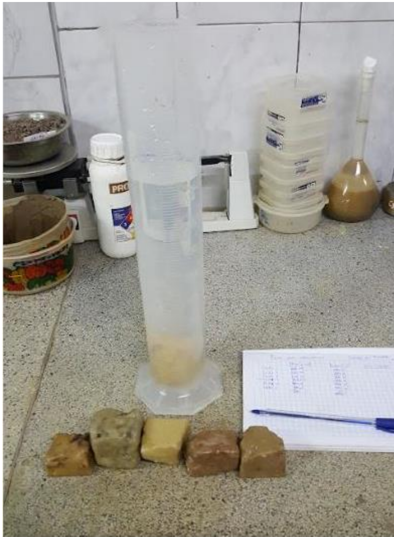
Fotografía 18: Medición del volumen del suelo
