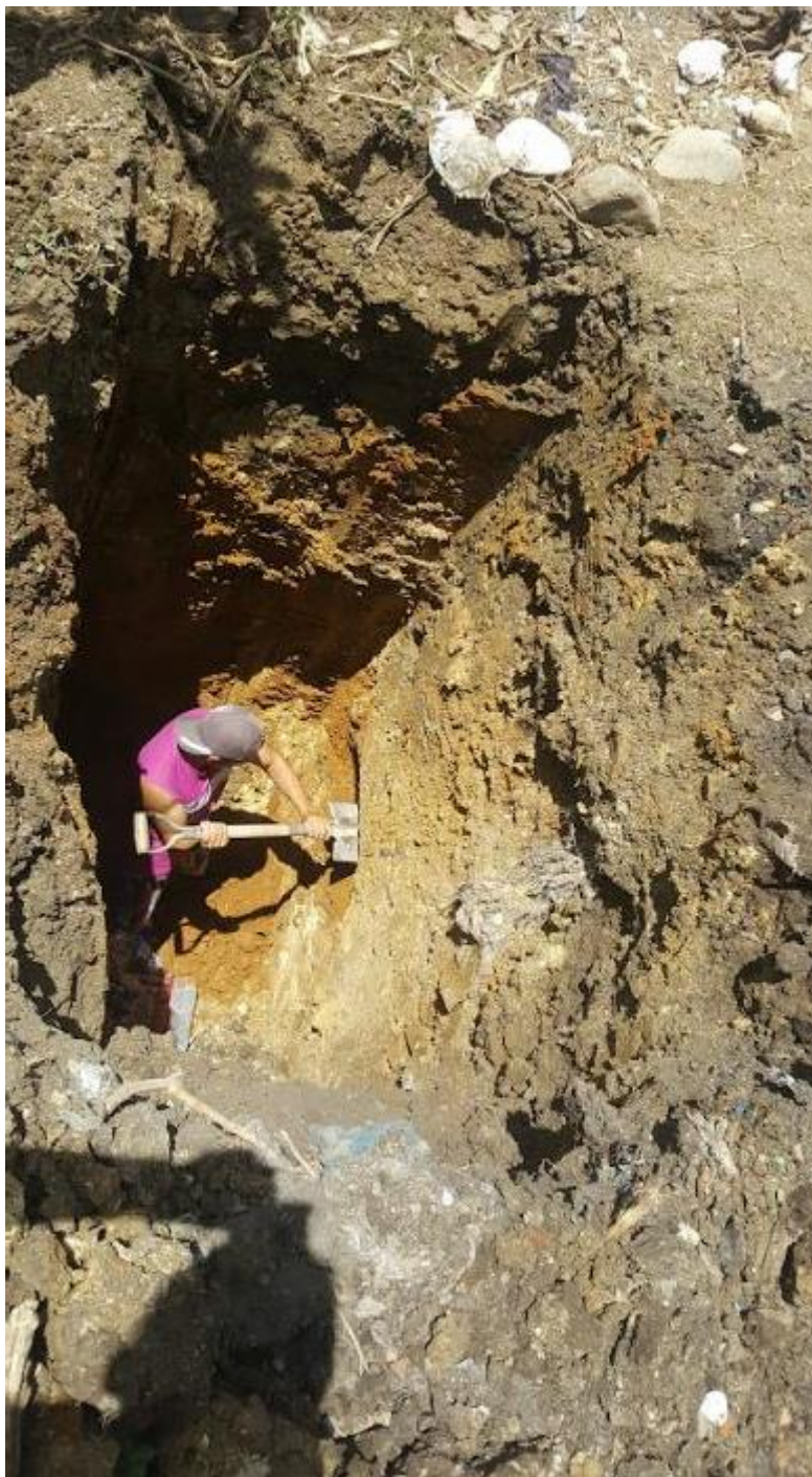
Fotografía 04: Obtención de muestra inalteradas de calicata N°02
