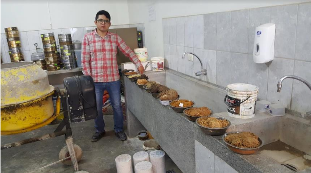
Fotografía 10: Muestras húmedas de suelo en laboratorio
