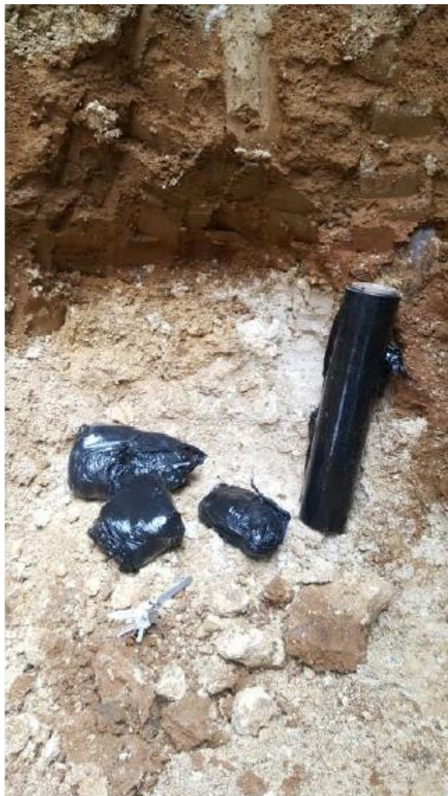
Fotografía 03: Obtención de muestras inalteradas de calicata N°01
