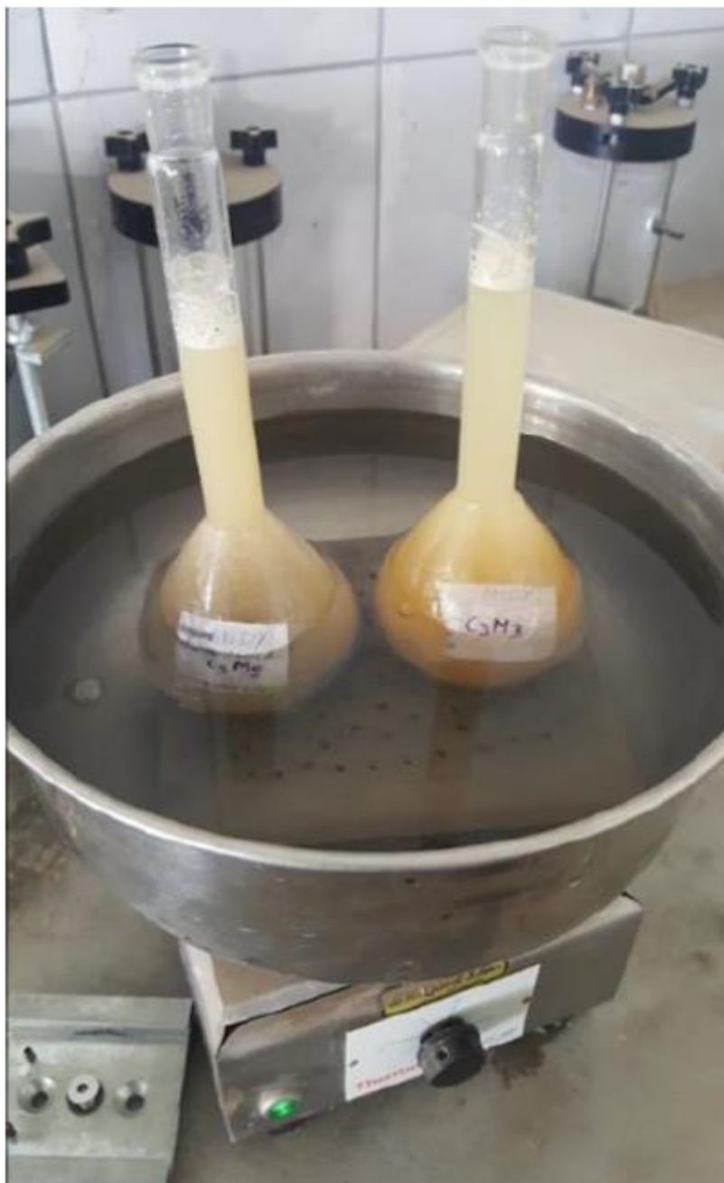
Fotografía 14: Ensayo de gravedad específica
