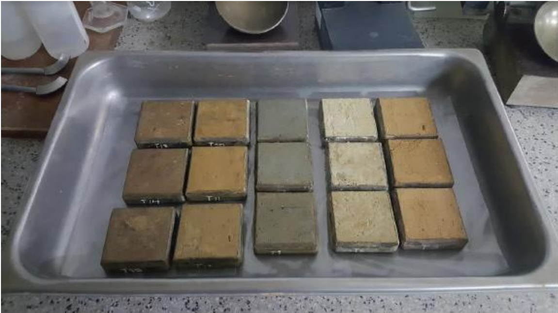
Fotografía 15: Material puestos en talladores previo a inserción en caja de corte
