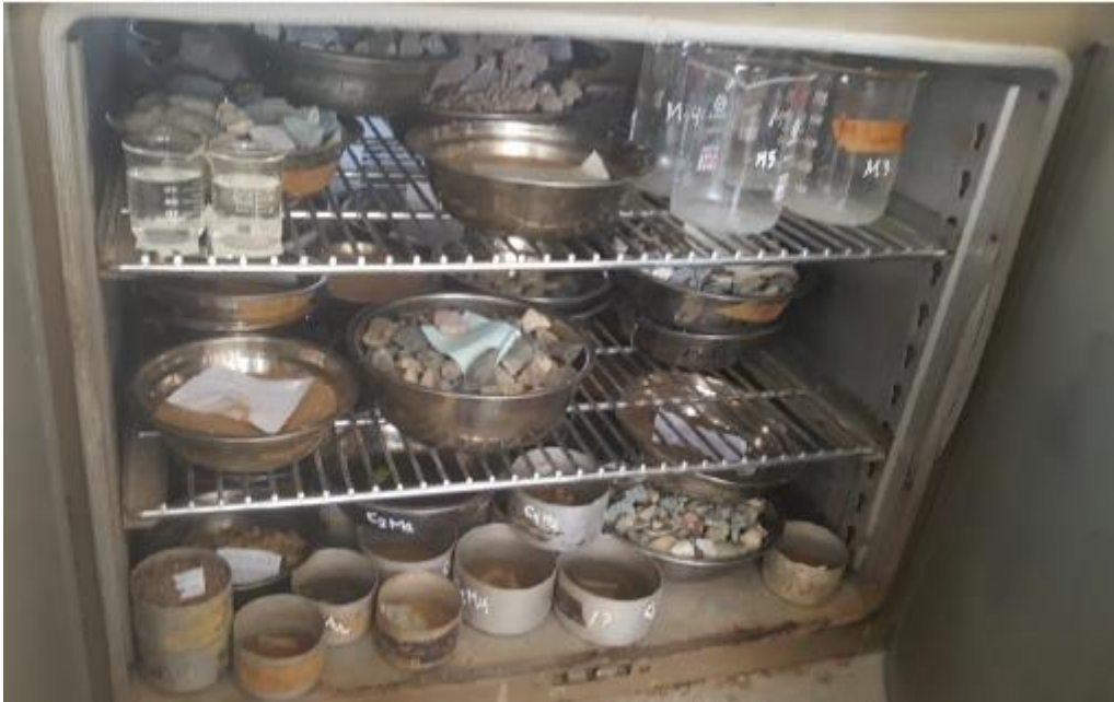
Fotografía 12: Muestras en el horno secados por 24 horas
