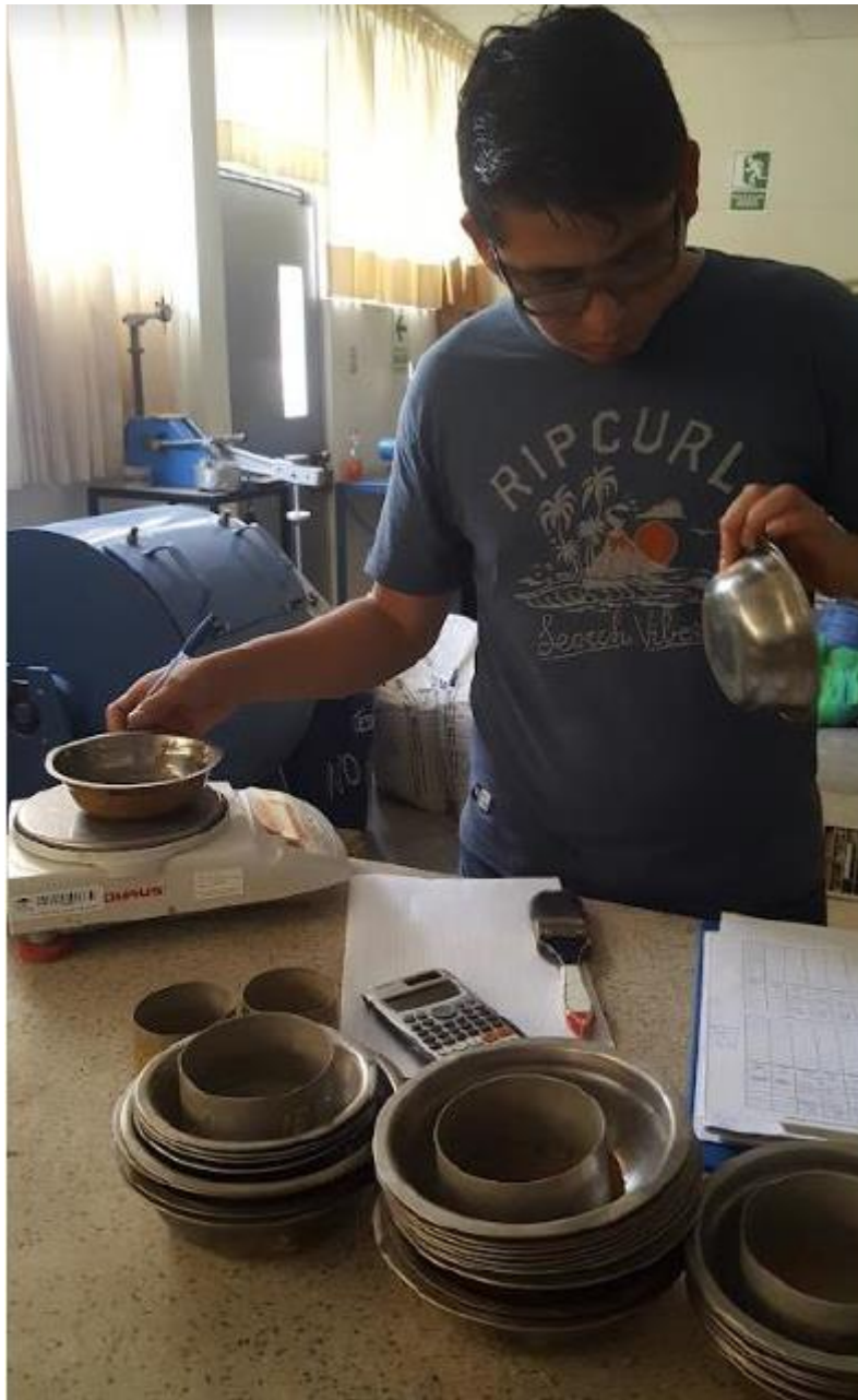
Fotografía 14: Proceso de pesado de suelos
