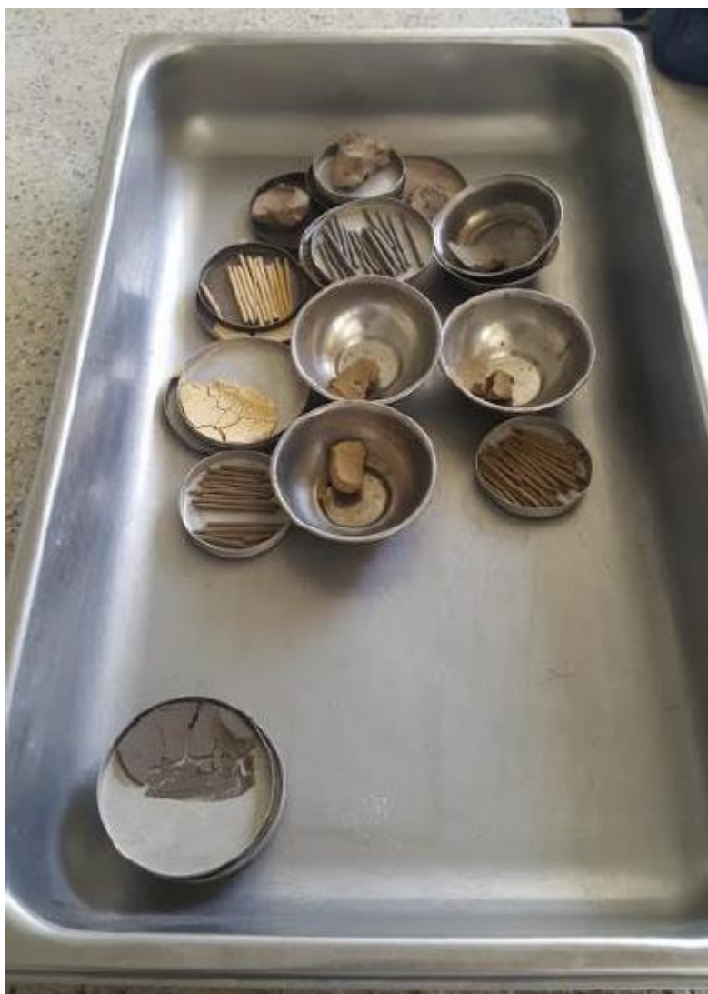
Fotografía 20: Muestras secadas al horno
