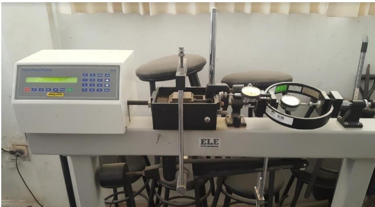
Fotografía 16: Maquina para elaboración de corte directo
