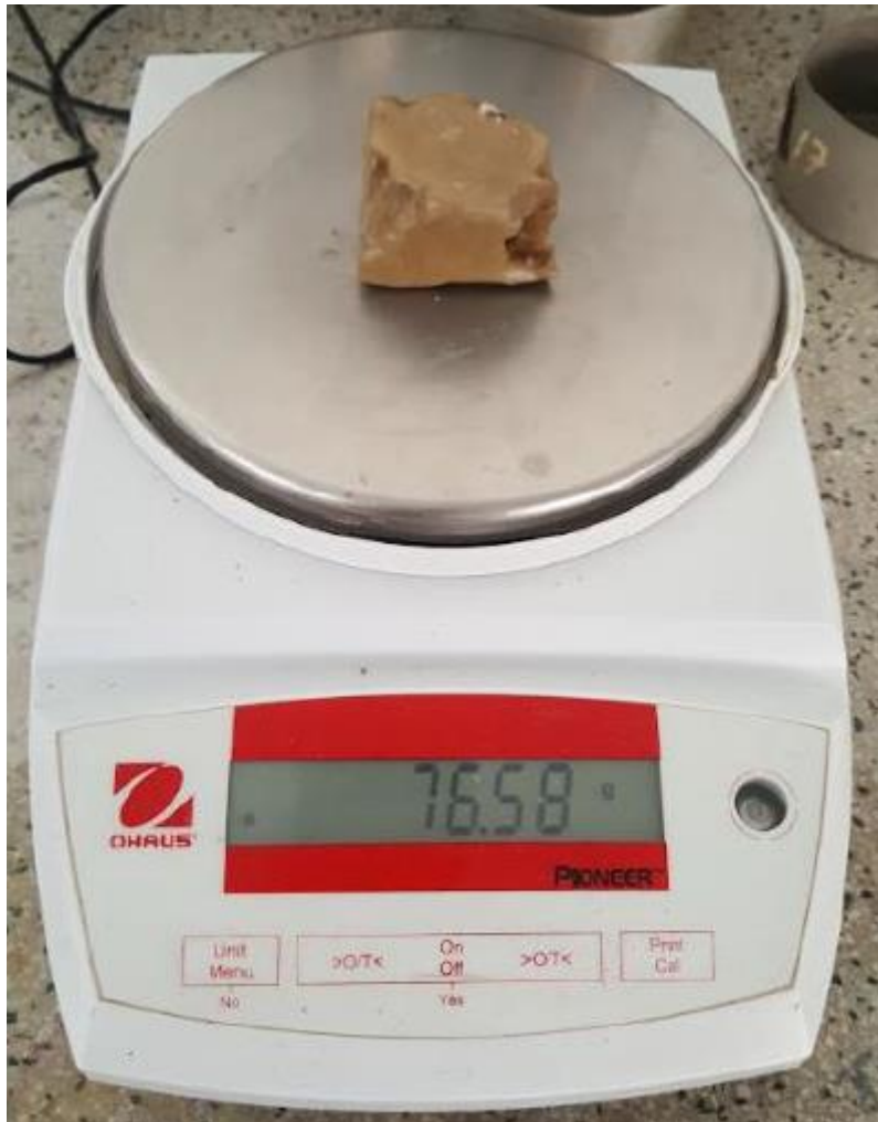
Fotografía 17: Suelo recubierto con parafina
