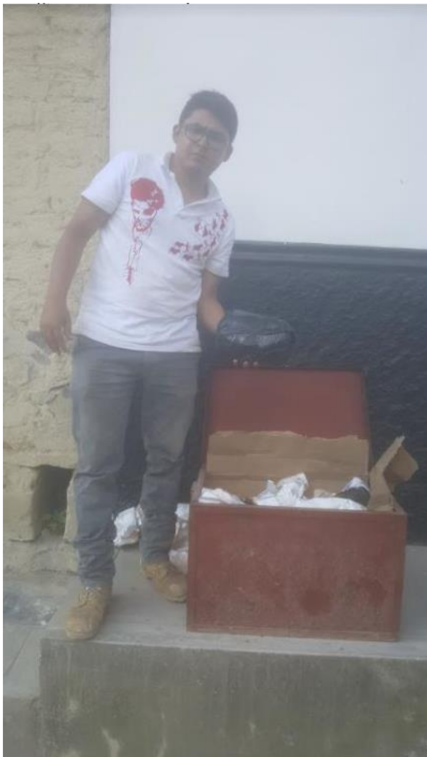
Fotografía 08: Protección para traslado de muestras inalteradas
