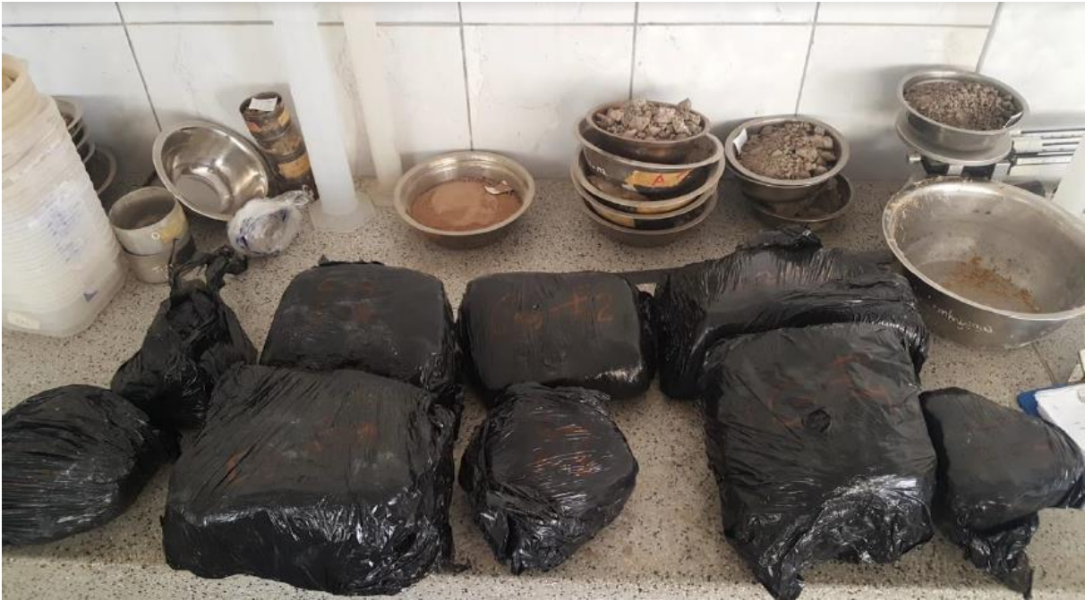
Fotografía 09: Muestras inalteradas protegidas para conservar humedad
