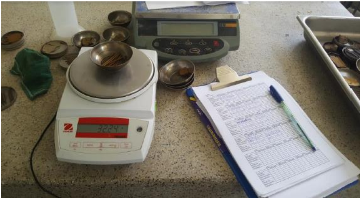
Fotografía 21: Proceso de pesado ensayo de Limites de Atterberg
