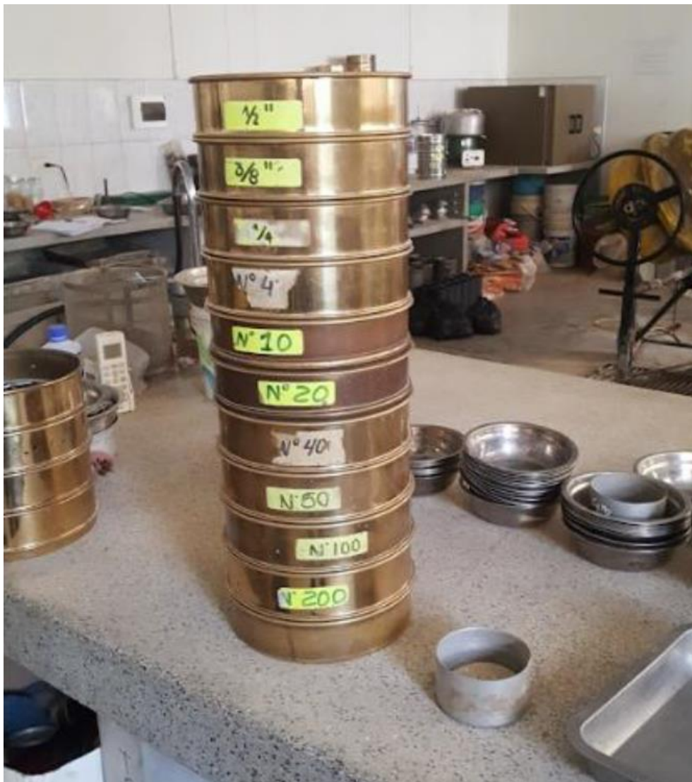
Fotografía 13: Tamices para ensayo de granulometría
