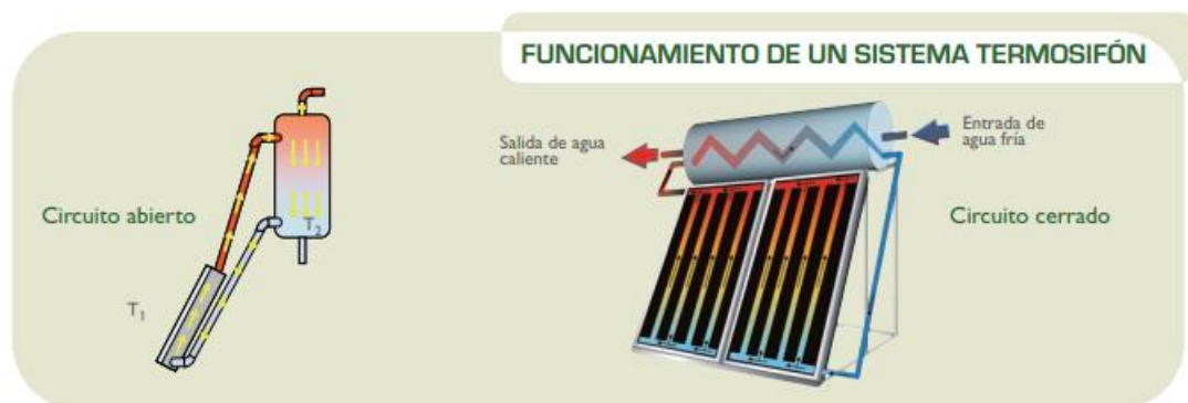
Figura 2. Esquema de una aplicación solar térmica: Sistema termosifón [19].
