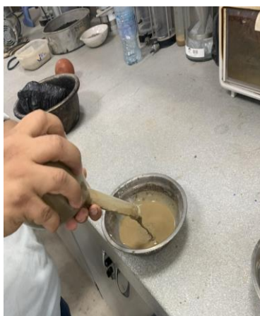
Ilustración 12. Gravedad específica y absorción de agregado fino
