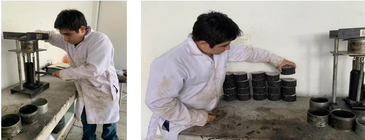
Ilustración 17. Extracción de especímenes.
