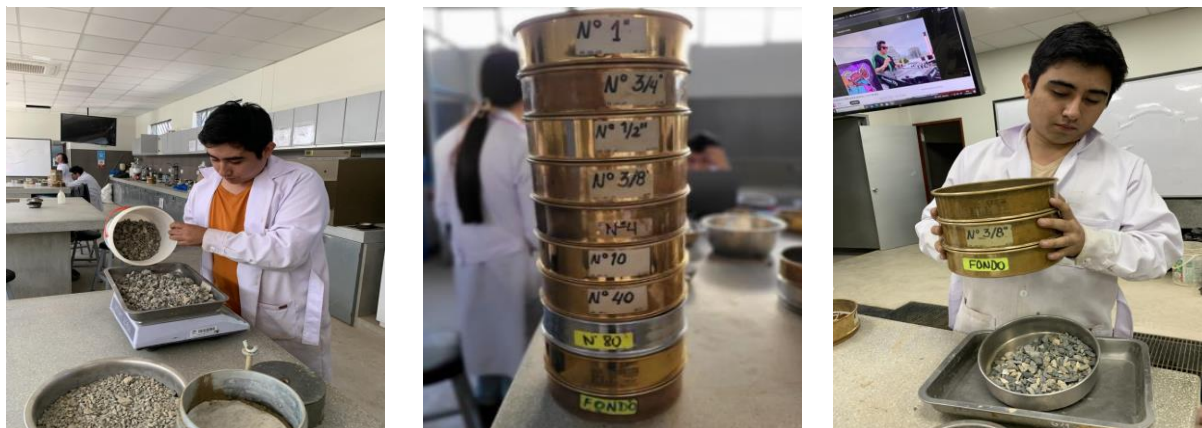
Ilustración 4 Análisis Granulométrico de agregados
