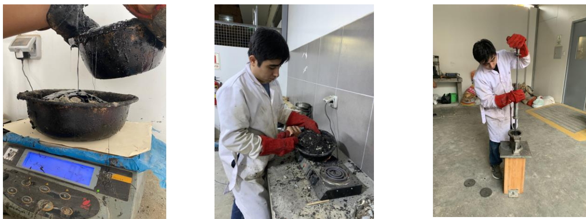
Ilustración 16. Mezcla de agregados y compactación de especímenes.
