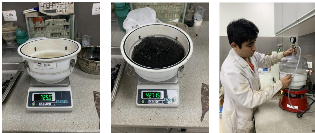
Ilustración 20. Ensayo de Gravedad Específica.
