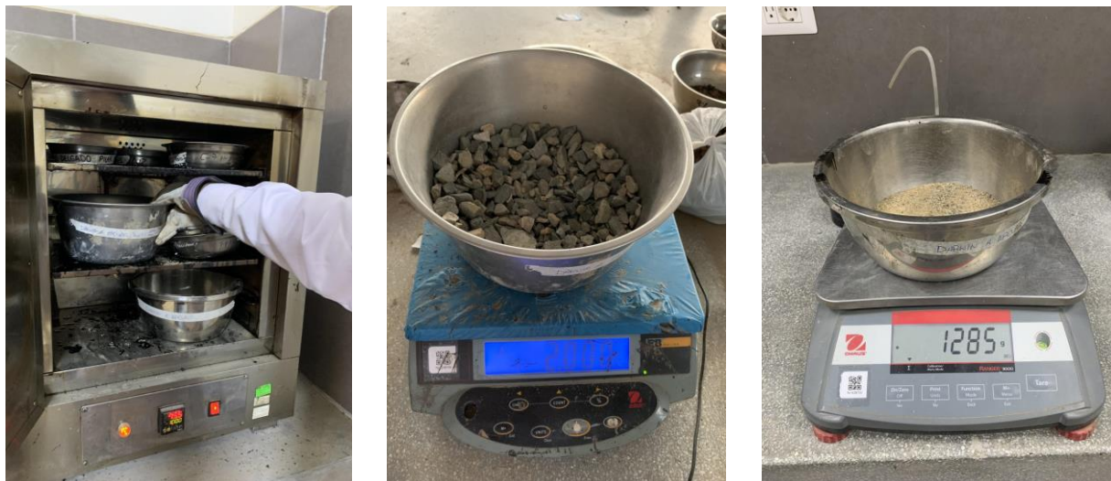
Ilustración 3 Contenido de humedad total de los agregados por secado
