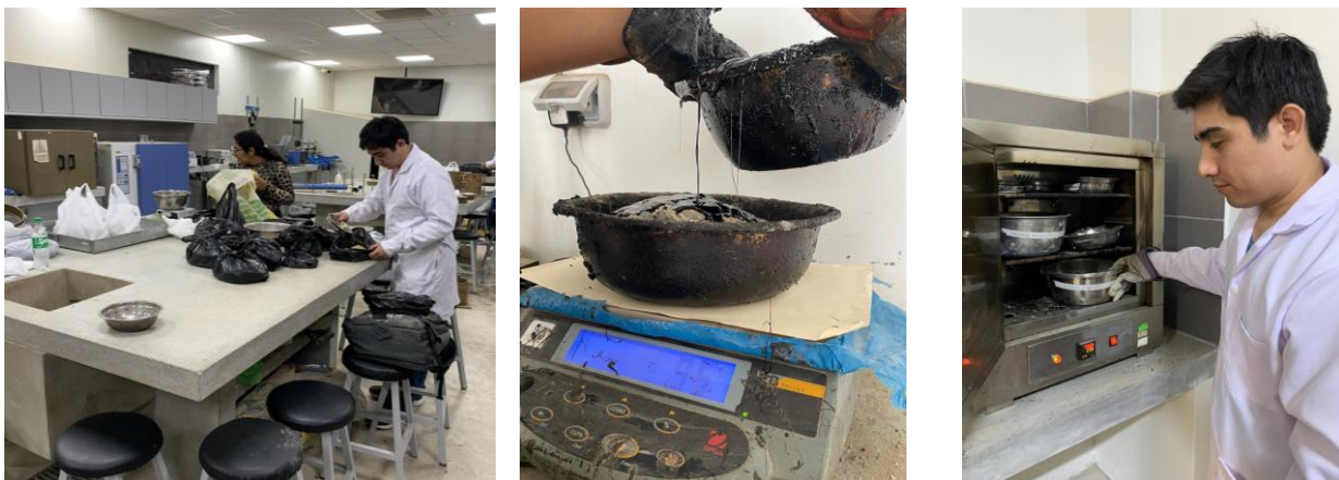
Ilustración 15. Pesaje y añadido de agregados y cemento asfáltico.
