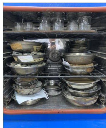
Ilustración 12. Gravedad específica y absorción de agregado fino
