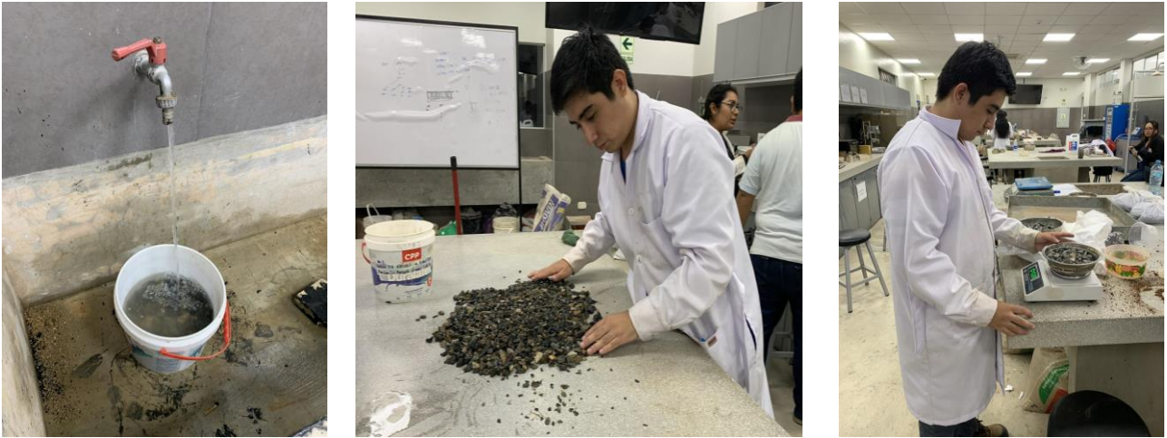
Ilustración 7 Peso y absorción de agregados gruesos
