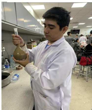
Ilustración 12. Gravedad específica y absorción de agregado fino
