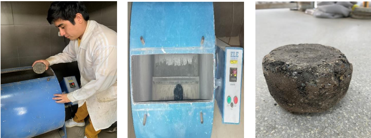
Ilustración 21. Ensayo de Cántabro
