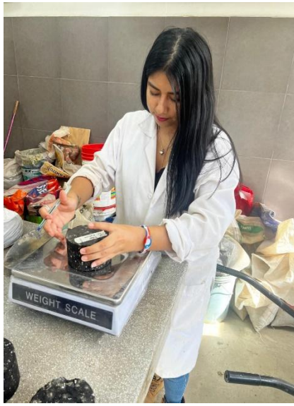
Anexo 135. Panel fotográfico del ensayo de Cantabro.
