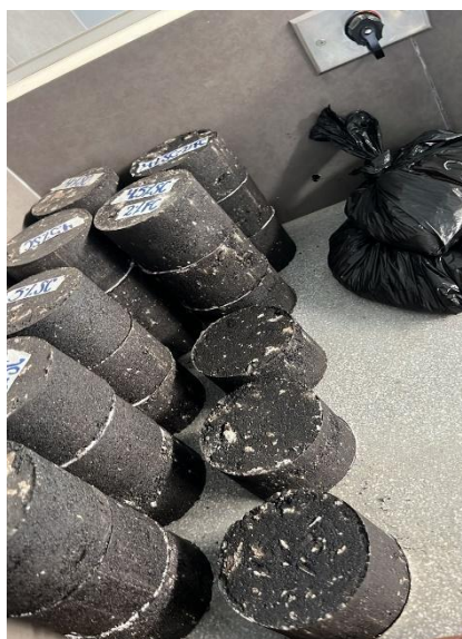
Anexo 126. Panel fotográfico de las Briquetas convencionales.
