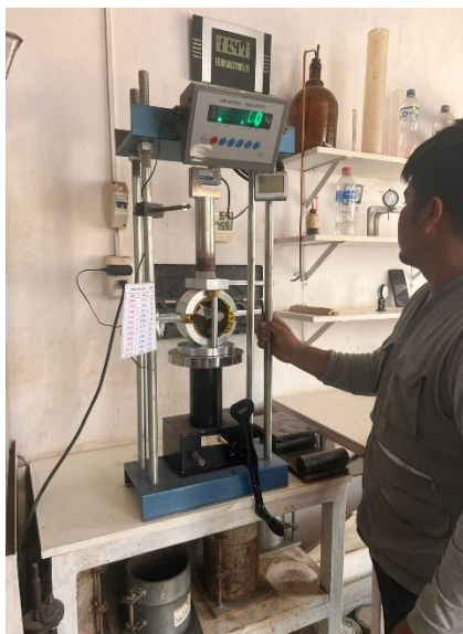
Anexo 128. Panel fotográfico del ensayo Marshall.
