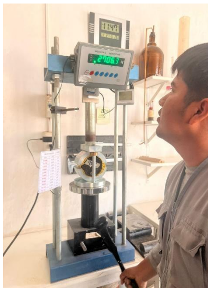
Anexo 128. Panel fotográfico del ensayo Marshall.
