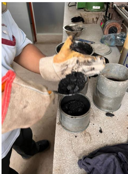
Anexo 124. Panel fotográfico de la Compactación de briquetas.
