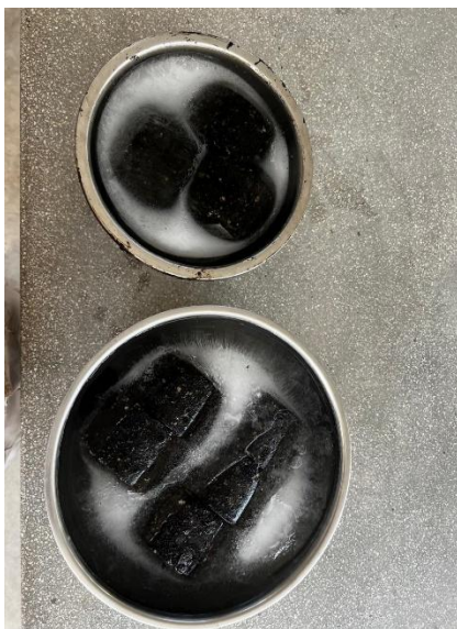
Anexo 134. Panel fotográfico del ensayo de Lottman modificado.
