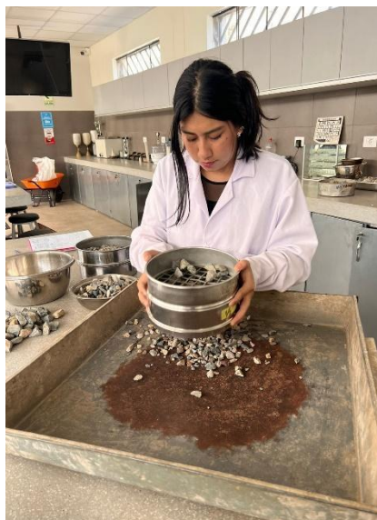
Anexo 112. Panel fotográfico del ensayo de granulometría.
