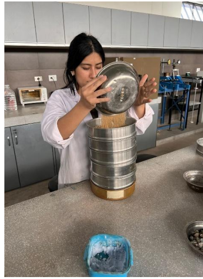
Anexo 117. Panel fotográfico del ensayo de granulometría.
