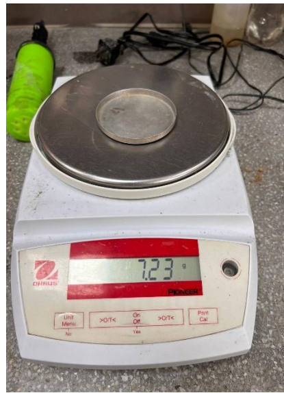
Anexo 122. Panel fotográfico del ensayo de Límites de Atterberg.
