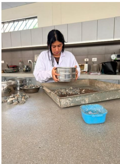
Anexo 112. Panel fotográfico del ensayo de granulometría.
