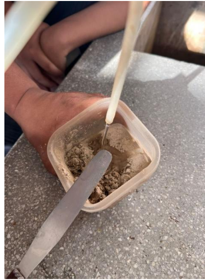
Anexo 132. Panel fotográfico del ensayo de límites para el filler vidrio primario pulverizado.
