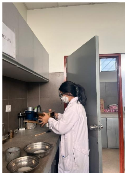
Anexo 131. Panel fotográfico del tamizado por la malla N° 200 para obtener el filler.
