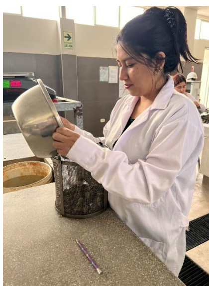
Anexo 113. Panel fotográfico del ensayo de peso específico.
