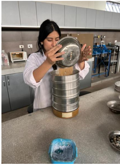
Anexo 117. Panel fotográfico del ensayo de granulometría.
