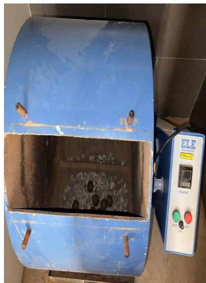
Anexo 114. Panel fotográfico del ensayo de abrasión.
