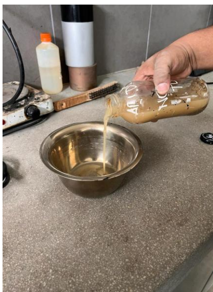
Anexo 119. Panel fotográfico del ensayo de Sales Solubles.
