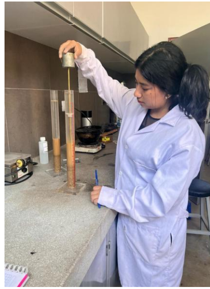
Anexo 121. Panel fotográfico del ensayo de Equivalente de arena.
