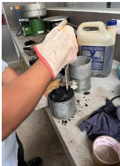
Anexo 124. Panel fotográfico de la Compactación de briquetas.
