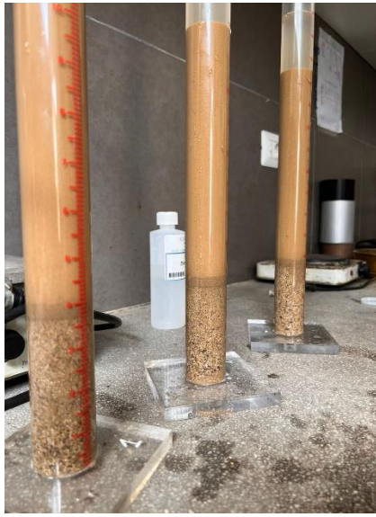
Anexo 121. Panel fotográfico del ensayo de Equivalente de arena.
