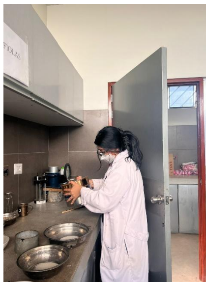
Anexo 131. Panel fotográfico del tamizado por la malla N° 200 para obtener el filler.
