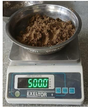
Figura 33. Análisis granulométrico por tamizado de la Calicata II
