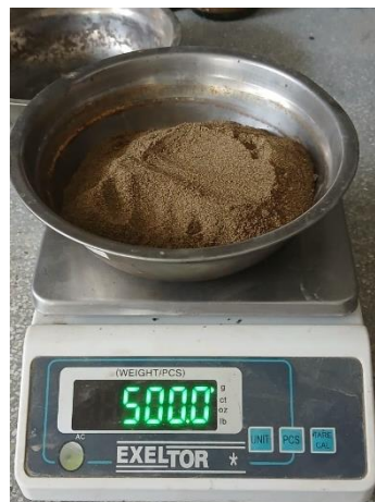
Figura 32. Análisis granulométrico por tamizado de la Calicata I
