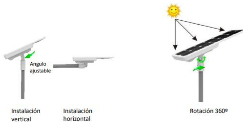
Figura 3. Ángulo de montaje del panel
