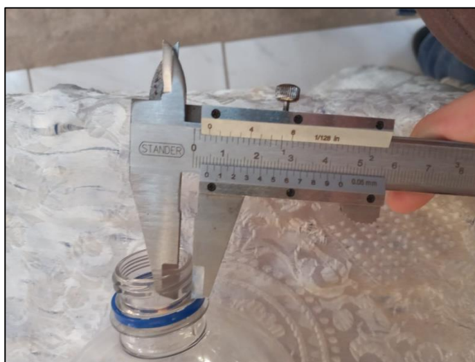
Figura 30 Medición del espesor del pico de la botella de PET utilizando un vernier
