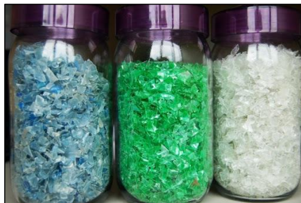
Figura 112 Tipos de Flakes de PET
