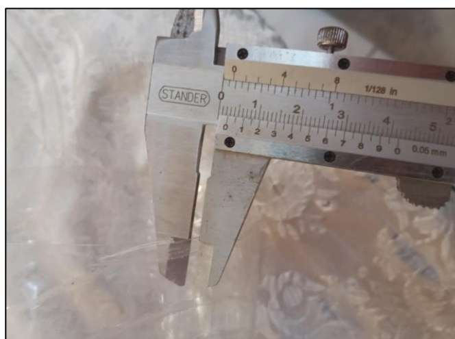
Figura 29 Medición del espesor de la botella de PET utilizando un vernier
