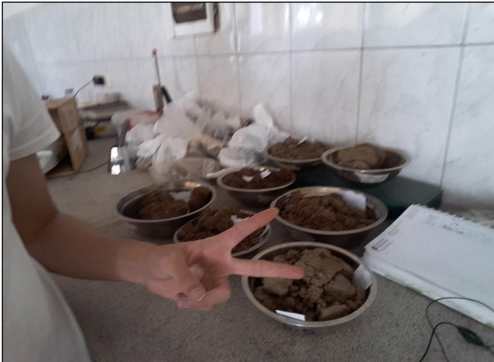
Imagen N° 9 – Muestras recolectadas de calicatas C1, C2 y C3 en el terreno de estudio
