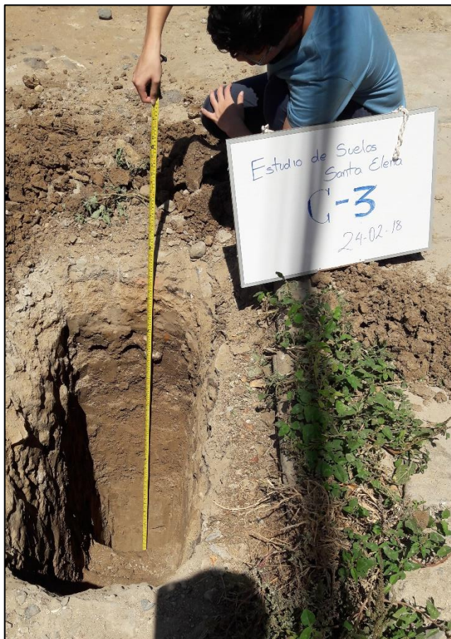
Imagen N° 7 – Medición de calicata N° 3 en terreno de estudio realizada el 23/02/18
