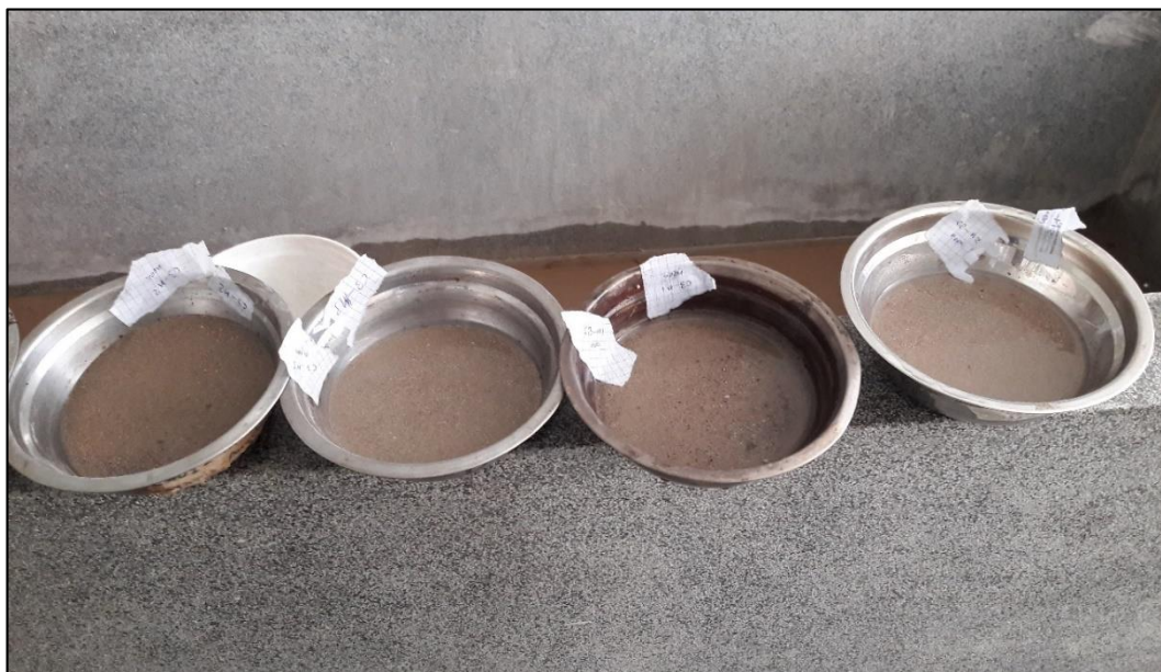
Imagen N° 16 – Muestras saturadas de calicata C1 y C2 para ensayo de análisis granulométrico
