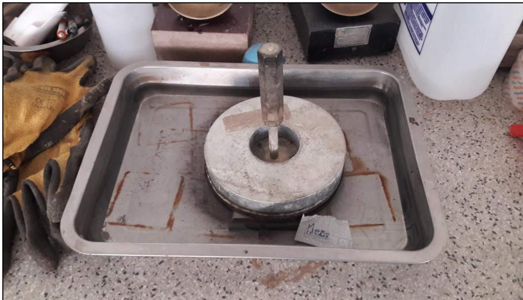
Imagen N° 27 – Muestra C1M1, C1M2 y C2M1 bajo pisón después de ensayo de Corte Directo
