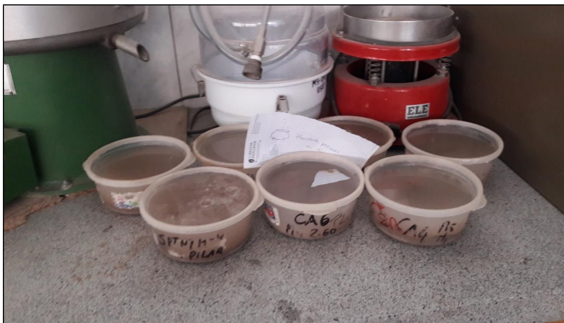
Imagen N° 13 – Muestras saturadas para ensayos de Porcentaje de Absorción y análisis granulométrico
