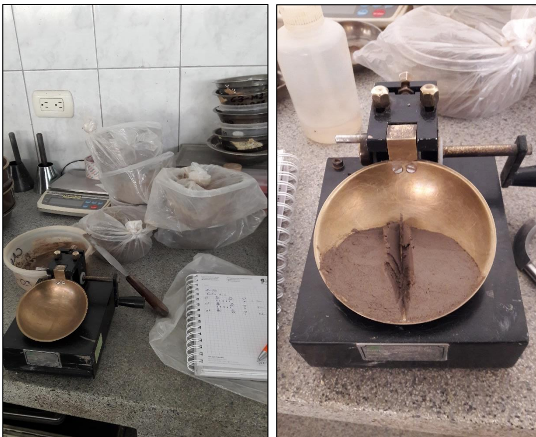
Imagen N° 23 – Colocación de muestras en cuchara de Casa Grande para ensayo de Límite Líquido
