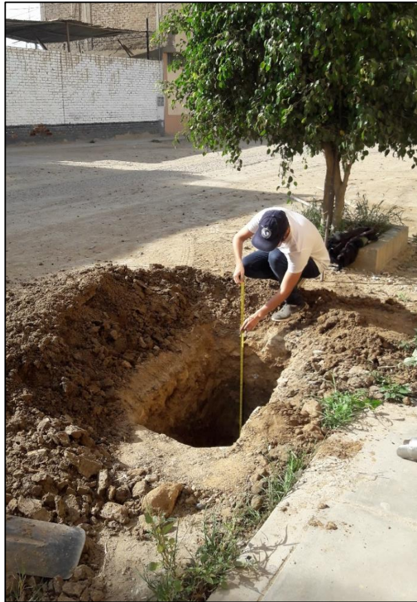
Imagen N° 3 – Medición de calicata N° 1 en terreno de estudio realizada el 22/02/18
