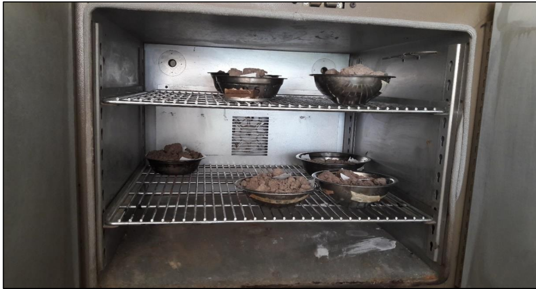
Imagen N° 10 – Muestras puestas a secar en horno para ensayo de Contenido de Humedad
