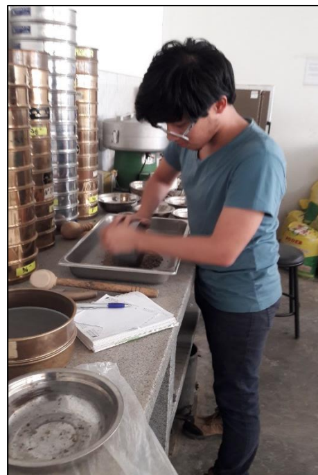
Imagen N° 19 – Molido de muestras que pasaron el tamiz #40 para ensayos de finos
