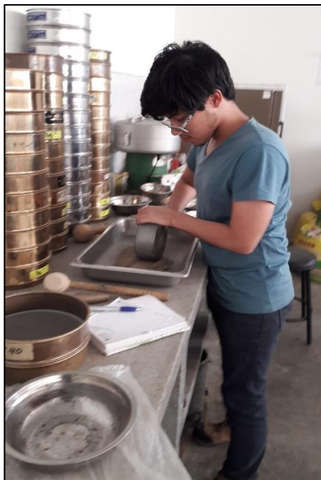
Imagen N° 19 – Molido de muestras que pasaron el tamiz #40 para ensayos de finos
