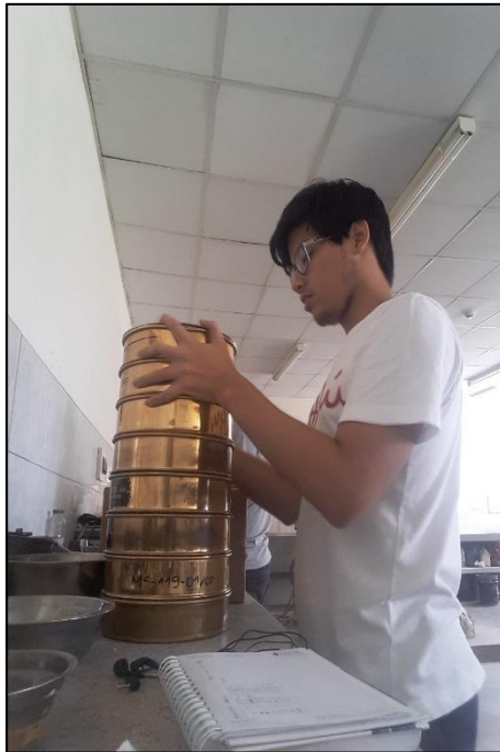
Imagen N° 18 – Tamizado de muestras para análisis granulométrico de gruesos
