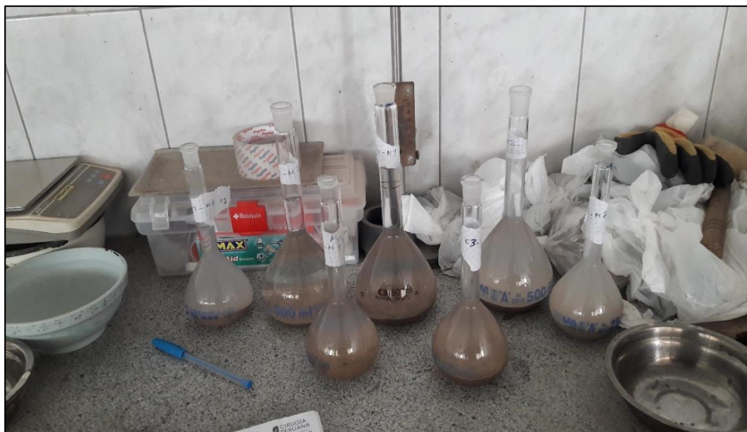
Imagen N° 22 – Muestras por estrato colocadas en fiolas para ensayo de Gravedad Específica
