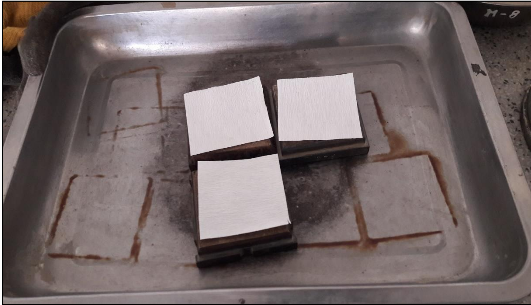
Imagen N° 26 – Muestra C1M1, C1M2 y C2M1 compactadas después de ensayo de Corte Directo
