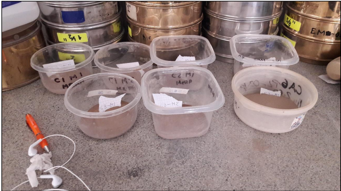
Imagen N° 20 – Muestras preparadas para ensayos de Gravedad Específica y Límites de Atterberg
