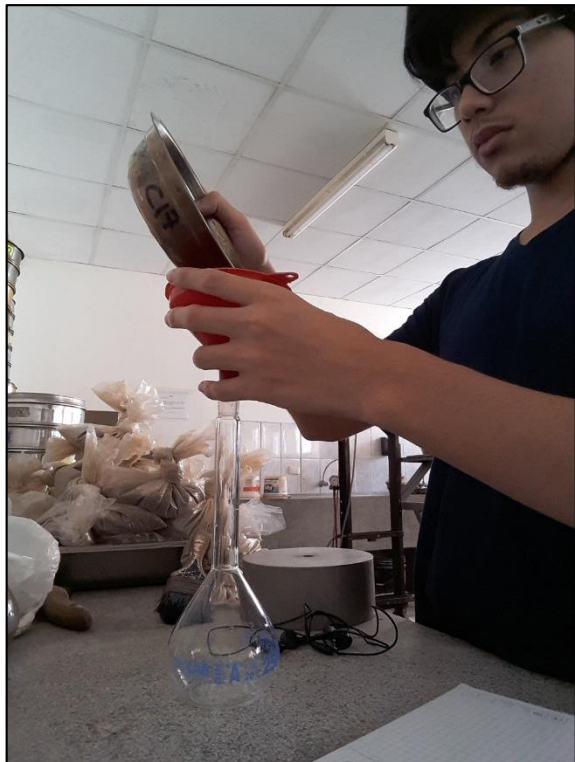
Imagen N° 21 – Vertido de muestras en fiolas para ensayo de Gravedad Específica
