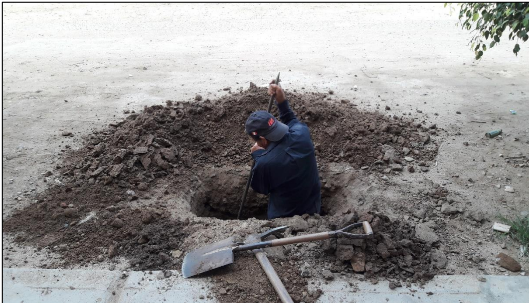
Imagen N° 4 – Medición de calicata N° 2 en terreno de estudio realizada el 23/02/18
