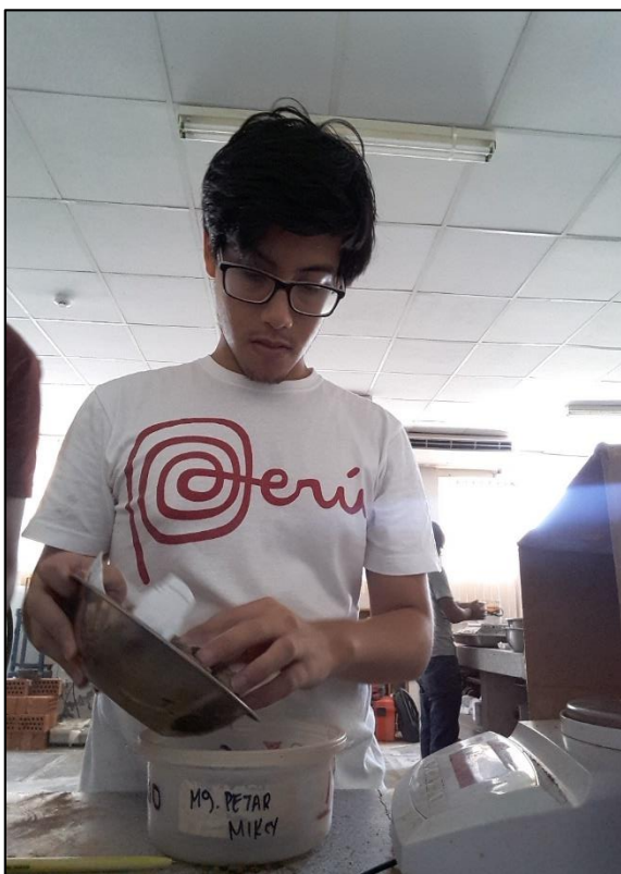
Imagen N° 12 – Separación y saturación de muestra para ensayo de análisis granulométrico
