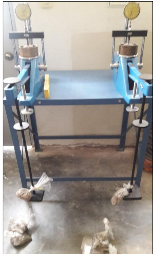
Imagen N° 30 – Muestras sometidas a ensayo de Consolidación
