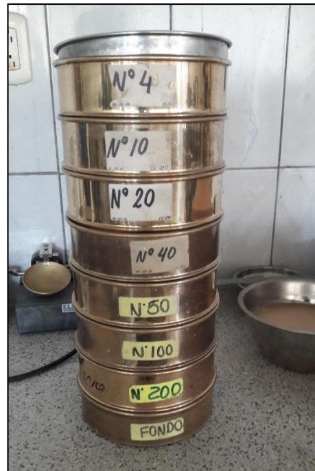
Imagen N° 18 – Tamizado de muestras para análisis granulométrico de gruesos
