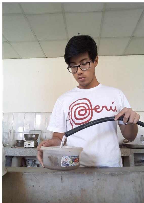
Imagen N° 12 – Separación y saturación de muestra para ensayo de análisis granulométrico
