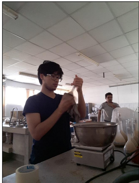
Imagen N° 21 – Vertido de muestras en fiolas para ensayo de Gravedad Específica
