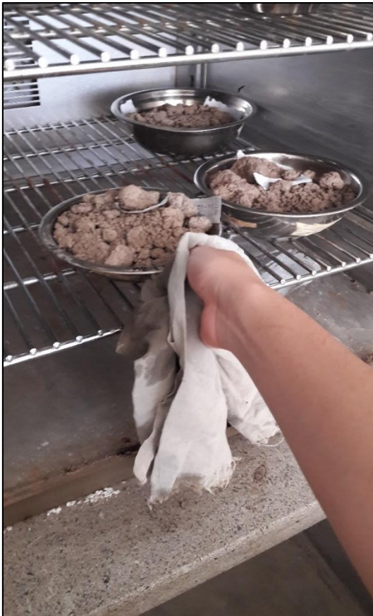
Imagen N° 11 – Muestras secas retiradas del horno al día siguiente para ensayos
