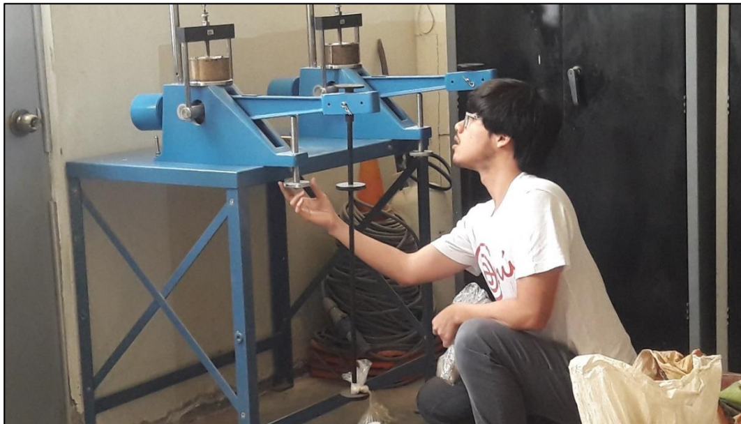
Imagen N° 29 – Calibración y colocación de pesos para ensayo de Consolidación
