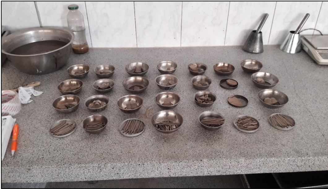
Imagen N° 24 – Muestras para Límite Líquido y Plástico en ensayo de Límites de Atterberg
