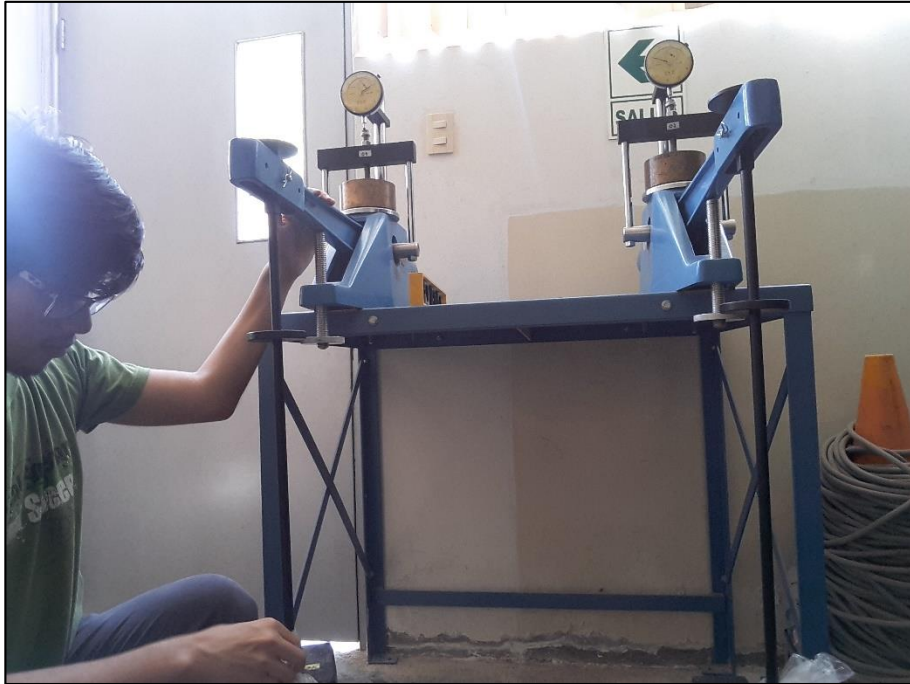
Imagen N° 28 – Calibración y colocación de pesos para ensayo de Consolidación
