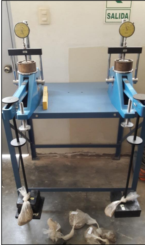
Imagen N° 30 – Muestras sometidas a ensayo de Consolidación
