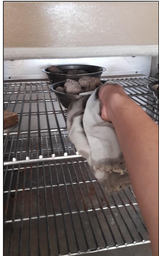
Imagen N° 11 – Muestras secas retiradas del horno al día siguiente para ensayos
