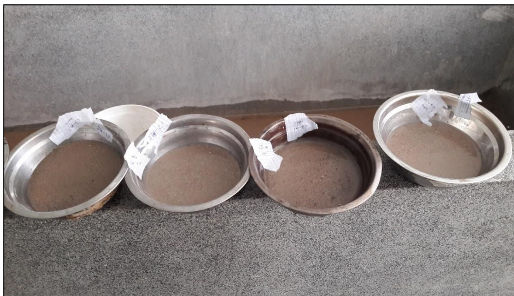
Imagen N° 17 – Muestras saturadas de calicata C1 y C2 para ensayo de análisis granulométrico
