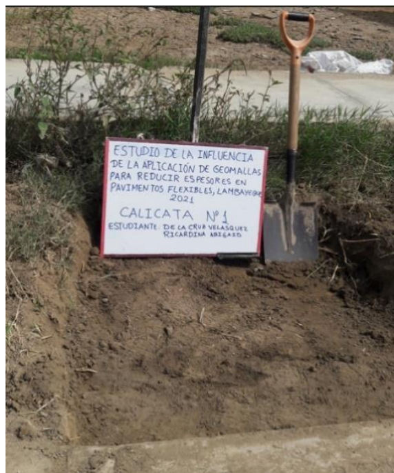
Foto 4. Calicata de donde se extrajo la muestra para subrasante Fuente: Propia
