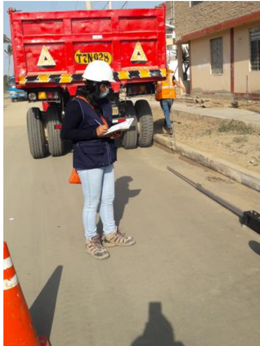
Foto 100. Toma de valores de la lectura del dial dictadas por el Técnico Fuente: Propia
