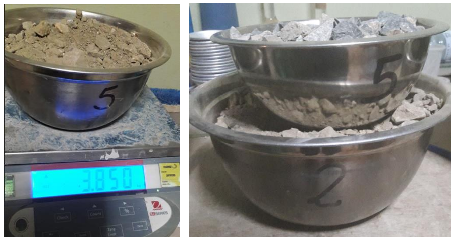
Foto 17. Peso del material más el 30% de piedra de 1/2 Fuente: Propia
