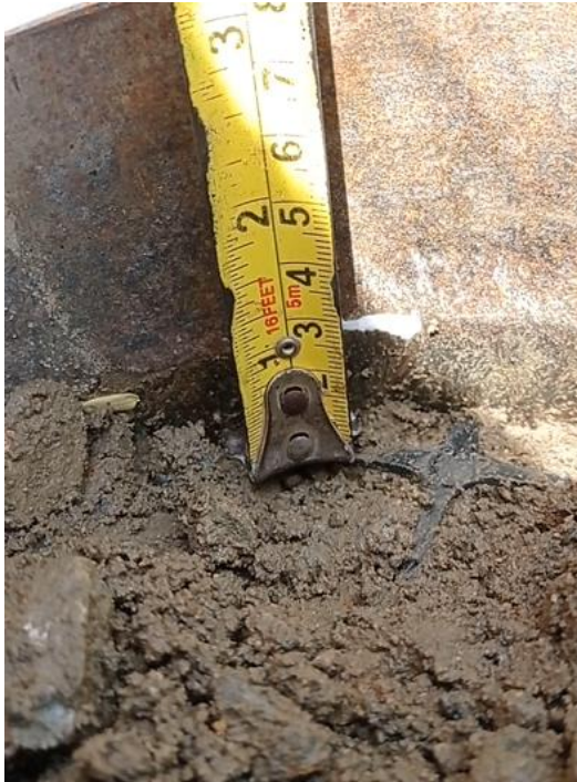
Foto 22. Geomalla ubicada a 3cm de la superficie Fuente: Propia
