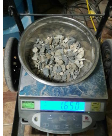
Foto 21. Peso del material con el 30% de piedra de media Fuente: Propia
