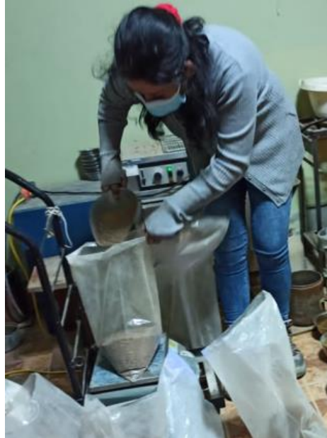
Foto 21. Peso del material con el 30% de piedra de media Fuente: Propia
