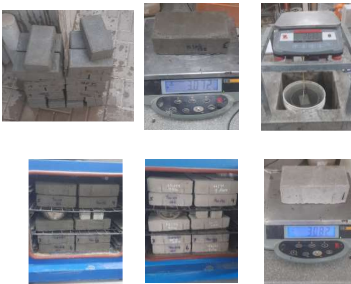
Fig. 27. Resistencia a la absorción. Fuente Propia
