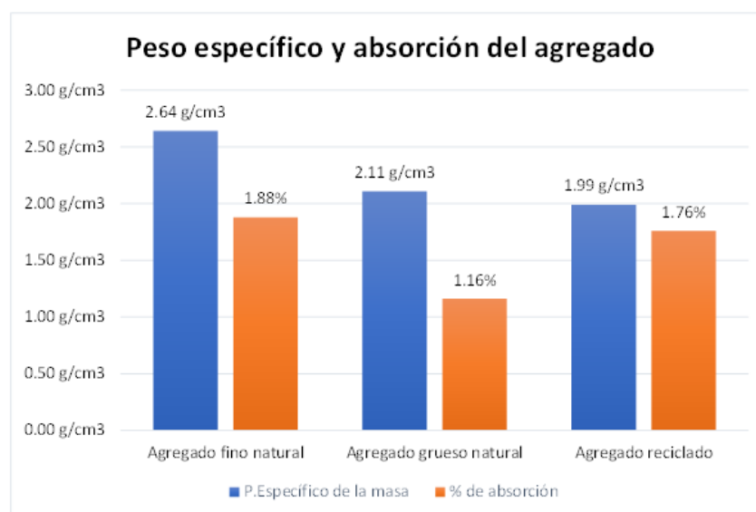
Fig. 60. Peso específico y absorción del agregado. Fuente Propia
