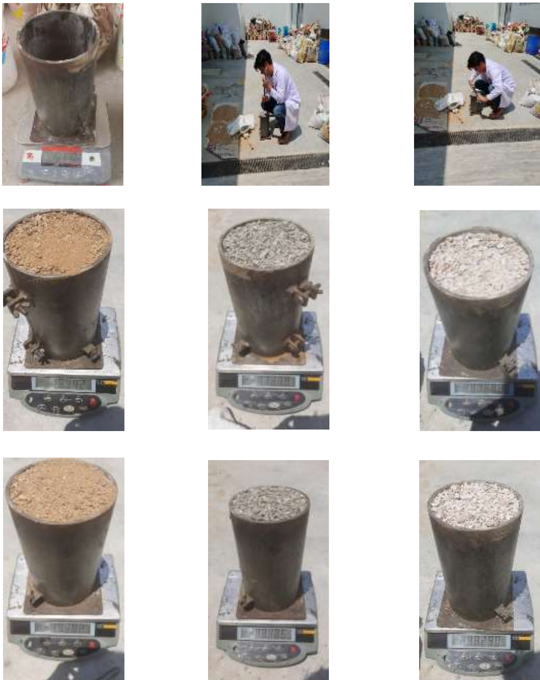
Fig. 14. Ensayo de PUS y PUC de los agregados. Fuente Propia
