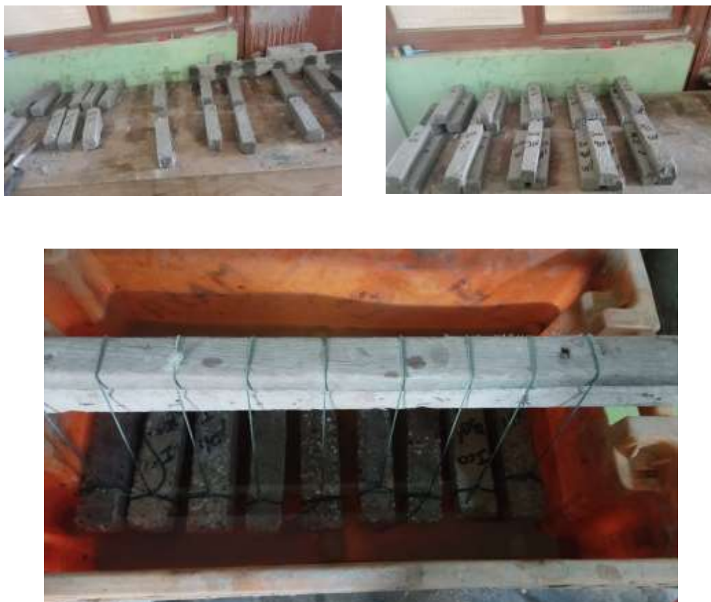
Fig. 28. Ensayo de cambio de longitud. Fuente Propia
