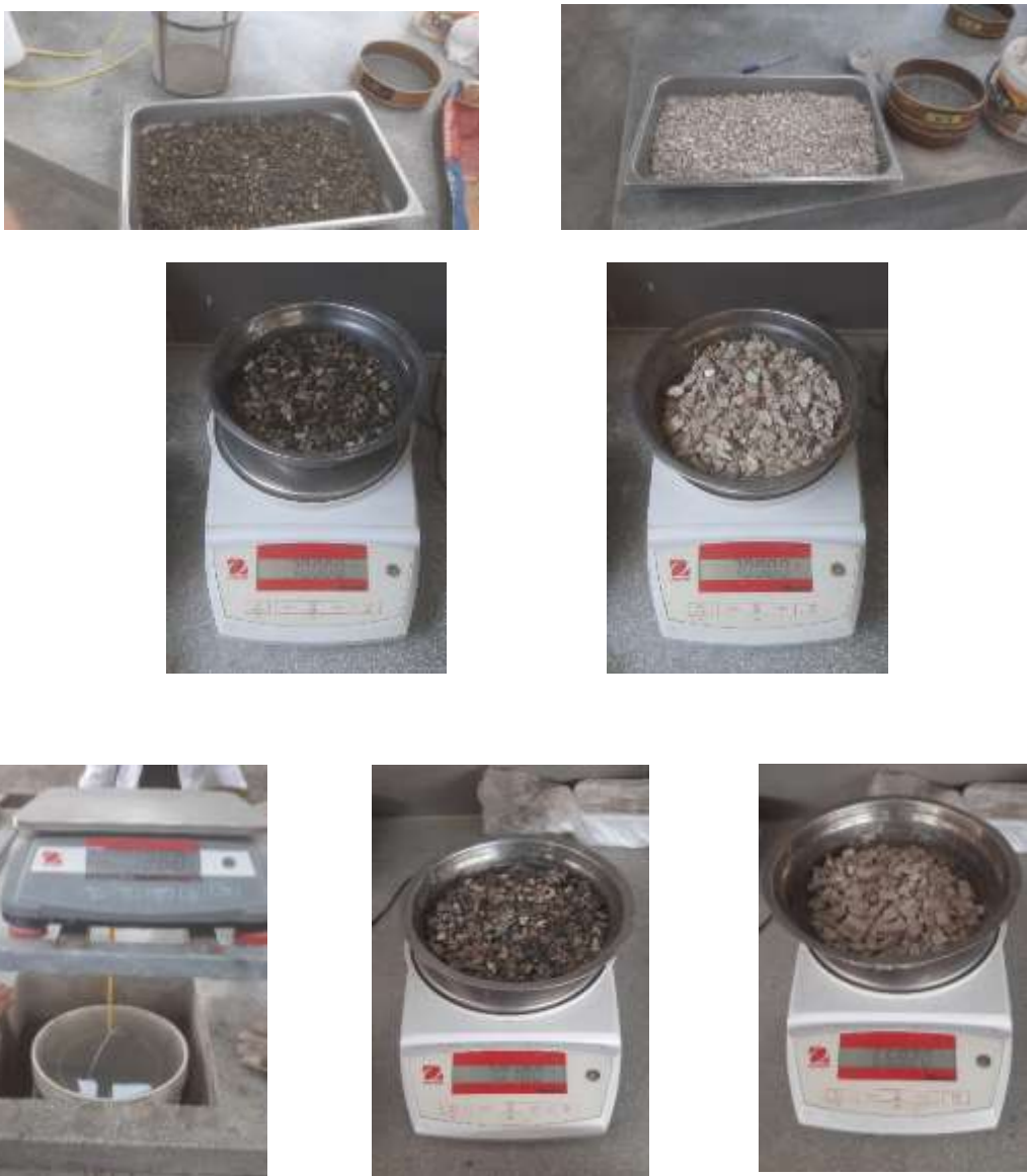
Fig. 15. Peso específico y absorción del AG. Fuente Propia
