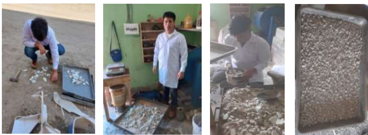
Fig. 10. Procesamiento de trituración y tamizado del material reciclado. Fuente Propia
