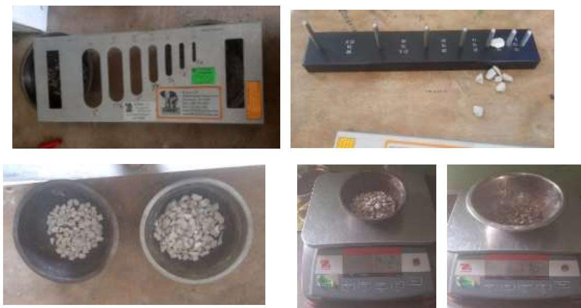
Fig. 17. Índice de alargamiento y aplanamiento. Fuente Propia
