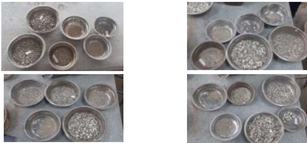
Fig. 12. Granulometría de agregado combinado. Fuente Propia
