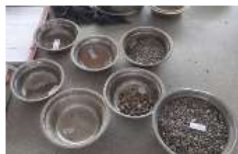
Fig. 11. Ensayo de granulometría de los agregados. Fuente Propia
