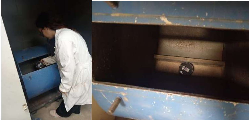
Imagen N° 32: Colocación de la muestra asfáltica para ensayo Cántabro
