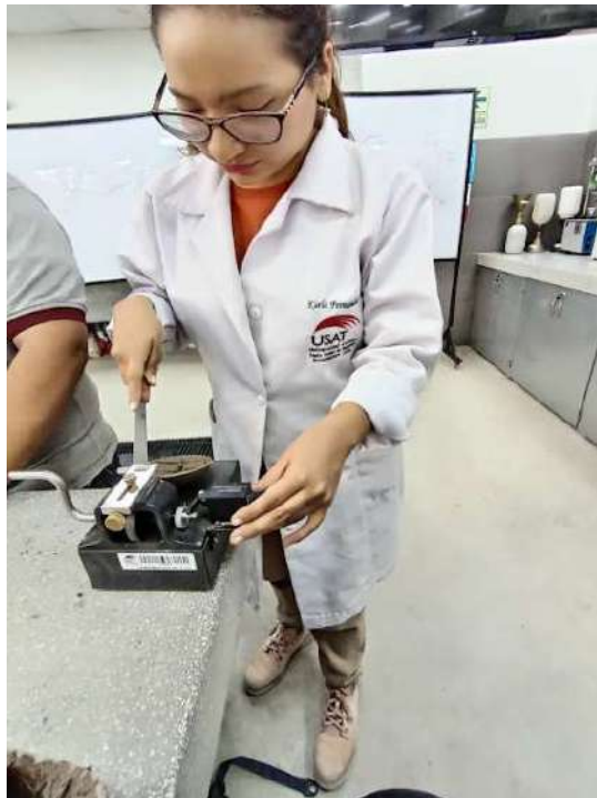
Imagen N° 11: Índice de Plasticidad en agregado fino
