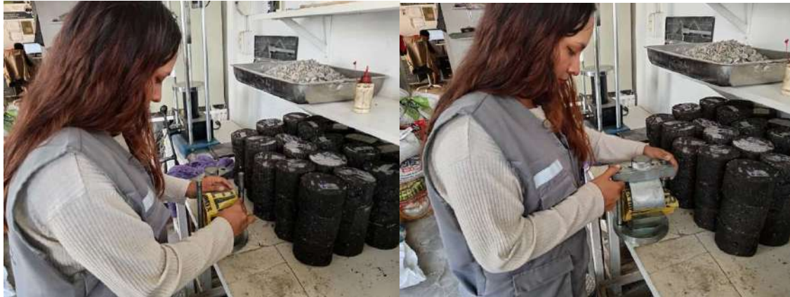
Imagen N° 30: Colocación de cabezales en ensayo Marshall
