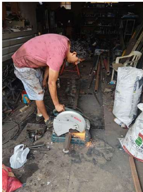
Imagen N° 2: Corte de materiales metálicos
