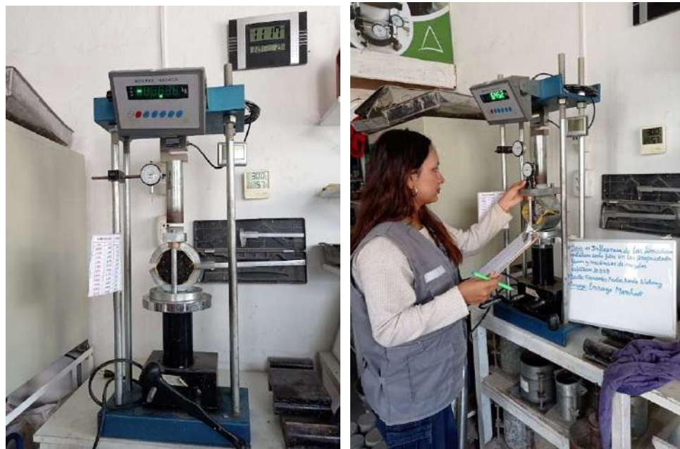
Imagen N° 31: Toma de datos en ensayo Marshall
