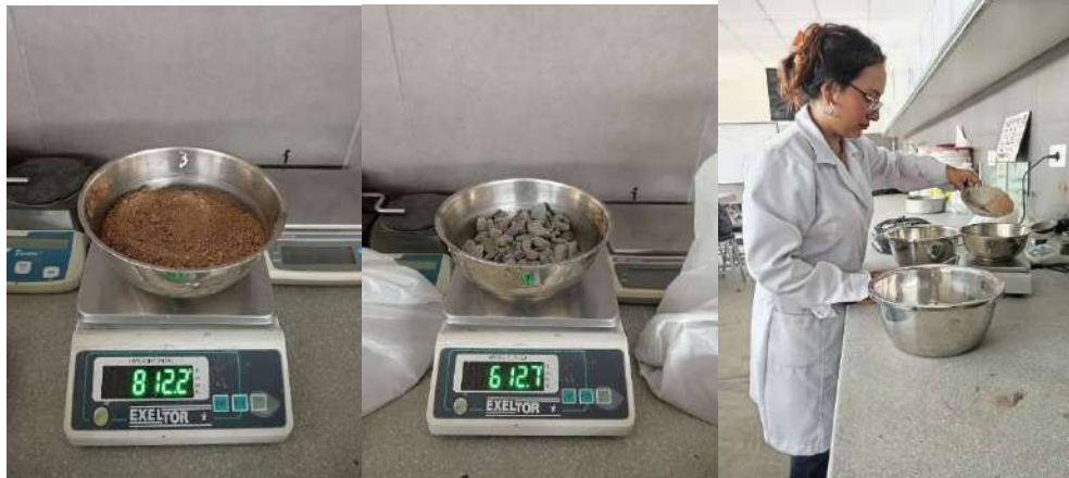
Imagen N° 16: Pesaje de agregados para mezcla
