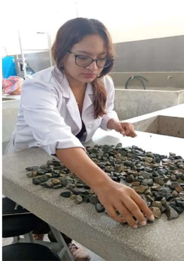
Imagen N° 6: Peso específico y absorción de agregado grueso
