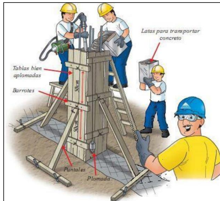
Imagen 11: Proceso Constructivo del Vaciado de Columnas
