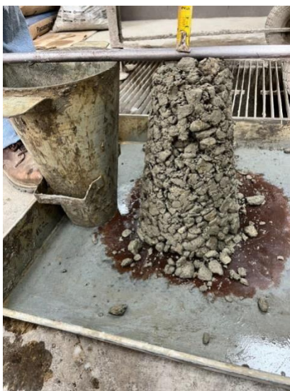
Figura 39. Medición del slump D°1.
