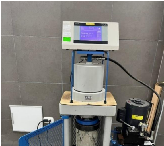
Figura 55. F'c-D^{\circ}1-7 días-218.7 kg/cm 2
