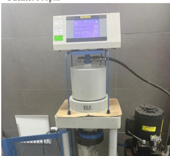
Figura 59. F'c-D^{\circ}1-14 días-323.2 kg/cm 2
