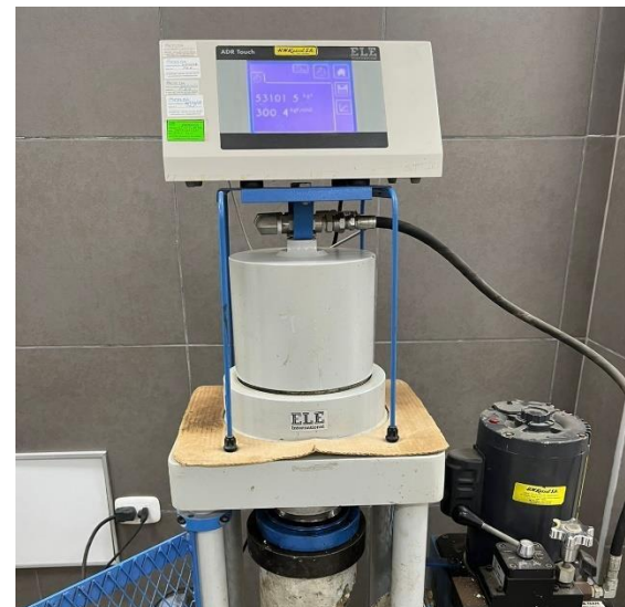
Figura 58. F'c-D^{\circ}1-14 días-300.4 kg/cm 2
