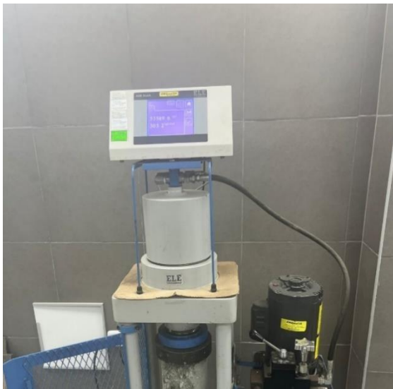
Figura 57. F'c-D^{\circ}2-7 días-303.2 kg/cm 2
