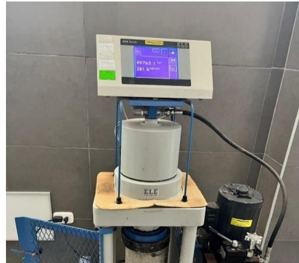
Figura 56. F'c-D^{\circ}2-7 días-281.6 kg/cm 2
