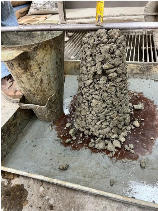
Figura 51. Medición del slump D°1.
