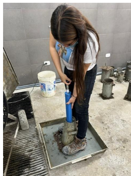
Figura 40. Varillado con martillo Proctor D°1
