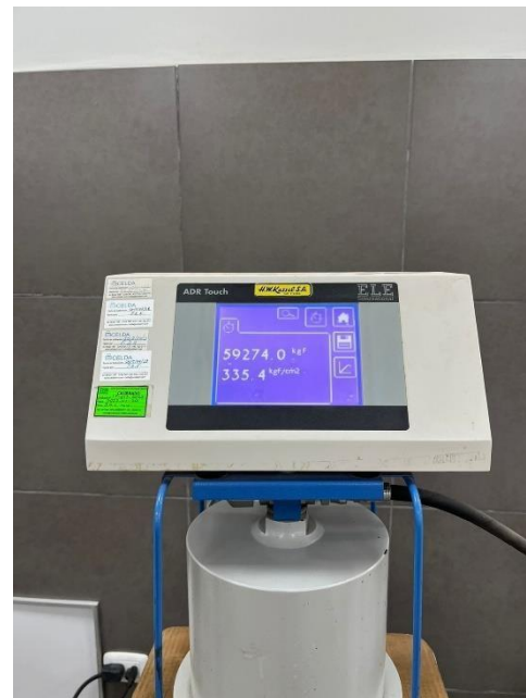
Figura 63. F'c-D^{\circ}2-14 días-335.4 kg/cm 2
