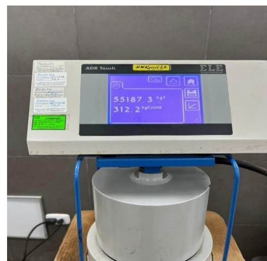
Figura 60. F'c-D^{\circ}1-14 días-300.4 kg/cm 2
