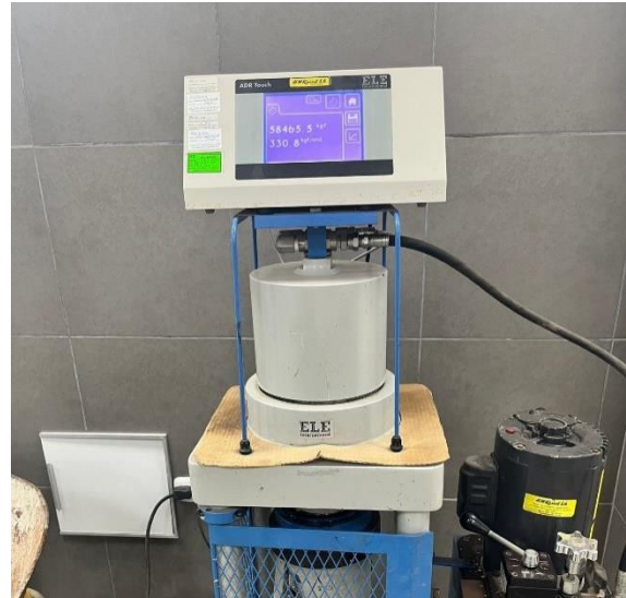
Figura 61. F'c-D^{\circ}2-14 días-330.8 kg/cm 2
