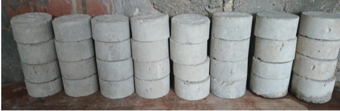
Figura 27. Núcleos de concreto convencional y experimental para prueba de desgaste.
