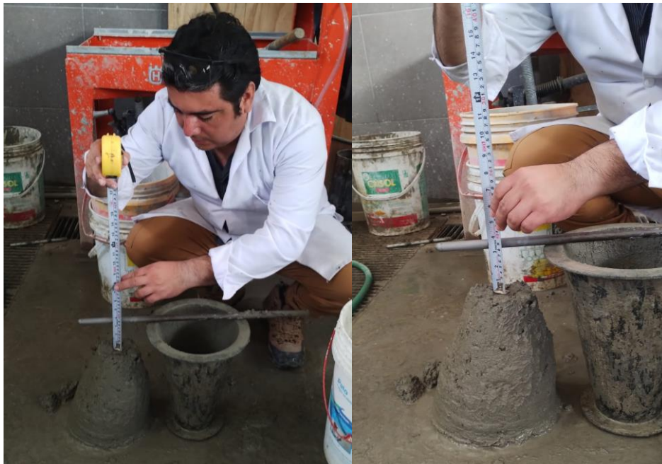
Figura 18. Slump de diseño de mezcla convencional.
