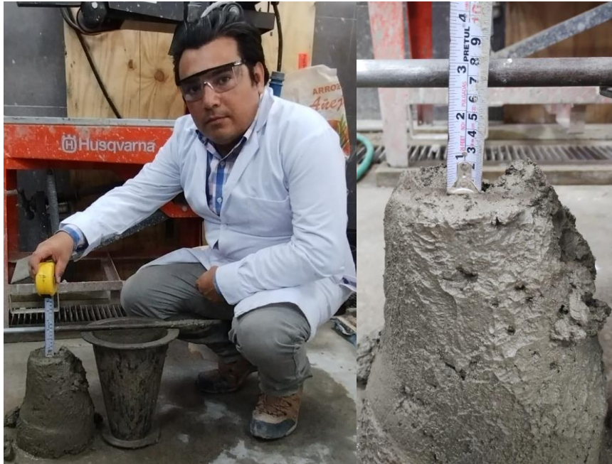
Figura 19. Slump de diseño de mezcla experimental (1 era adición).
