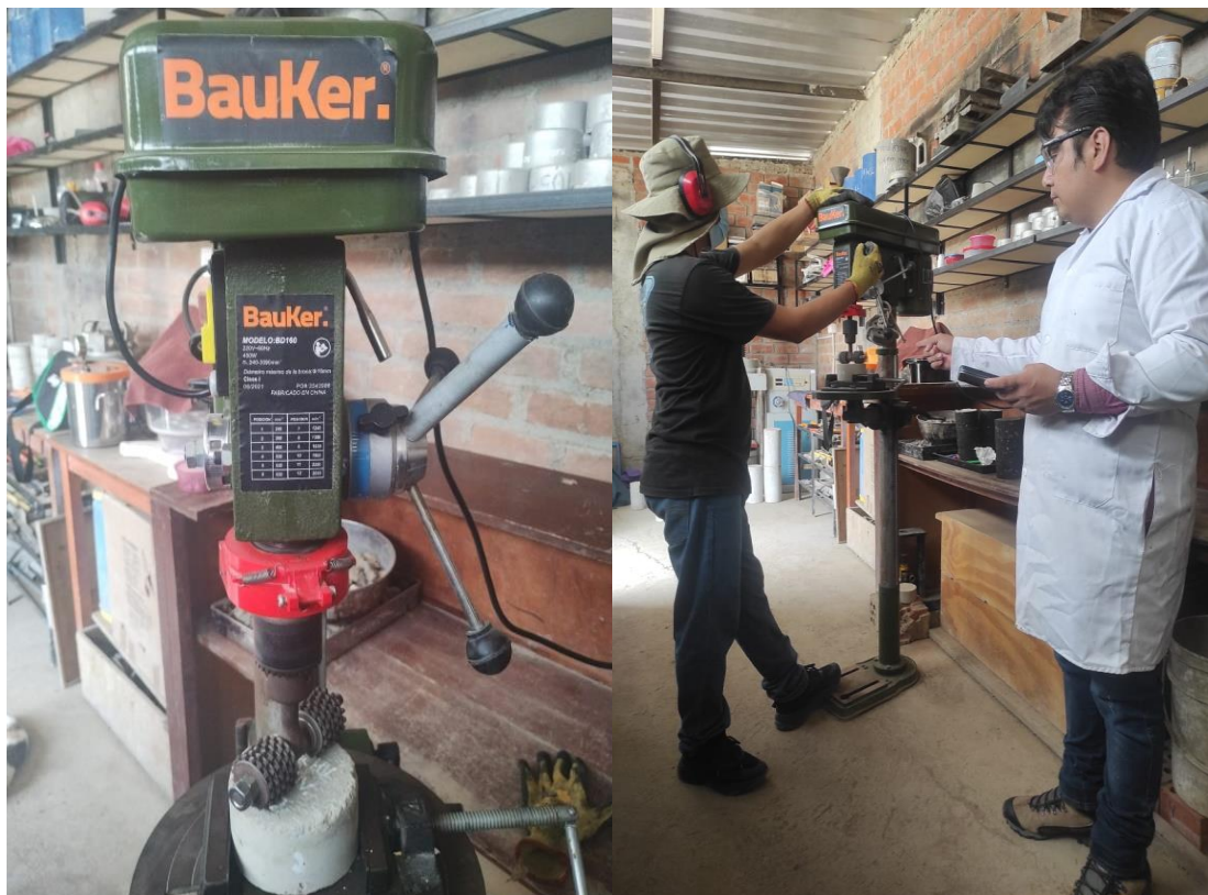
Figura 28. Sondeo de desgaste en probetas convencionales y experimentales.
