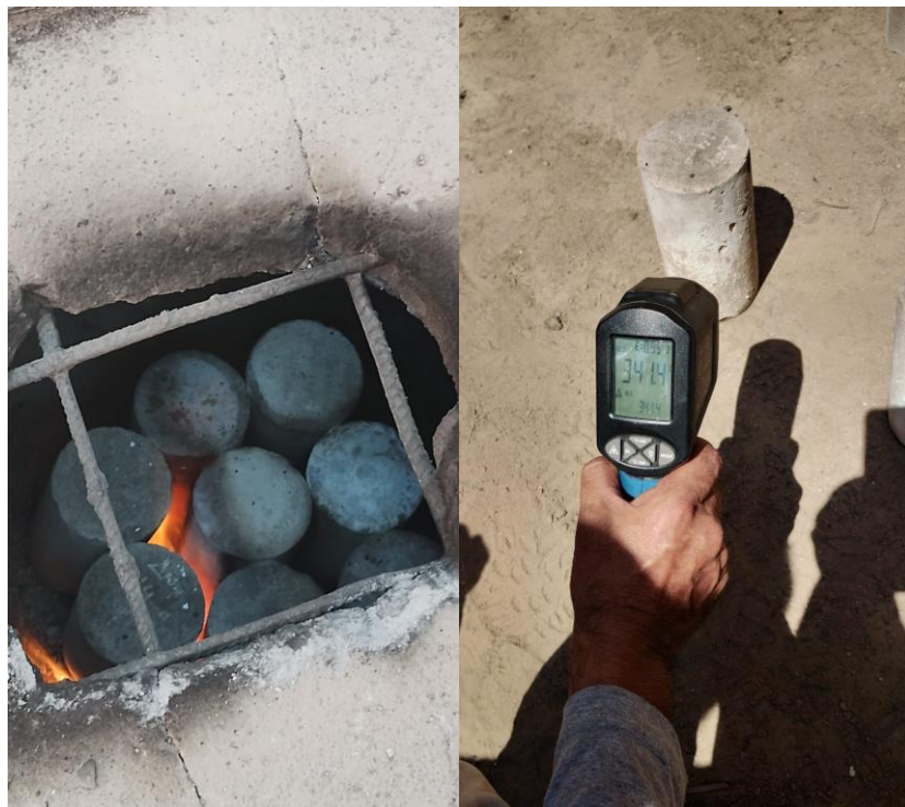
Figura 30. Evaluación por efecto de temperatura en probetas convencionales y experimentales.
