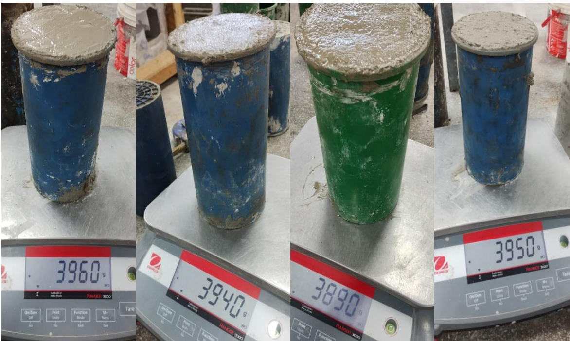
Figura 22. Pesos de probetas convencionales y experimentales en estados frescos.
