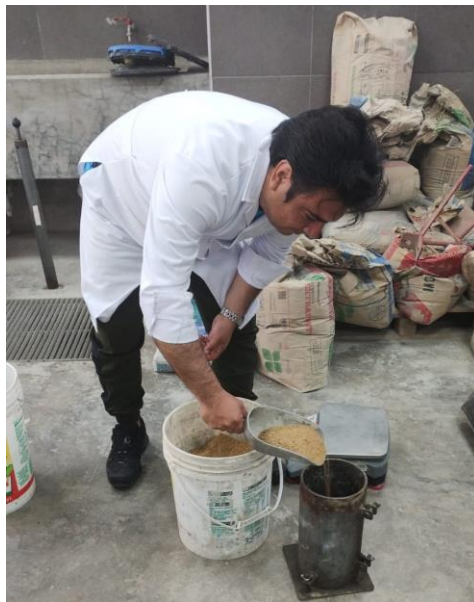
Figura 12. Pesos secos sueltos de agregados.
