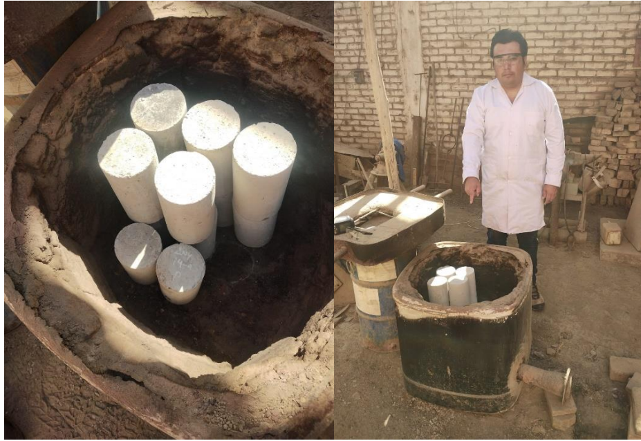
Figura 29. Probetas convencionales y experimentales para prueba a fuego.
