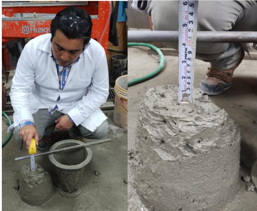
Figura 21. Slump experimental (3 era adición).
