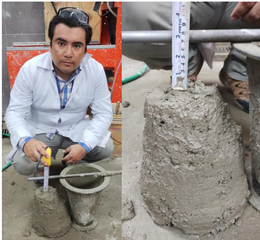
Figura 20. Slump experimental (2 da adición).
