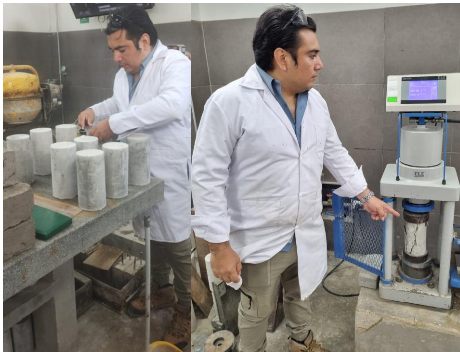
Figura 26. Medición con rotura en probetas convencionales y experimentales.
