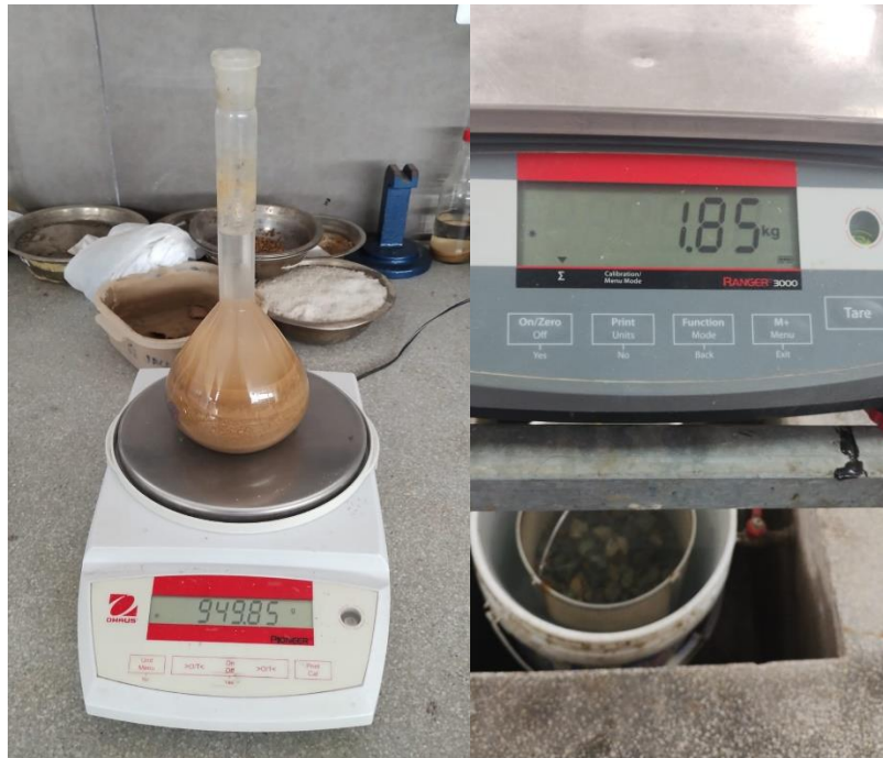
Figura 14. Pesos específicos de agregados.
