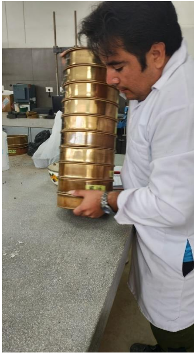
Figura 11. Granulometría de agregados.
