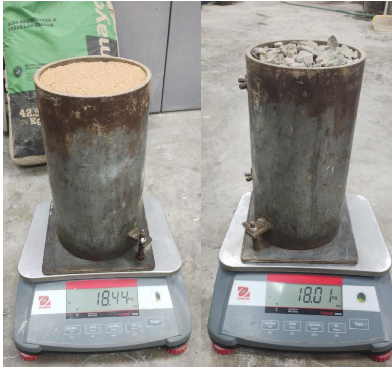
Figura 13. Pesos secos compactados de agregados.
