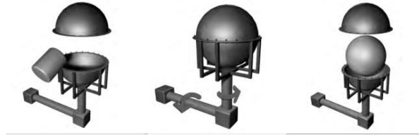
Figura 1. Etapas del proceso de Rotomoldeo
