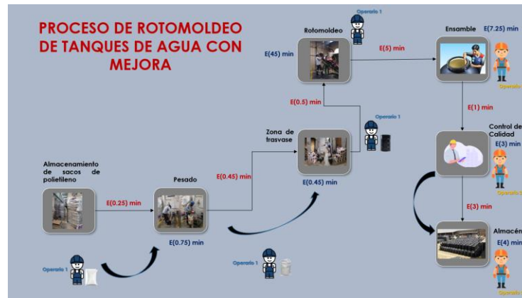
Figura 4. Diagrama del proceso propuesto Fuente: Elaboración propia
