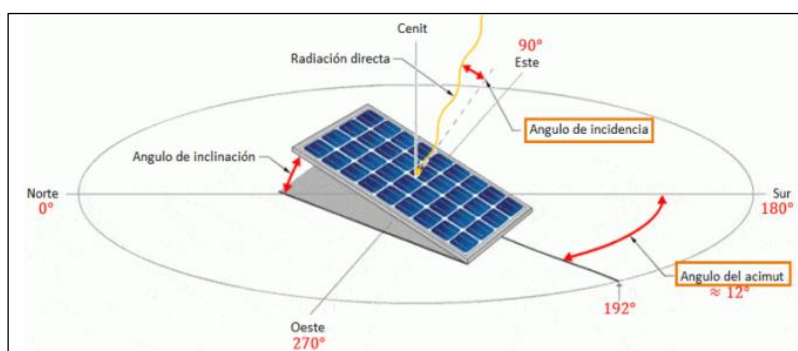
Fig. 12: Ángulo Azimutal y Ángulo de Inclinación. [22]
