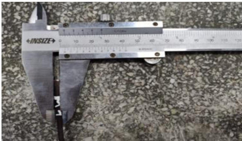
Figura 13 Medición de diámetro (espesor) de virutas de acero pre-tratamiento de oxidación.
