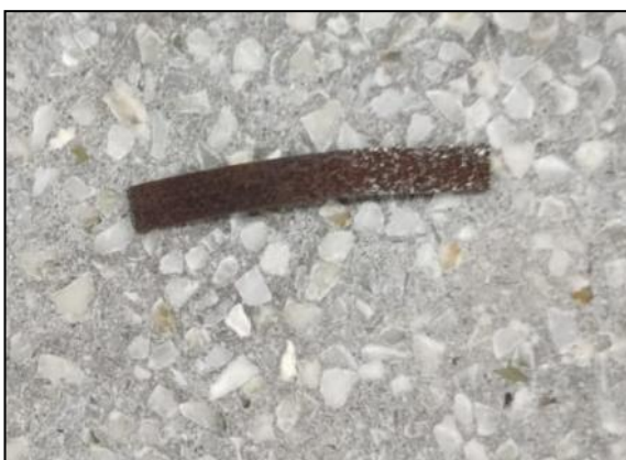
Figura 46 Aspecto rugoso de viruta de acero oxidada.
