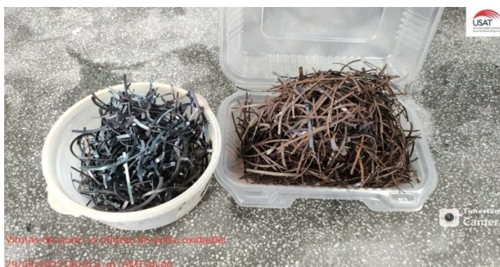
Figura 12 Comparación de virutas de acero en su estado normal vs superficialmente oxidadas. Fuente Propia.
