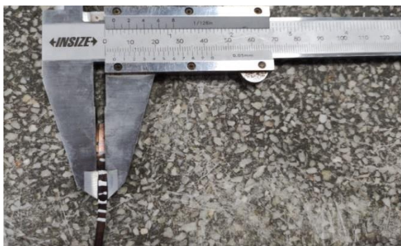
Figura 45 Medición de espesor de virutas de acero.
