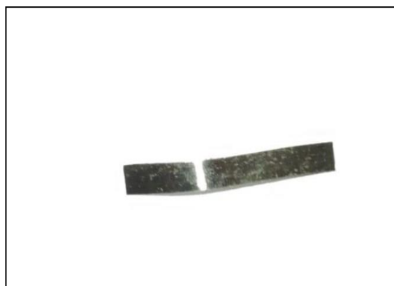
Figura 47 Aspecto liso de viruta de acero.
