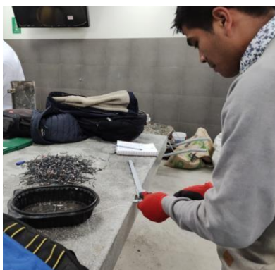
Figura 7 Caracterización de la forma geométrica de virutas de acero. Fuente propia.
