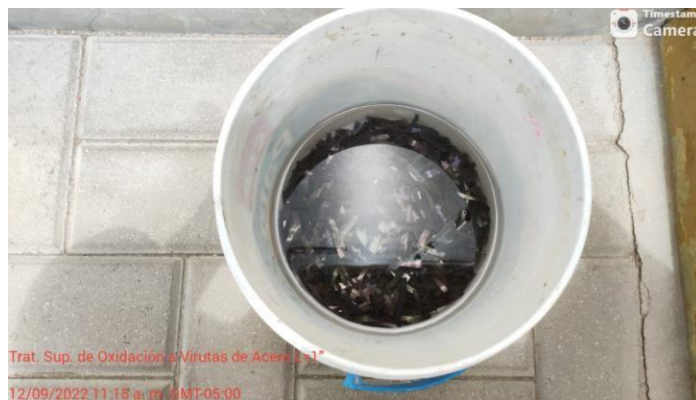
Figura 10 Virutas de acero sumergidas en agua durante un periodo de 3h. Fuente propia.
