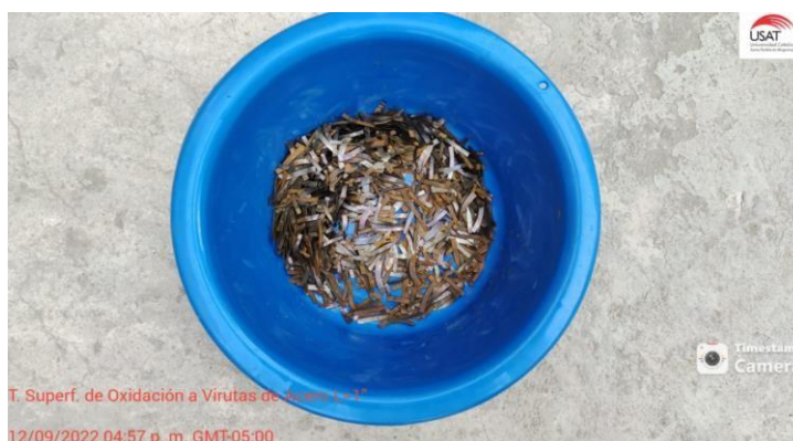
Figura 11 Exposición de virutas de acero a condiciones ambientales. Fuente Propia.
