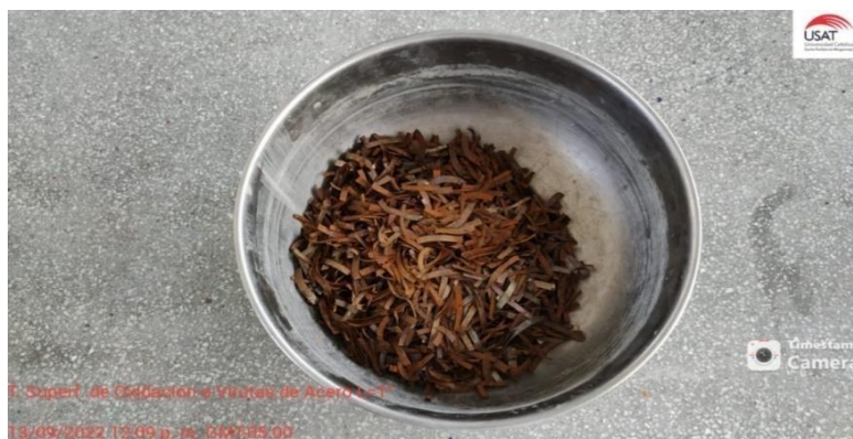
Figura 24 Tratamiento de oxidación a nivel superficial de virutas de acero.
