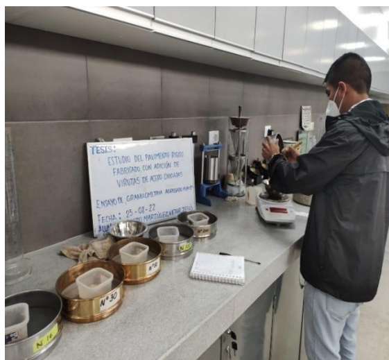
Figura 48 Fotos de ensayo de agregado fino para diseño de mezcla.
