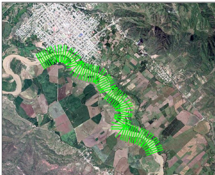
Ilustración 24: Secciones transversales cada 65 m en ArcGIS
