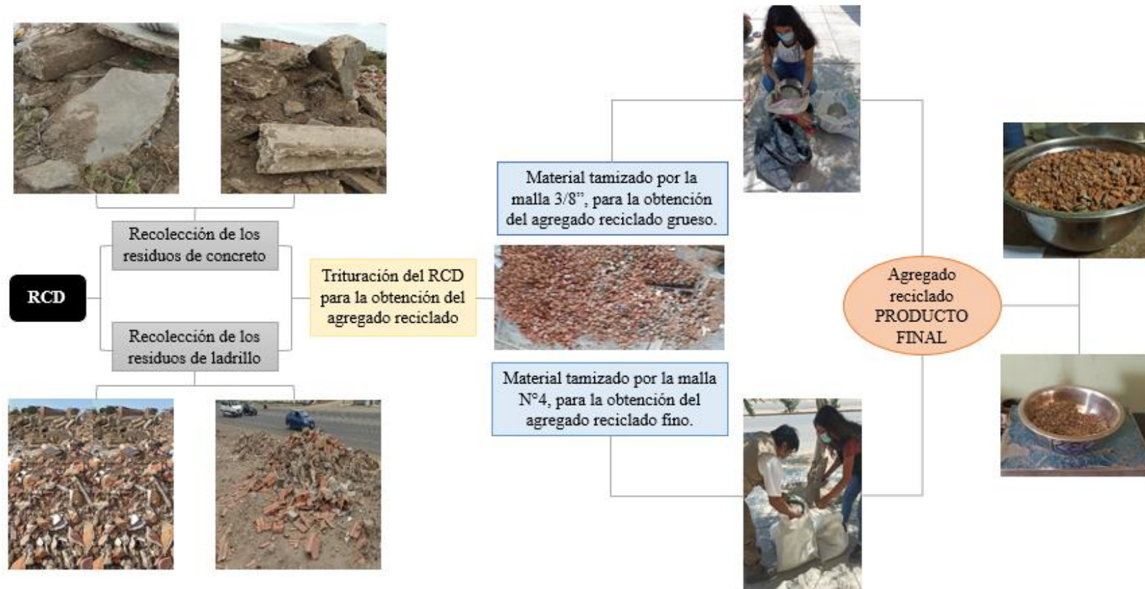
Figura 10: Esquema de la obtención del agregado reciclado.
