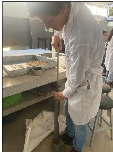
Figura N° 16: Ensayo Proctor modificado. Fuente: Propia
