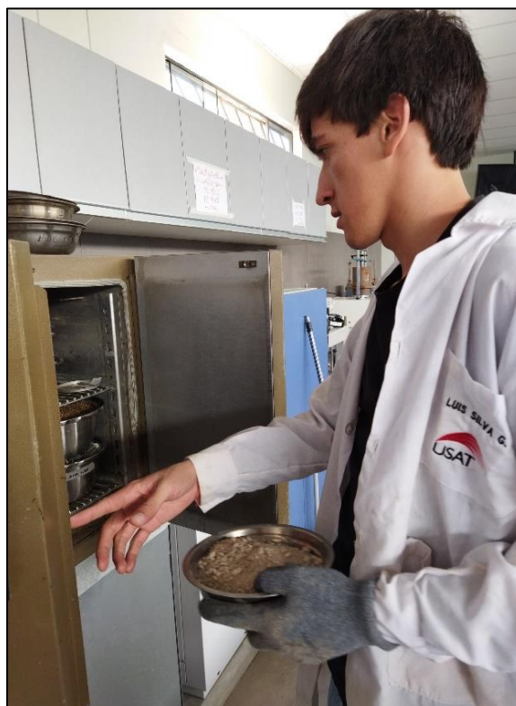
Figura N° 10: Ensayo de contenido de humedad. Fuente: Propia
