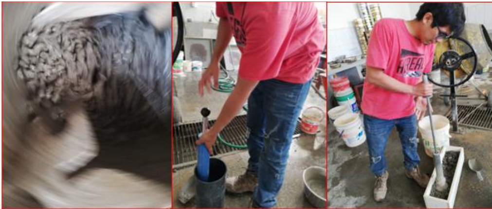
Ilustración 52 Mezclado y llenado de moldes para el concreto permeable
