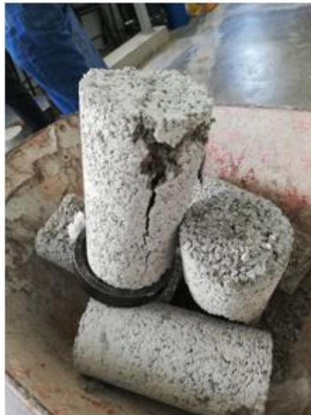
Ilustración 72 Residuos de los testigos ensayados
