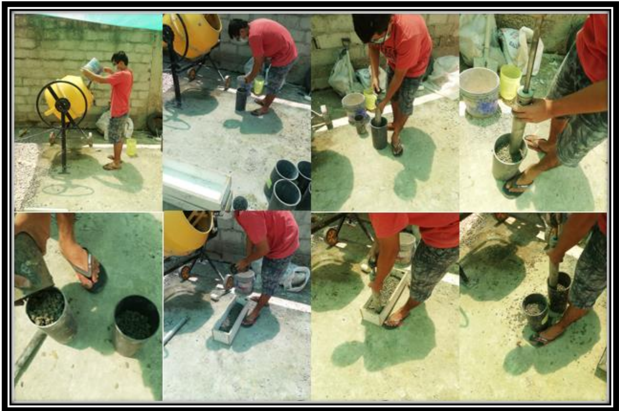
ANEXO 25 Elaboración y desencofrado de los testigos de concreto permeable del Grupo C
