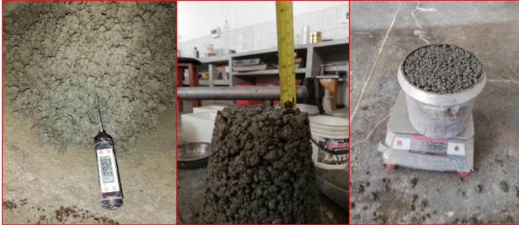
Ilustración 53 Ensayos de concreto permeable en estado fresco
