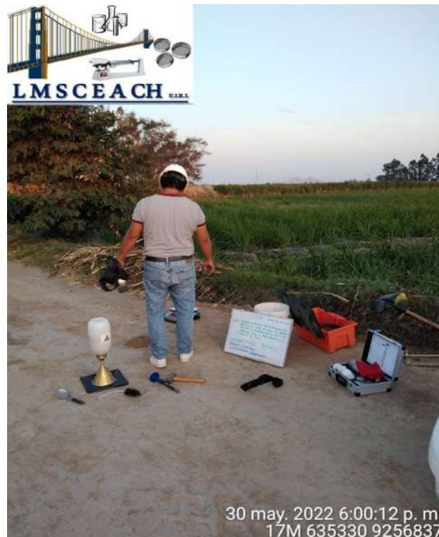
Figura N° 34. Densidad de campo Fuente: Fotografiado propio 2022
