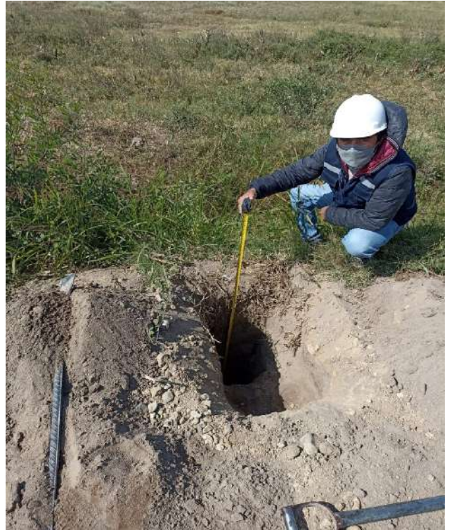
Figura N° 41. Profundidad de las calicatas Fuente: Fotografiado propio 2022
