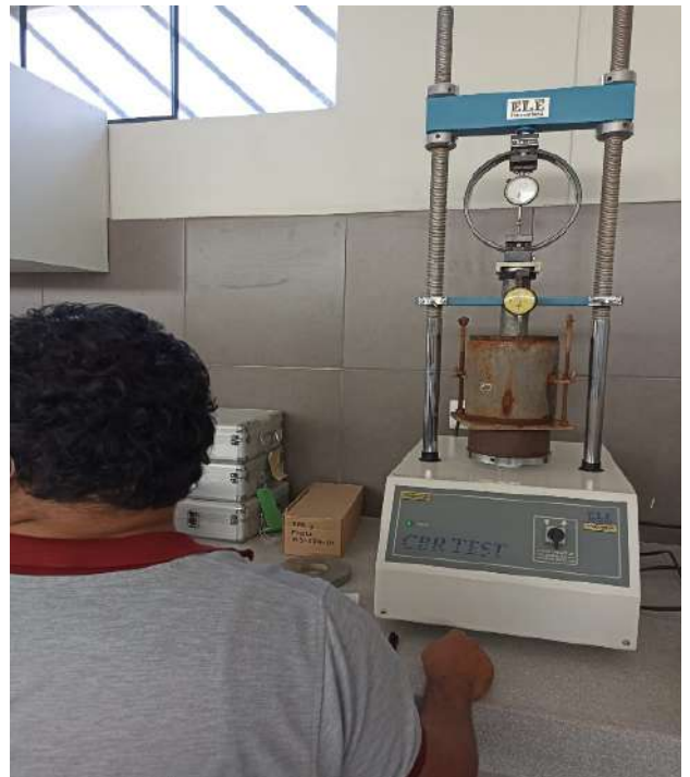
Figura N° 48. Saturación de muestras de CBR Fuente: Fotografiado propio 2022
