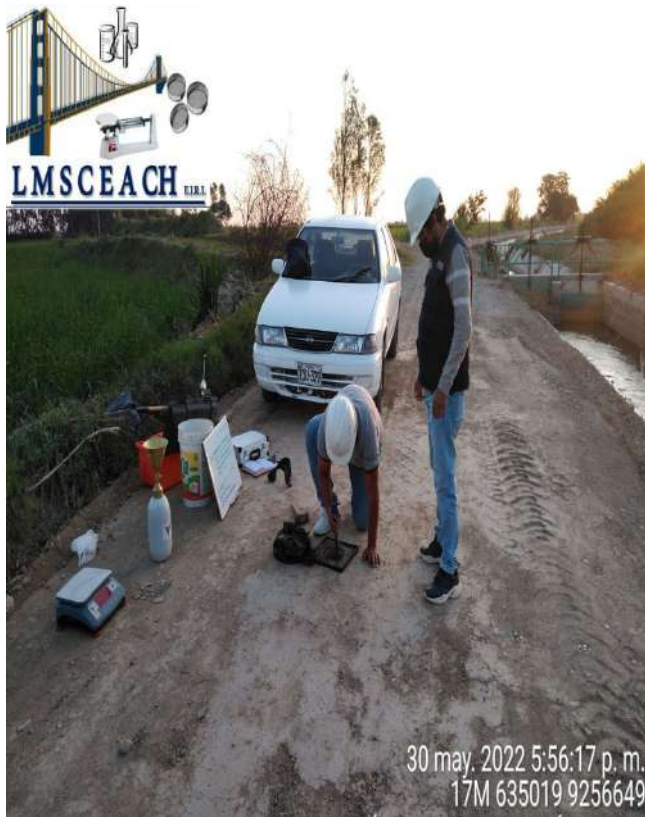
Figura N° 35. Densidad de campo – suelo con aditivo Fuente: Fotografiado propio 2022
