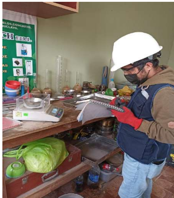
Figura N° 43. Ensayos granulométrico por tamizado Fuente: Fotografiado propio 2022
