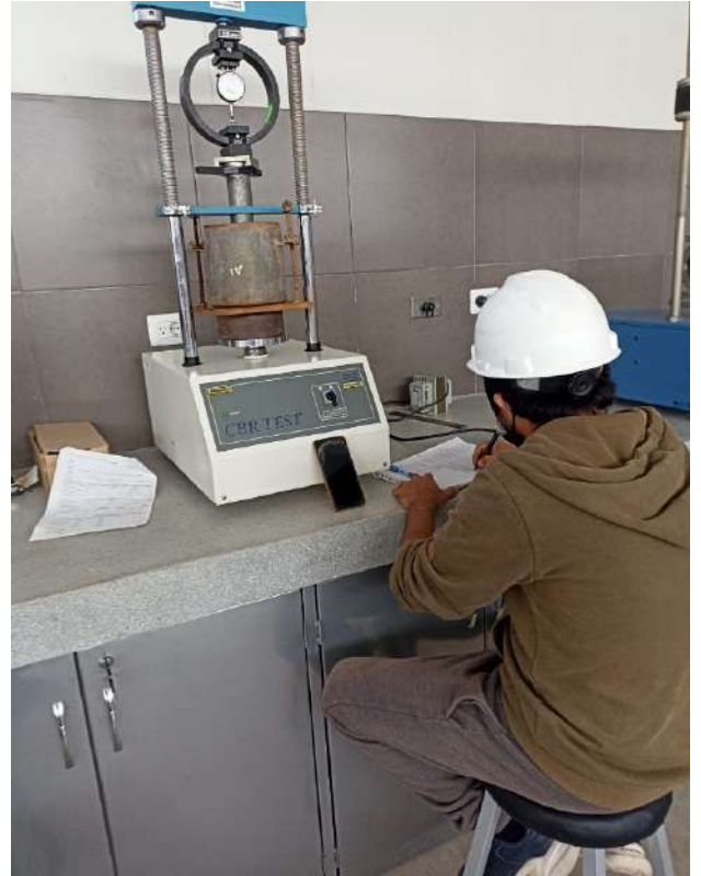
Figura N° 49. Ensayo de CBR Fuente: Fotografiado propio 2022
