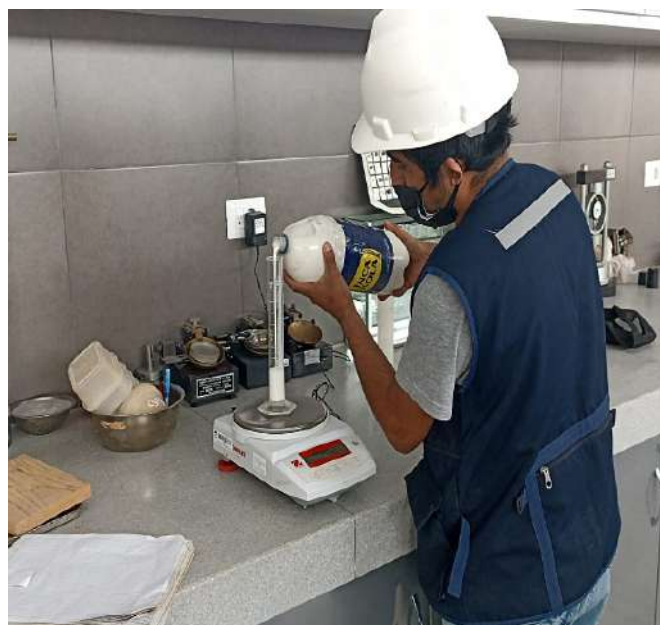
Figura N° 44. Cantidad de aditivo para Proctor y CBR Fuente: Fotografiado propio 2022
