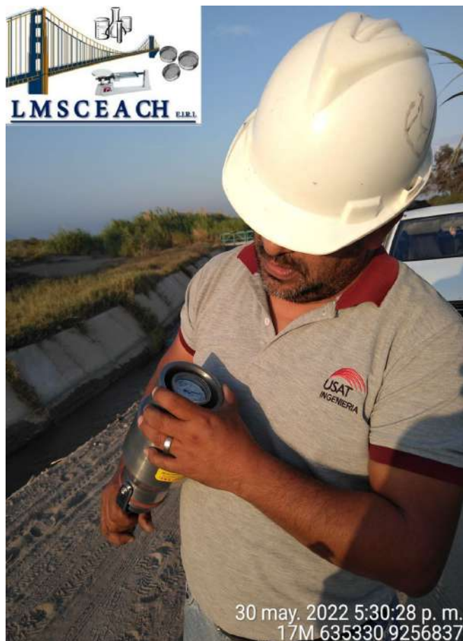
Figura N° 37. Contenido de humedad In-Situ - Speedy Fuente: Fotografiado propio 2022
