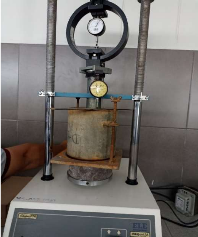
Figura N° 49. Ensayo de CBR Fuente: Fotografiado propio 2022
