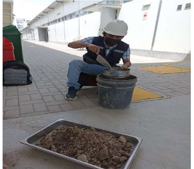
Figura N° 45. Preparación de muestra con cal Fuente: Fotografiado propio 2022
