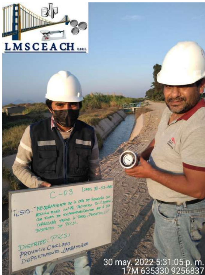
Figura N° 37. Contenido de humedad In-Situ - Speedy Fuente: Fotografiado propio 2022
