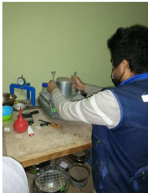
Figura N° 30. Peso – ensayo de Proctor modificado Fuente: Fotografiado propio 2022
