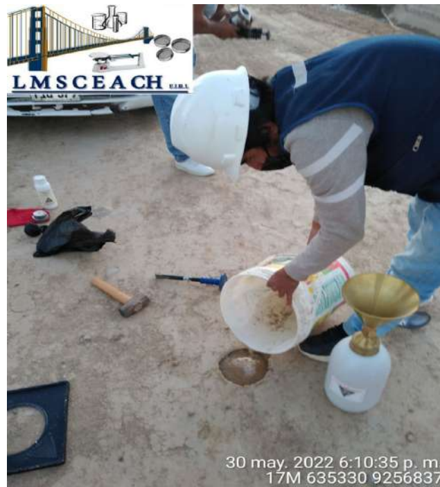
Figura N° 33. Test de percolación – con aditivo Fuente: Fotografiado propio 2022
