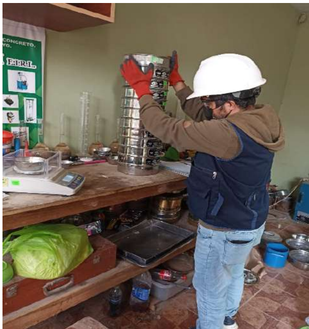
Figura N° 43. Ensayos granulométrico por tamizado Fuente: Fotografiado propio 2022
