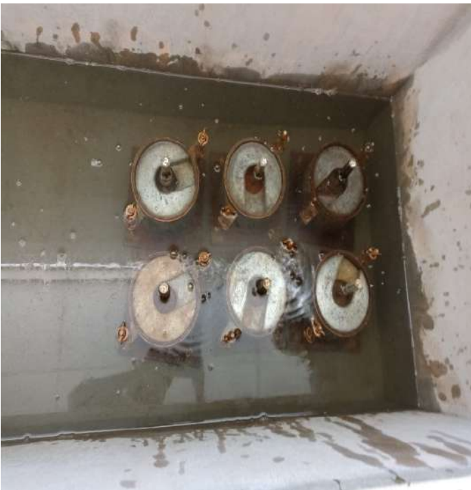
Figura N° 48. Saturación de muestras de CBR Fuente: Fotografiado propio 2022
