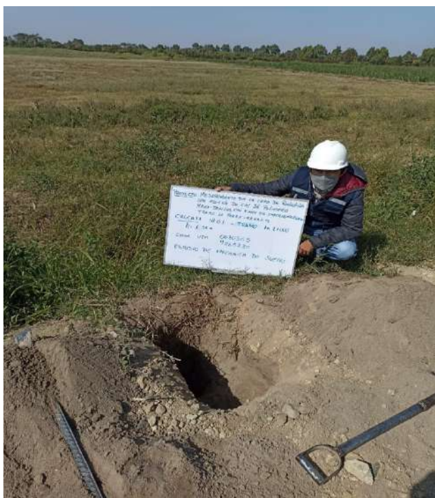
Figura N° 40. Extracción de muestras - calicatas Fuente: Fotografiado propio 2022
