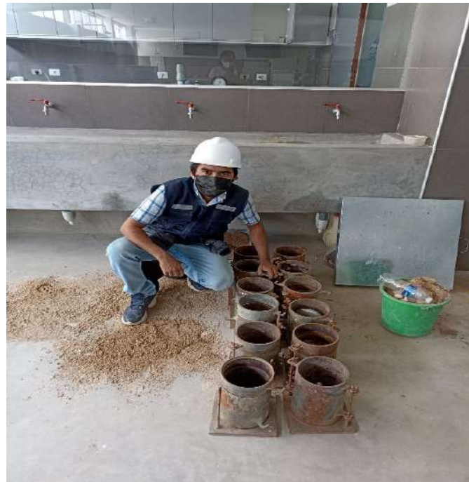
Figura N° 46. Moldes para CBR Fuente: Fotografiado propio 2022
