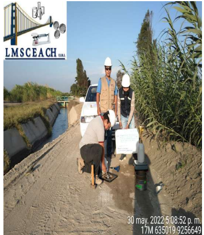
Figura N° 35. Densidad de campo – suelo con aditivo Fuente: Fotografiado propio 2022
