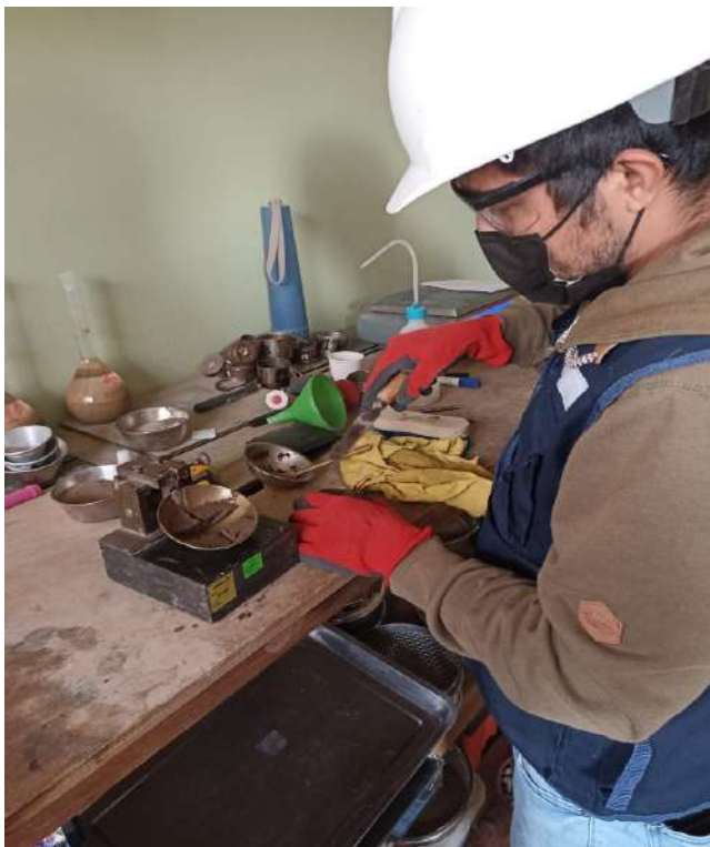
Figura N° 42. Límites de consistencia Fuente: Fotografiado propio 2022
