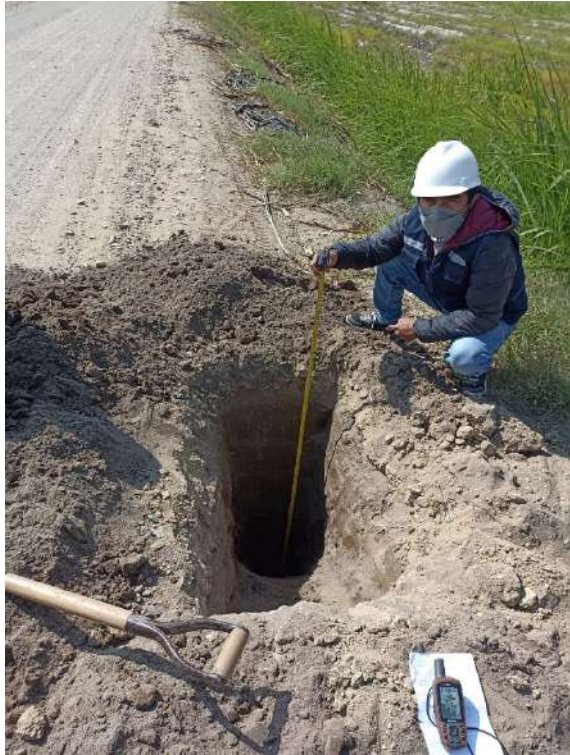
Figura N° 41. Profundidad de las calicatas Fuente: Fotografiado propio 2022
