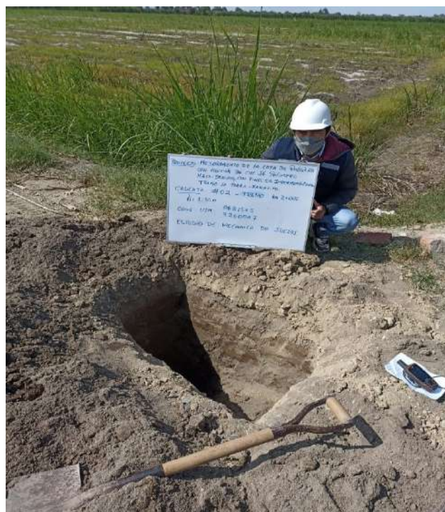
Figura N° 40. Extracción de muestras - calicatas Fuente: Fotografiado propio 2022
