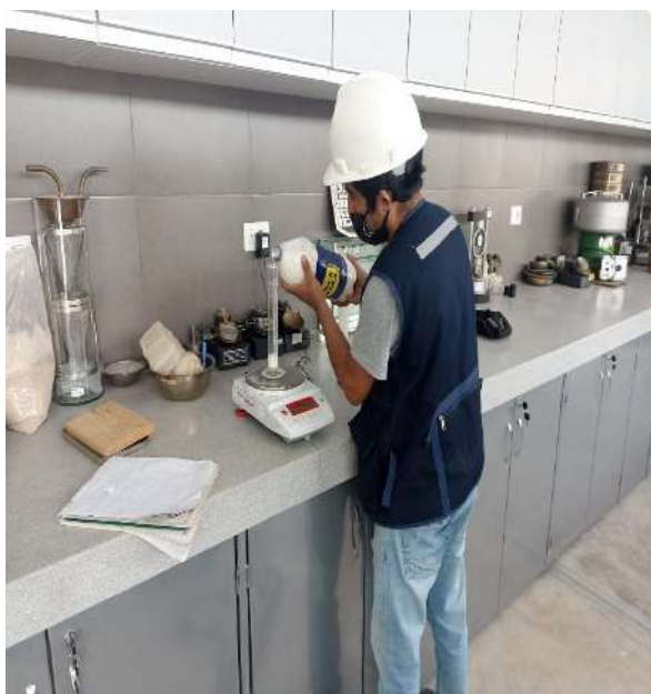
Figura N° 44. Cantidad de aditivo para Proctor y CBR Fuente: Fotografiado propio 2022
