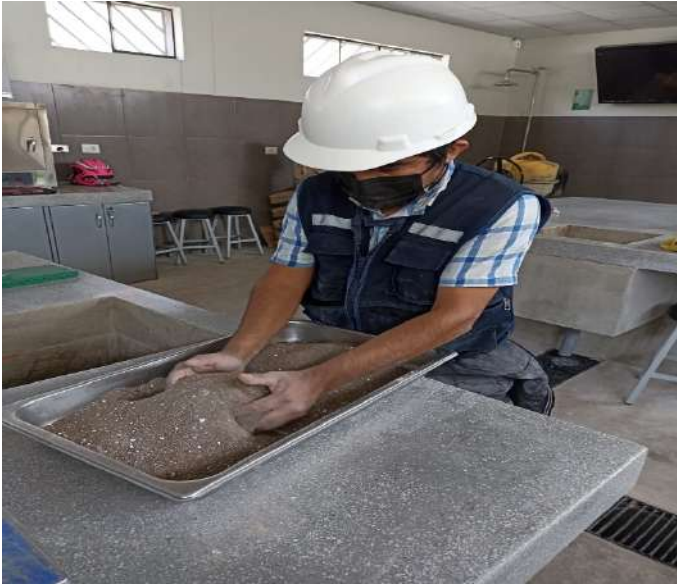
Figura N° 45. Preparación de muestra con cal Fuente: Fotografiado propio 2022
