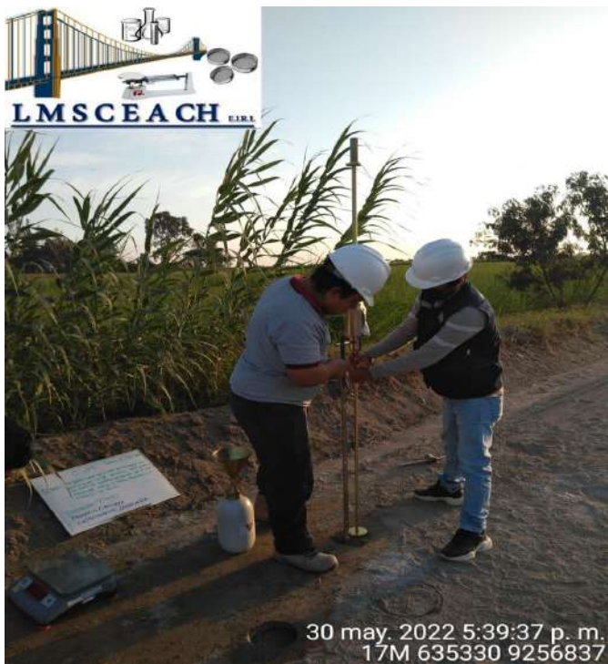
Figura N° 36. PDC – suelo con cal Fuente: Fotografiado propio 2022
