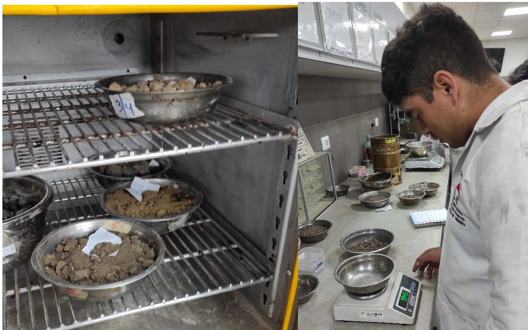
Fig. 22. Ensayo contenido de humedad
