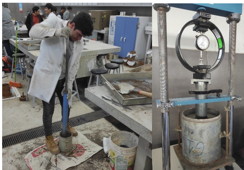
Fig. 31. Ensayo CBR en laboratorio
