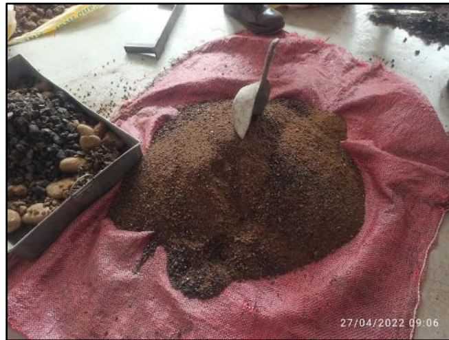
Fotografía 33: Mezcla compuesto de base granular y carpeta asfáltica
