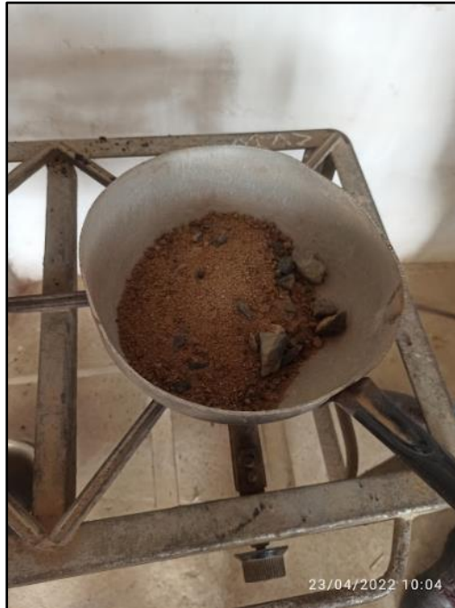
Fotografía 31: Agregados limpios de asfalto.
