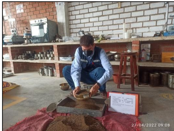
Fotografía 34: Granulometría combinación de base granular y carpeta asfáltica
