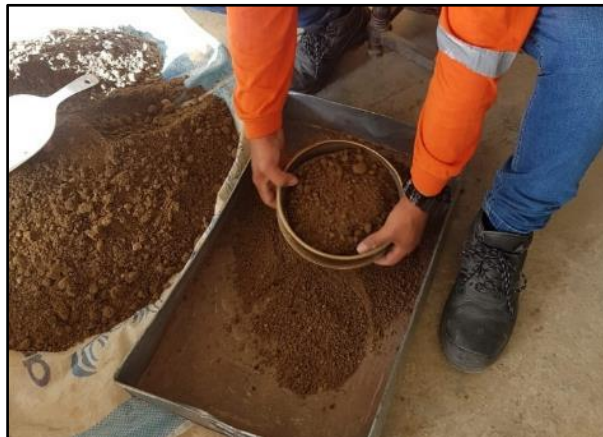
Fotografía 16: Granulometría agregado fino de la base granular..
