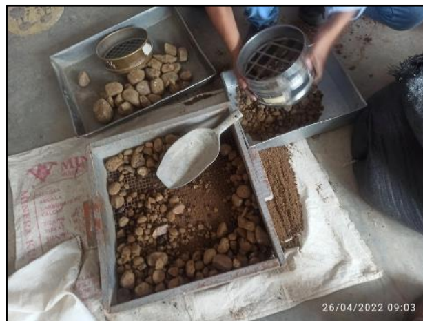
Fotografía 17: Tamizado antes de empezar con el ensayo de abrasión.
