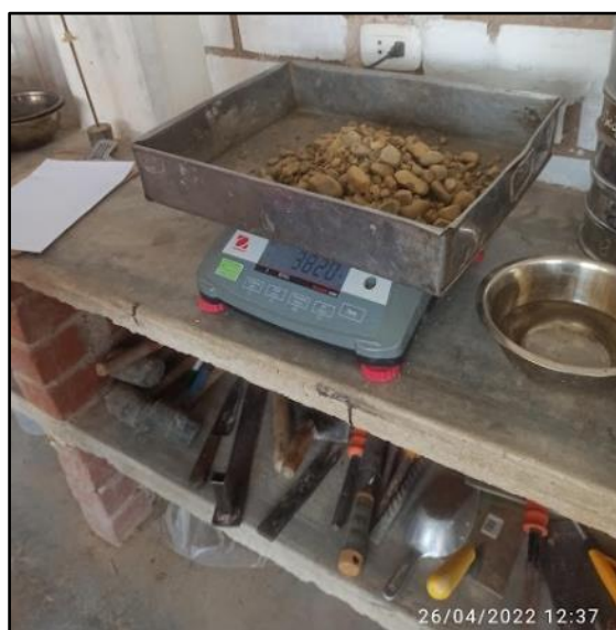
Fotografía 19: Muestra después del ensayo de abrasión
