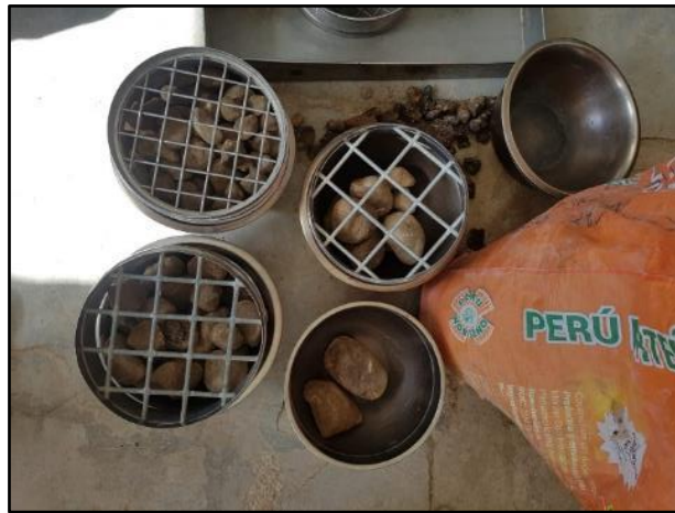
Fotografía 15: Granulometría agregado grueso de la base granular.
