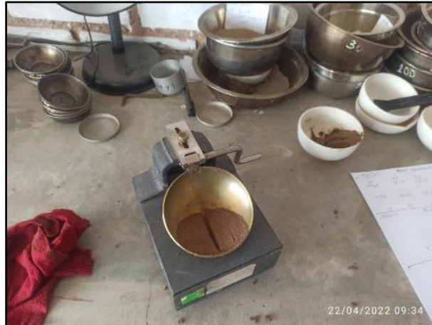
Fotografía 22: Uso de cazuela Casa Grande
