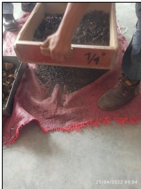
Fotografía 32: Tamizado de la combinación de base granular y carpeta asfáltica
