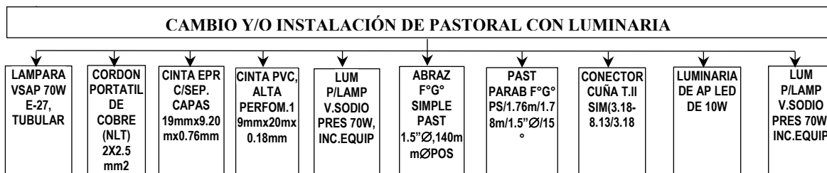
Figura 5: Cambio y/o Instalación de Pastoral y/o Luminaria.
