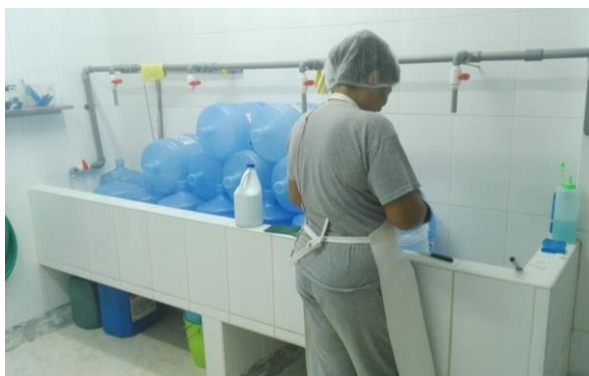
Figura 5. Prelavado manual de bidones
