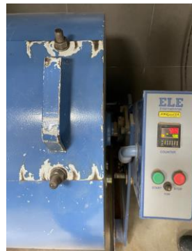
Figura 32: Rotación de la máquina de Los Ángeles
