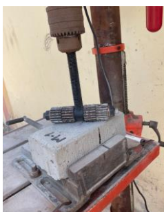
Figura 51: Cortador en contacto con la superficie muestra de adoquín
