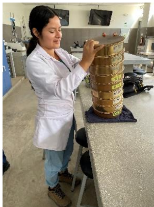
Figura 14: Tamizado del agregado grueso
