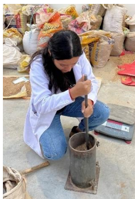
Figura 28: Compactación del agregado
