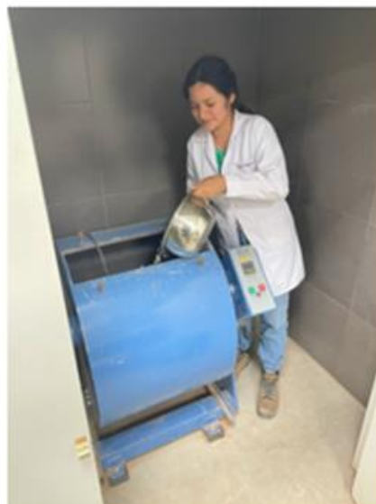
Desgaste de abrasión – Máquina de los Ángeles
