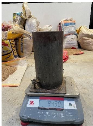
Figura 30: Peso del agregado fino compactado
