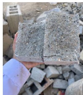
Figura 48: Muestra patrón de adoquín después del ensayo
