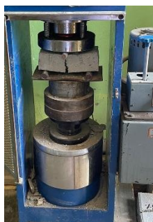
Figura 50: Resultado del ensayo de tracción por flexión
