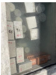
Figura 44: Proceso de saturación de los adoquines
