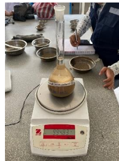
Figura 24: Peso del agua y la fiola con la muestra
