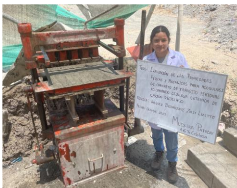
Figura 38: Concreto + 6% de adición vertido en los moldes y vibrado
