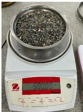
Figura 17: Prueba del agregado superficialmente seco
