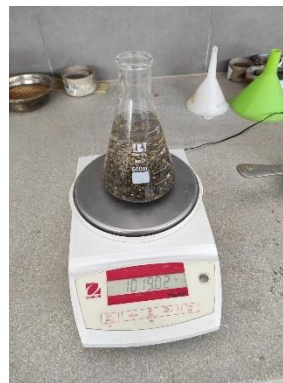
Figura 18: Peso de la muestra con agua en el matraz
