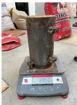
Figura 27: Peso del agregado fino para peso unitario
