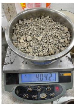
Figura 33: Peso retenido en el tamiz N°12
