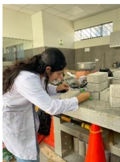
Figura 43: Medición de los adoquines
