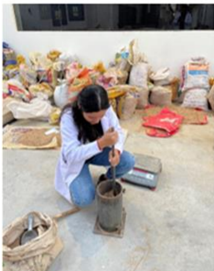
Compactación del agregado fino
