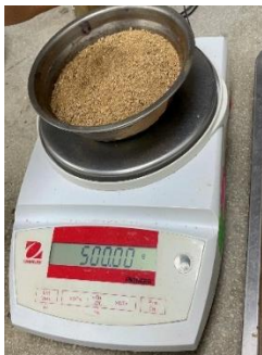
Figura 22: Peso de la muestra superficialmente seca
