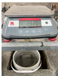
Figura 45: Peso de una muestra de adoquín sumergido
