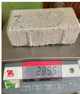
Figura 53: Peso de la muestra luego del ensayo
