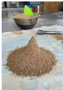
Figura 21: Muestra en condición superficialmente seca
