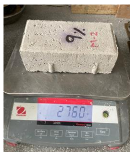
Figura 46: Peso seco de una muestra de adoquín
