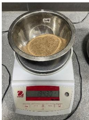
Figura 16: Tamiz N°50 - Peso retenido
