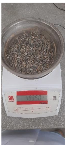
Figura 19: Peso del agregado grueso seco
