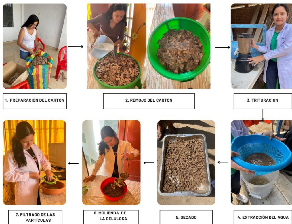
Figura 9: Pasos para la extracción de la celulosa
