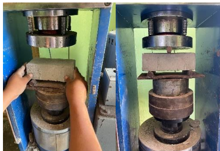
Figura 49: Ubicación del adoquín para el ensayo de tracción por flexión
