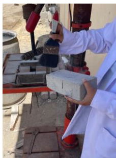
Figura 52: Limpieza de la superficie del espécimen
