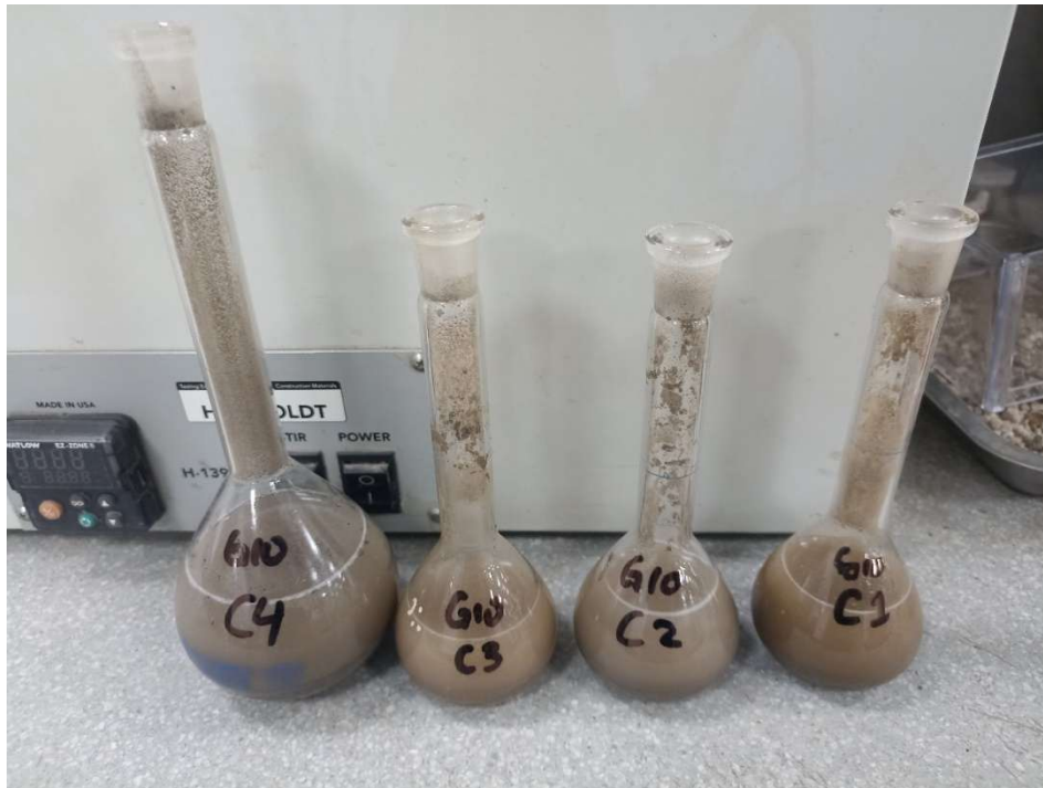
Figura 45. Muestras saturadas para gravedad específica.
