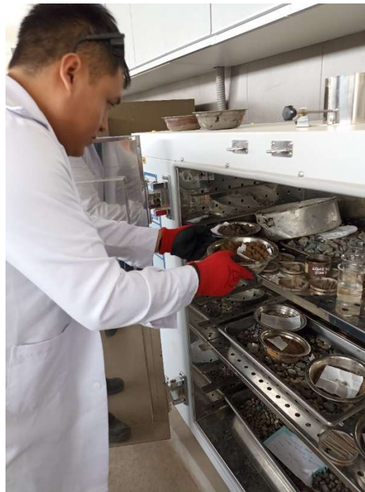
Figura 38. Colocación de muestras saturadas en horno para contenido de humedad.
