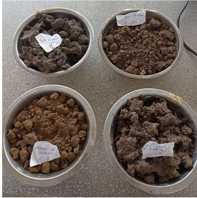
Figura 37. Preparación de muestras para contenido de humedad
