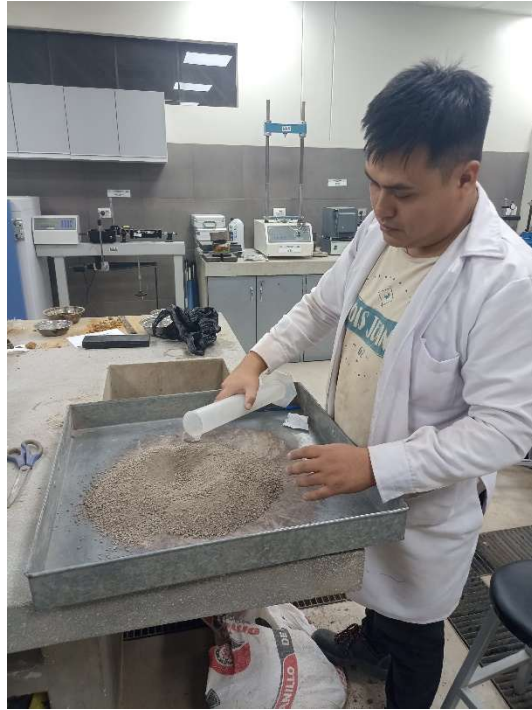
Figura 47. Preparación de muestras para proctor modificado.
