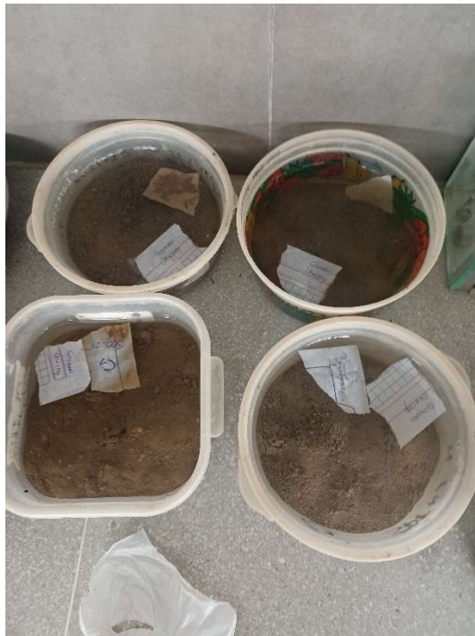
Figura 39. Peso de muestras secas para contenido de humedad.
