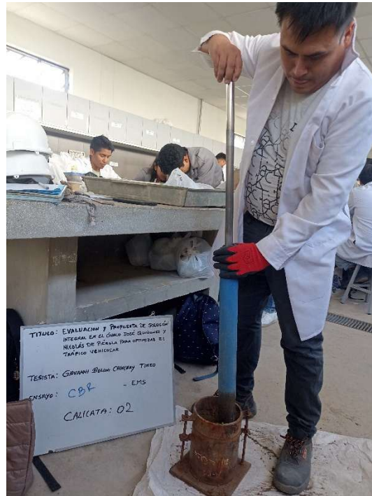
Figura 49. Muestra compactada para CBR.
