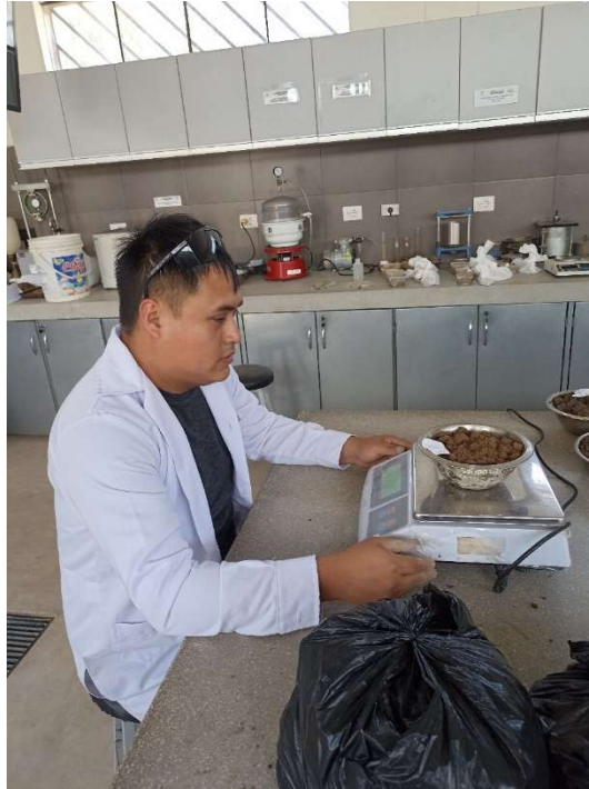
Figura 39. Peso de muestras secas para contenido de humedad.
