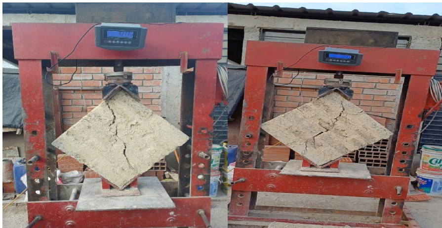
Figura 31: Murete ensayado a resistencia a compresión diagonal.
