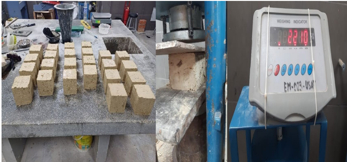
Figura 27: Prueba de resistencia a compresión a los 28 días de cubos.
