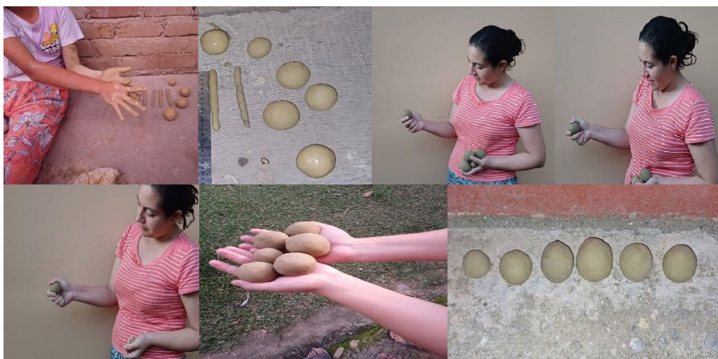
Figura 14: Prueba de resistencia seca.
