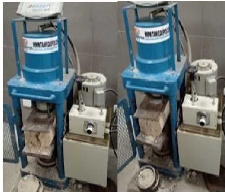
Figura 35: Ensayo del adobe a resistencia a tracción.
