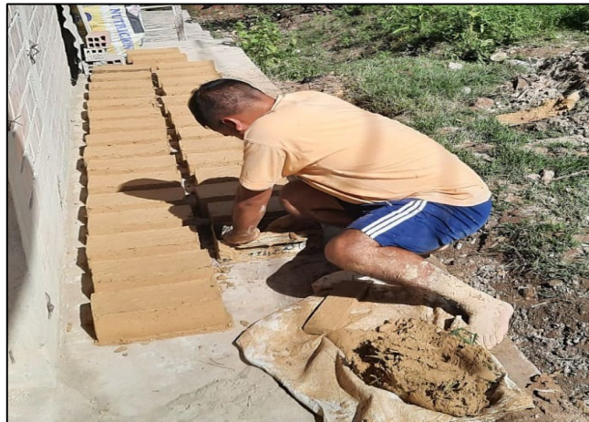
Figura 47: Desmolde y secado del adobe normal.
