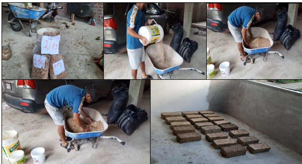
Figura 50: Adobe de prueba para la elaboración del adobe compactado.
