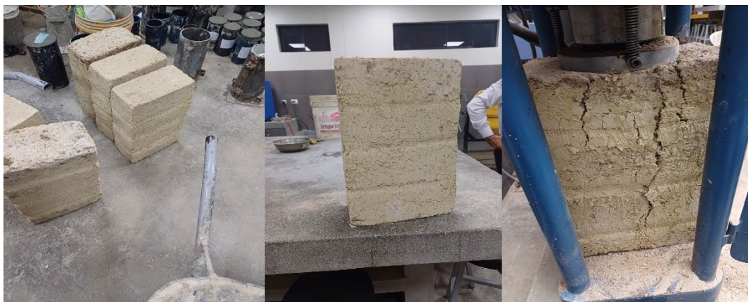
Figura 33: Ensayo del adobe a resistencia a compresión.
