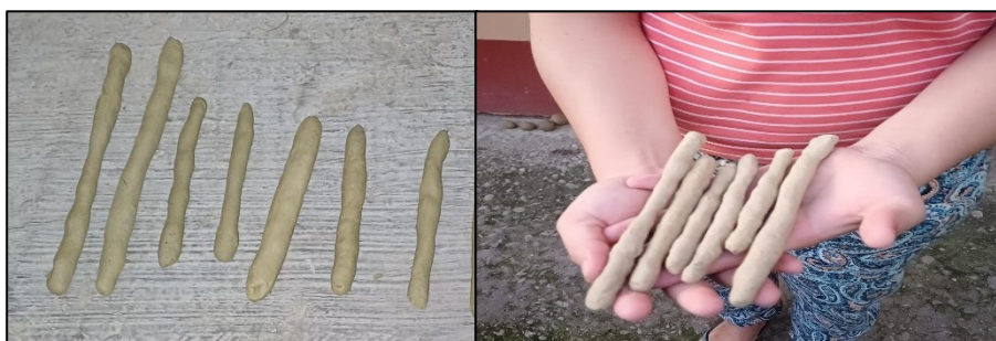
Figura 13: Prueba de cinta de barro.
