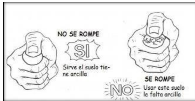
Figura 7: Condición de la Prueba de Resistencia Seca
