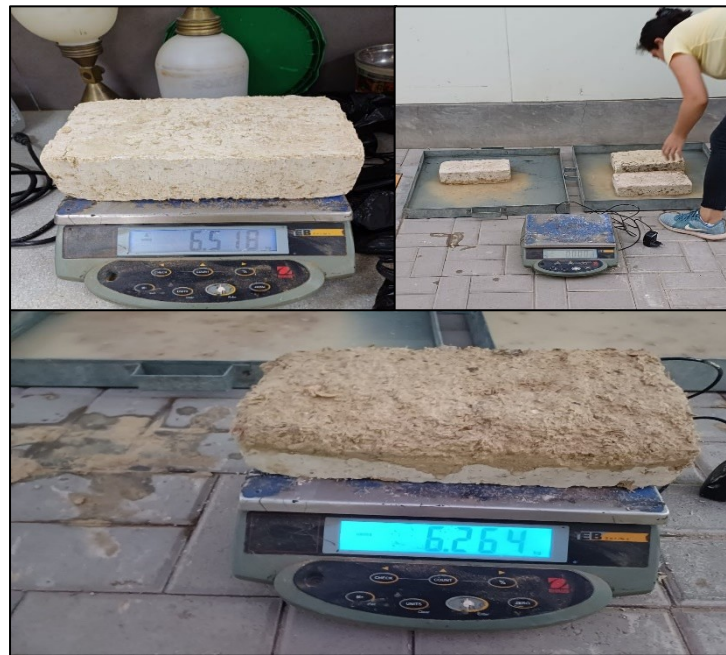
Figura 36: Pesaje del adobe seco y saturado.
