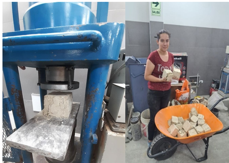
Figura 28: Ensayo realizado de resistencia a compresión y muestras ya ensayadas.
