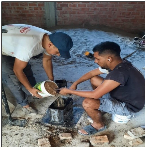
Figura 24: Vaciado de la mezcla a los moldes.
