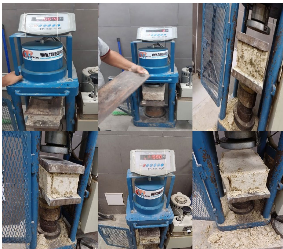
Figura 26: Prueba de resistencia a compresión.
