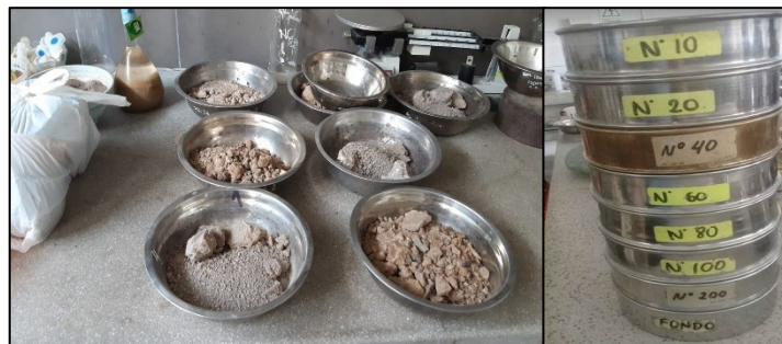
Figura 15: Muestras y tamices para el análisis granulométrico.
