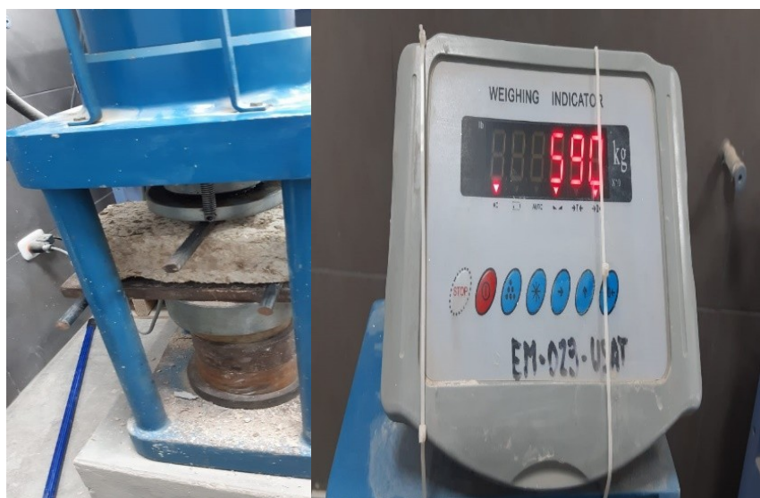
Figura 34: Ensayo del adobe a resistencia a la flexión.
