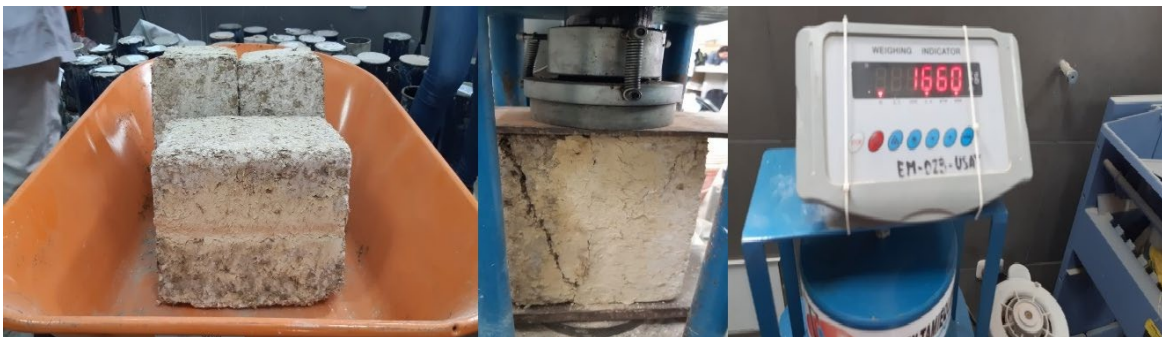
Figura 32: Ensayo de resistencia del mortero a tracción.
