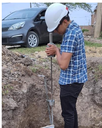
Fig. 91. Penetración del equipo DCP.
