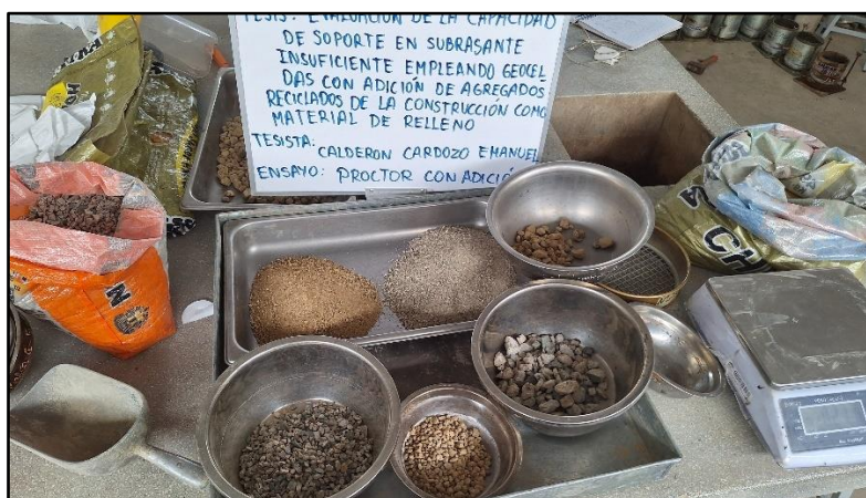
Fig. 74. Preparación de muestra de 5.6 Kg para Proctor Modificado.
