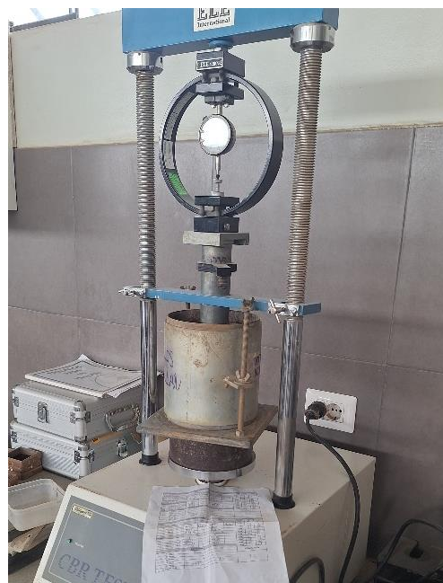
Fig. 38. Etapa final de penetración CBR.
