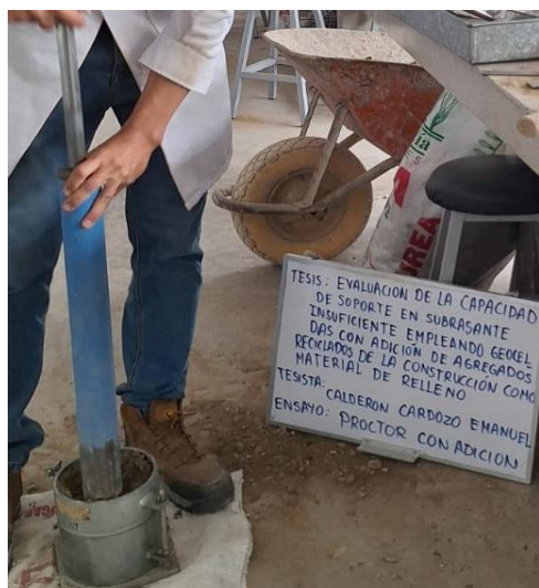
Fig. 77. Compactación de la mezcla de AR+ AF.
