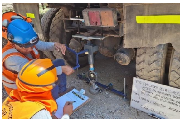
Fig. 108. Toma de lecturas de diales en tramo conformado por 60% AR+40% AF
