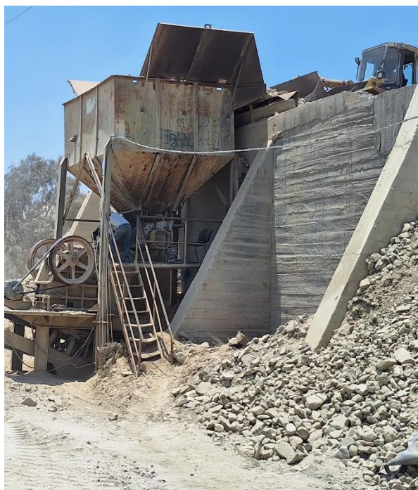
Fig. 46. Inicio de la trituración del agregado reciclado.
