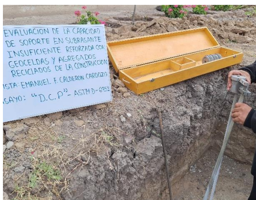
Fig. 89. Montaje de equipo DCP.
