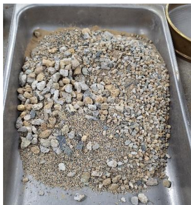
Fig. 58. Combinación de AR y AF para ensayo de granulometría.
