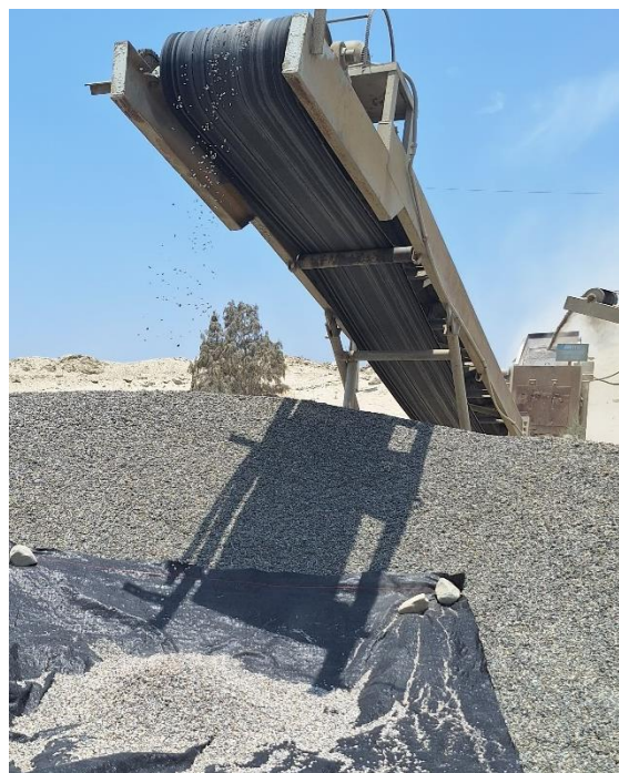
Fig. 47. Obtención de agregado reciclado por tamaños de \frac{3}{4} , \frac{1}{2} , mixto y arena.
