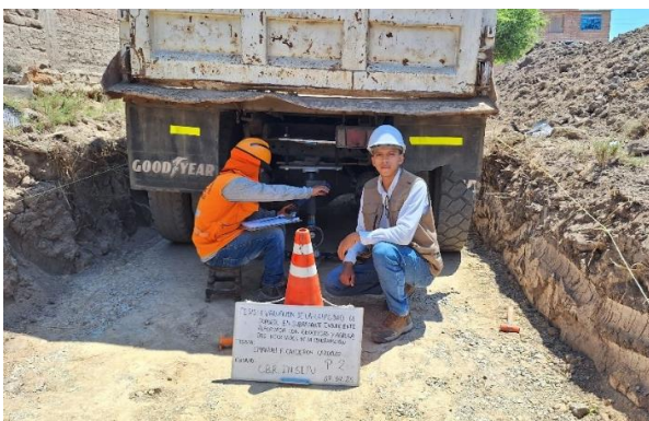
Fig. 109. CBR in situ en segmento conformado por afirmado.
