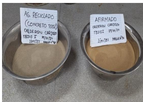
Fig. 62. Muestras de AR y AF pasadas por el tamiz N°10.
