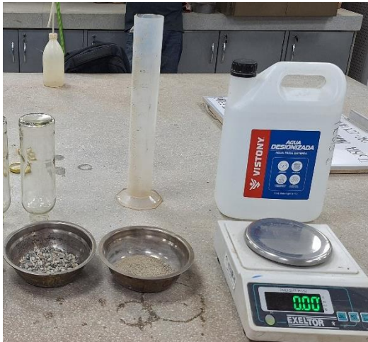
Fig. 50. Muestra retenida y pasante del Tamiz N° 10.
