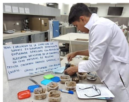
Fig. 63. Combinaciones de AR y AF para aplicarlas en la Copa de Casagrande.
