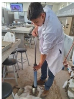
Fig. 31. Compactación de la muestra.
