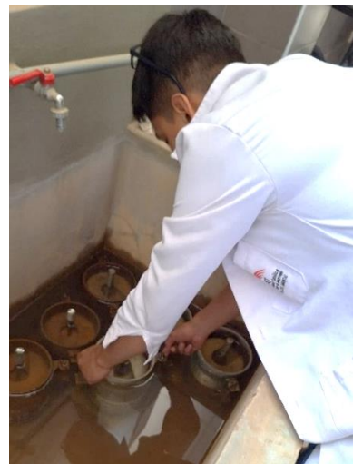
Fig. 36. Inmersión de los moldes CBR.
