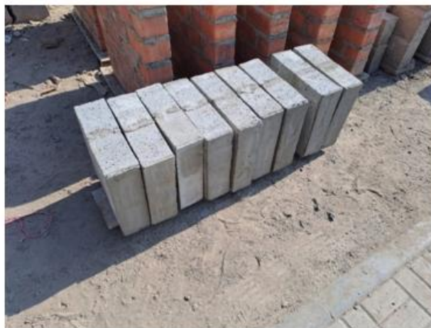
Imagen 14: Refrendado de unidades con yeso-cemento para ensayo de prismas
