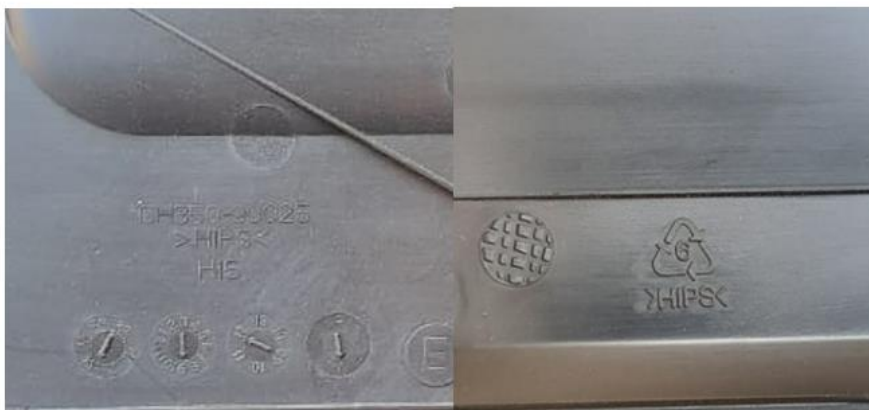
Imagen 19: Identificador de plástico HIPS
