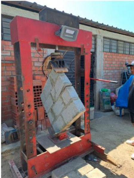
Imagen 28: Falla vertical en la diagonal. Murete 10% de reemplazo
