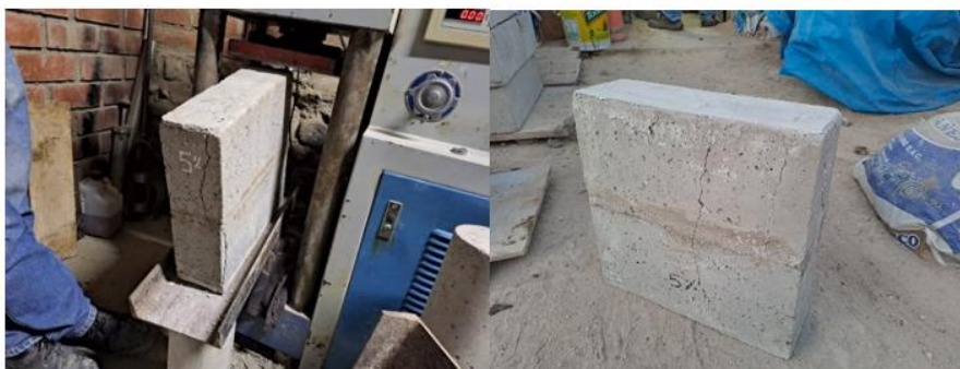
Imagen 25 Fallas por compresión en prisma con 5% de reemplazo
