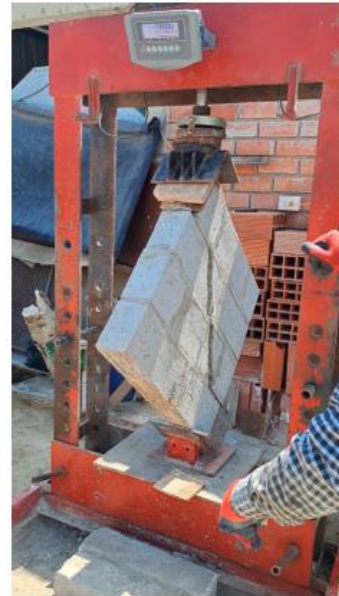
Imagen 30: Falla vertical en la diagonal. Murete 15% de reemplazo
