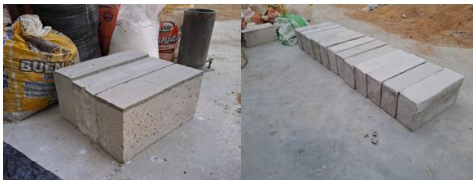
Imagen 10 Refrendado de bloques de concreto con yeso-cemento
