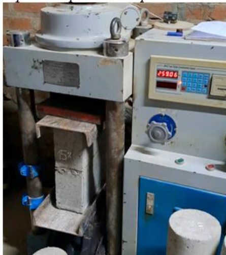
Imagen 27. Fallas por compresión en prisma con 15% de reemplazo
