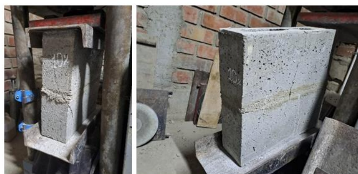
Imagen 26: Fallas por compresión en prisma con 10% de reemplazo
