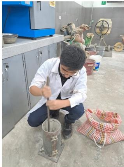
Imagen 4 Ensayo de Peso Unitario Compactado del agregado grueso
