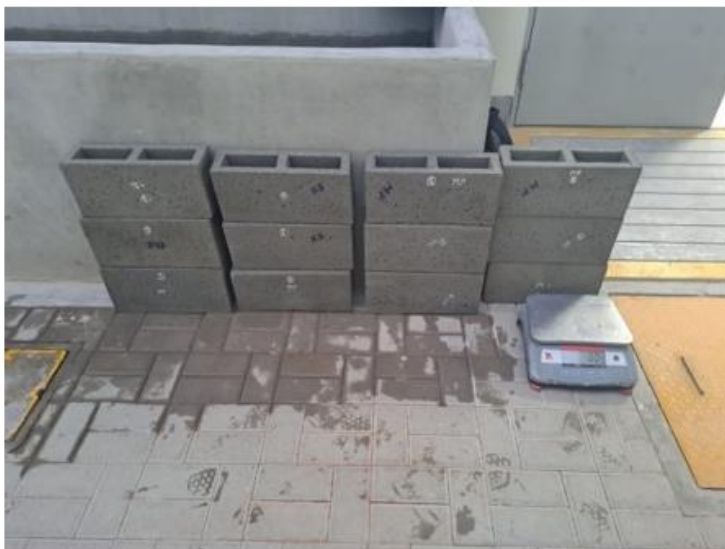
Imagen 8: Bloques de concreto saturados para ensayo de absorción
