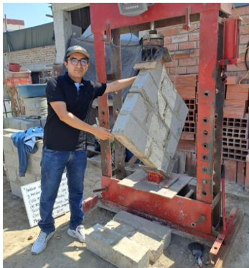
Imagen 18: Ensayo de resistencia a compresión en muretes
