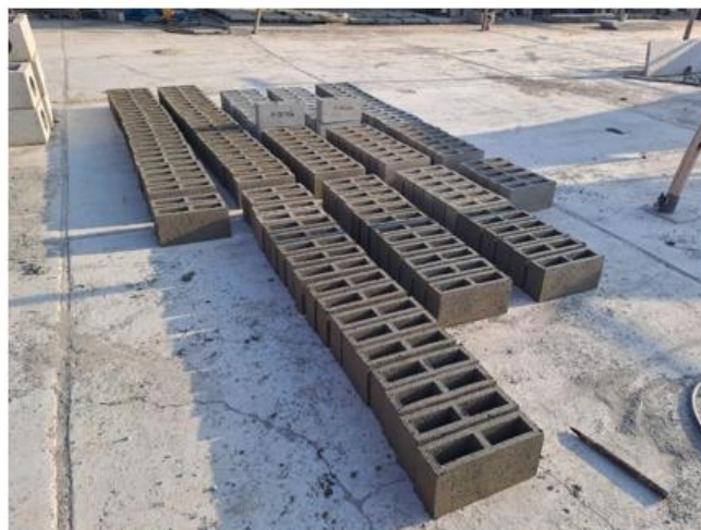
Imagen 23 Bloques de concreto elaborados con diferentes porcentajes
