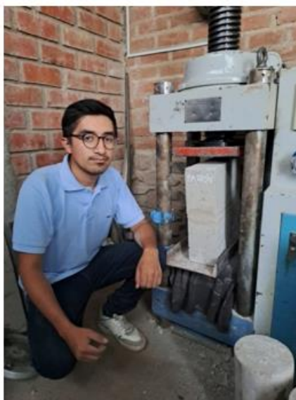
Imagen 15: Ensayo de resistencia en prismas de albañilería
