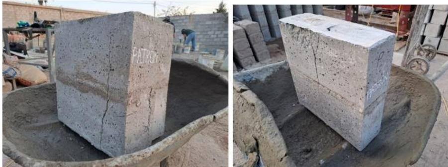
Imagen 24: Fallas por compresión en prisma patrón
