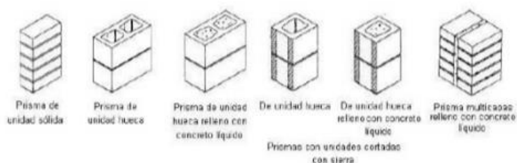
Imagen 12: Construcción de prismas de albañilería
