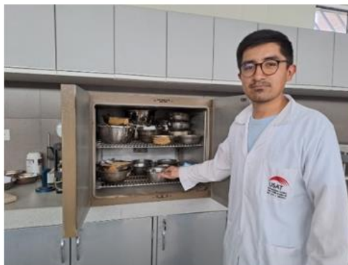
Imagen 3 Colocación de muestras de agregados al horno
