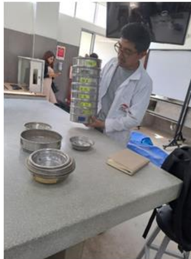
Imagen 1: Ensayo de granulometría de agregado fino
