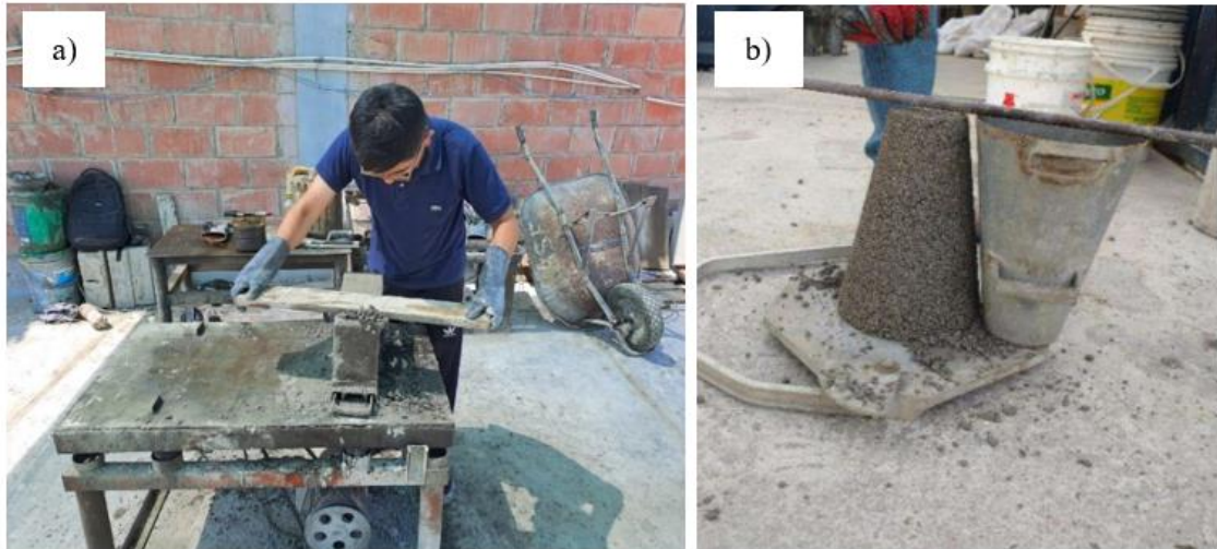
Imagen 21: Elaboración de bloques. a) uso de mesa vibradora b) verificación de slump 0''
