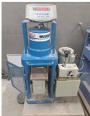
Imagen 11 Ensayo de resistencia a la compresión de bloques de concreto
