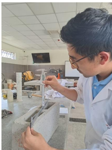
Imagen 1: Ensayo de alabeo con vernier digital
