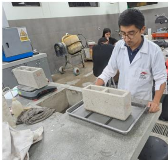
Imagen 9 Ensayo de succión en bloques de concreto
