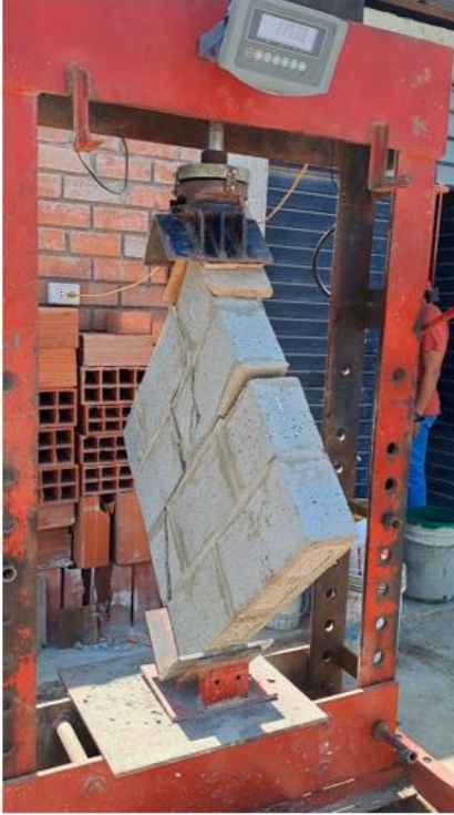
Imagen 28: Falla vertical en la diagonal. Murete 10% de reemplazo
