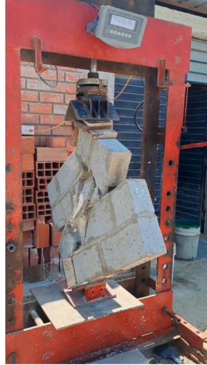
Imagen 30: Falla vertical en la diagonal. Murete 15% de reemplazo
