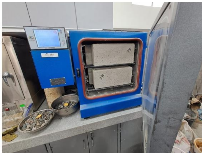
Imagen 7: Colocación de bloques de concreto al horno
