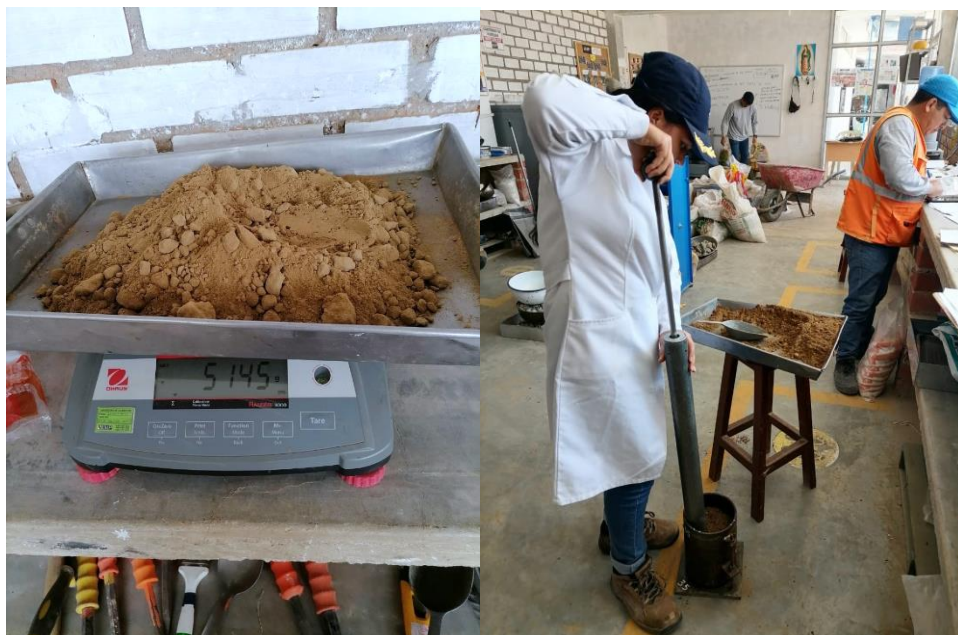
Figura 11. Pesado de los materiales en estado natural y realización del Proctor y CBR
