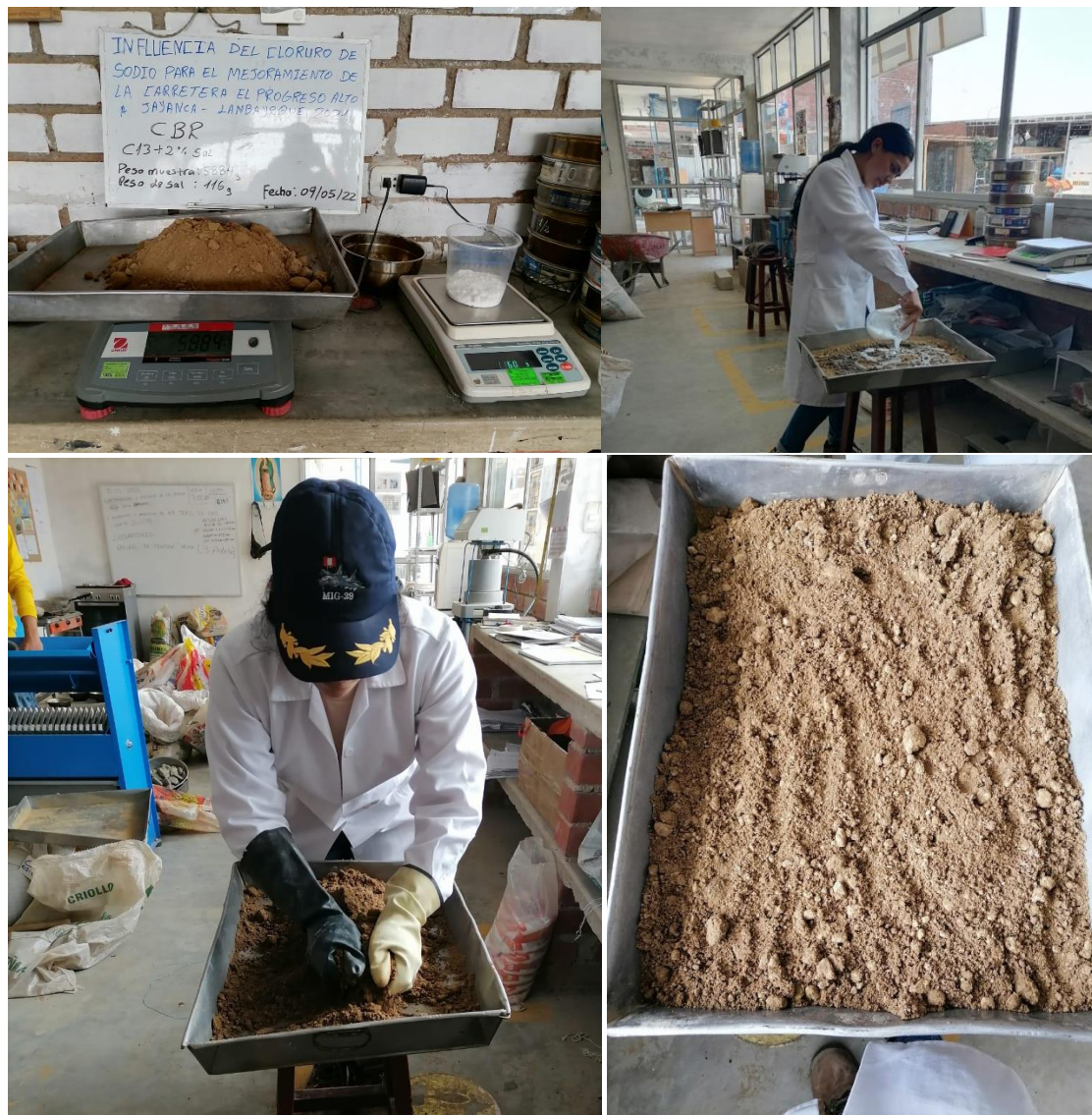
Figura 12. Realización del mezclado de la salmuera con la muestra para el Proctor y CBR.
