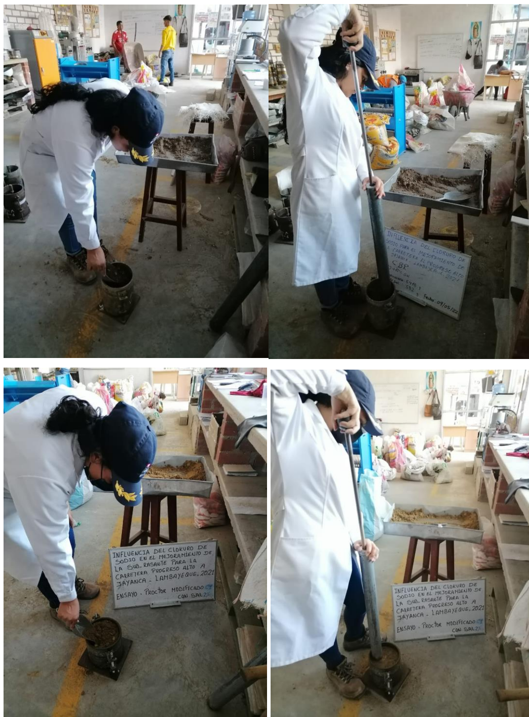
Figura 13. Realización del Proctor y CBR con la adicción de sal
