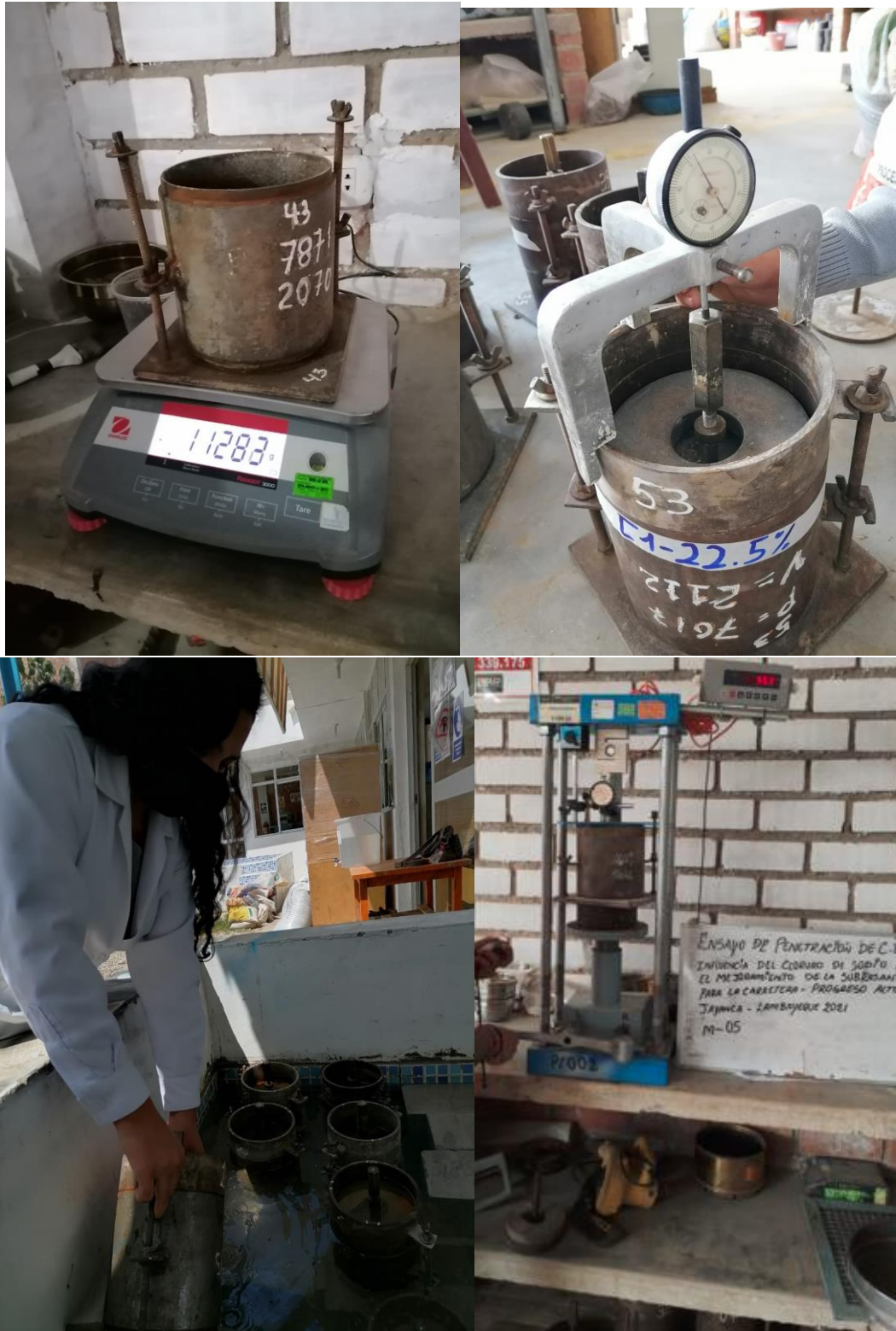
Figura 14. Elaboración del valor de soporte (CBR)
