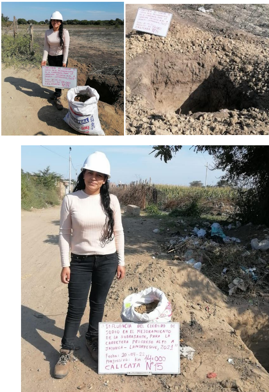
Figura 4. Realización de calicatas y obtención de muestra
