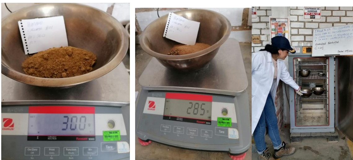
Figura 7. Pesado y colocación de las muestras al horno para la realización del ensayo de contenido de humedad.
