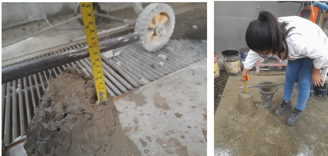
Ilustración 20: Slump del concreto.
