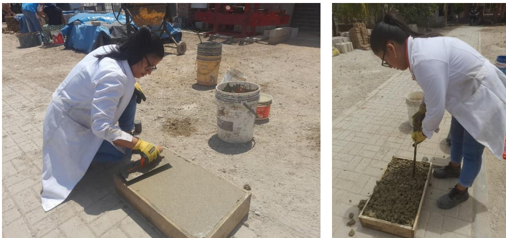
Ilustración 11: Ensayo de potencial de fisuración.
