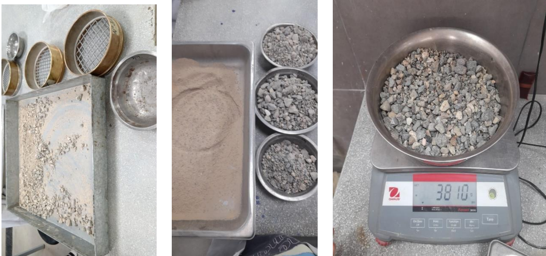
Ilustración 21: Material obtenido de la máquina de los ángeles
