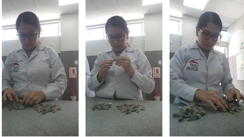
Ilustración 41: Selección del agregado según la cantidad de caras fracturadas
