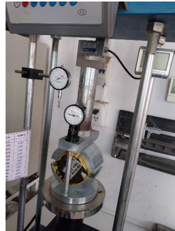
Ilustración 45: Extracción de baño maría y realización del ensayo
