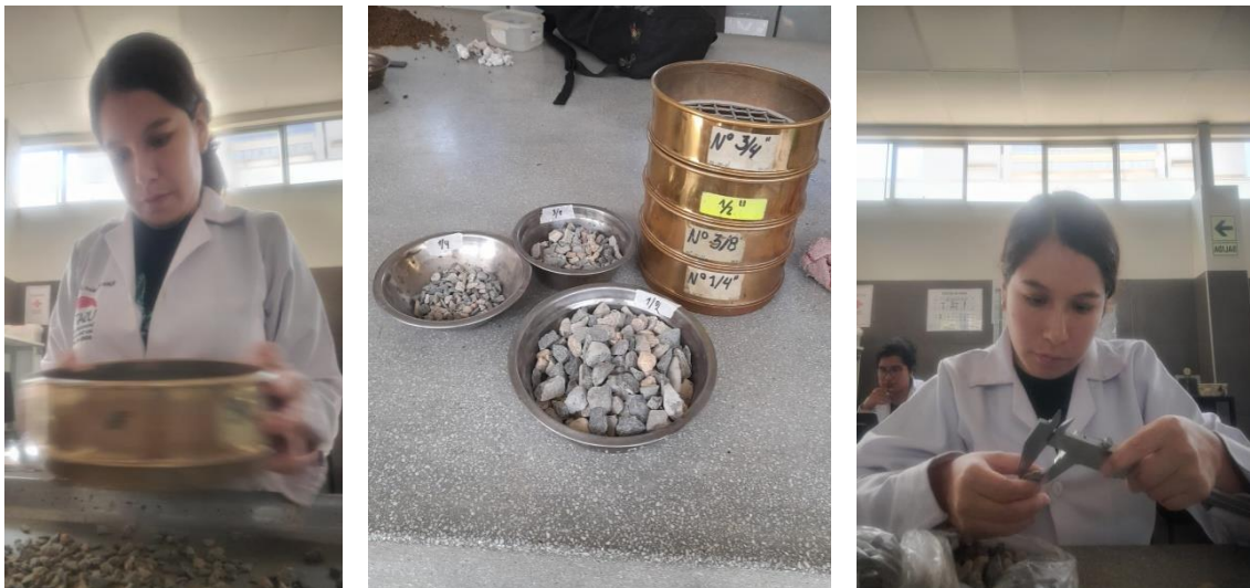
Ilustración 22: Elementos utilizados, preparación y medición de las partículas del agregado grueso
