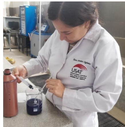
Ilustración 9: Realización del ensayo de azul de metileno
