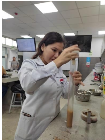
Ilustración 8: Realización del ensayo de equivalente de arena
