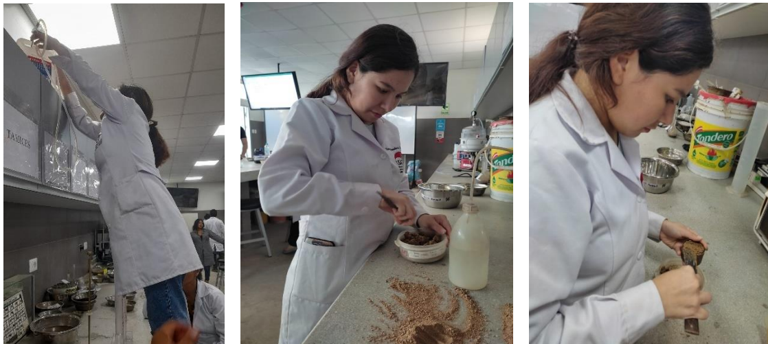
Ilustración 31: Preparando la solución y muestra para ensayo equivalente de arena
