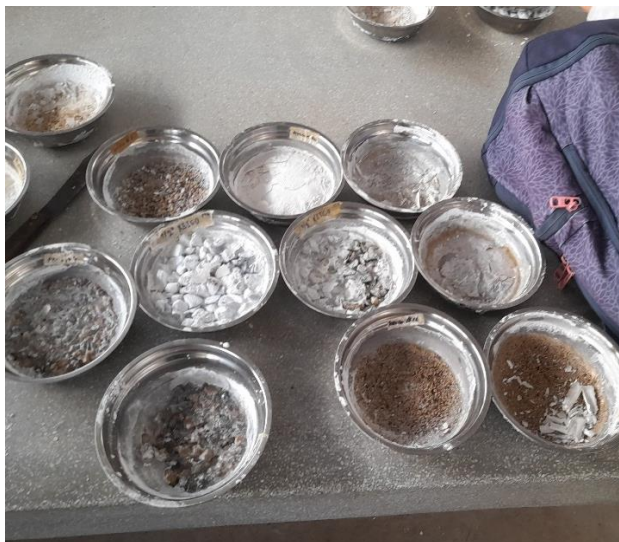
Ilustración 2: Realización del ensayo de durabilidad al sulfato magnesio
