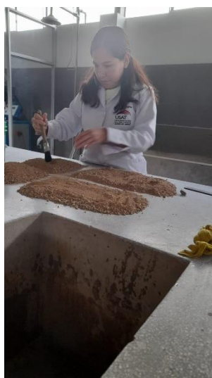
Ilustración 14: Realización del ensayo de análisis granulométrico
