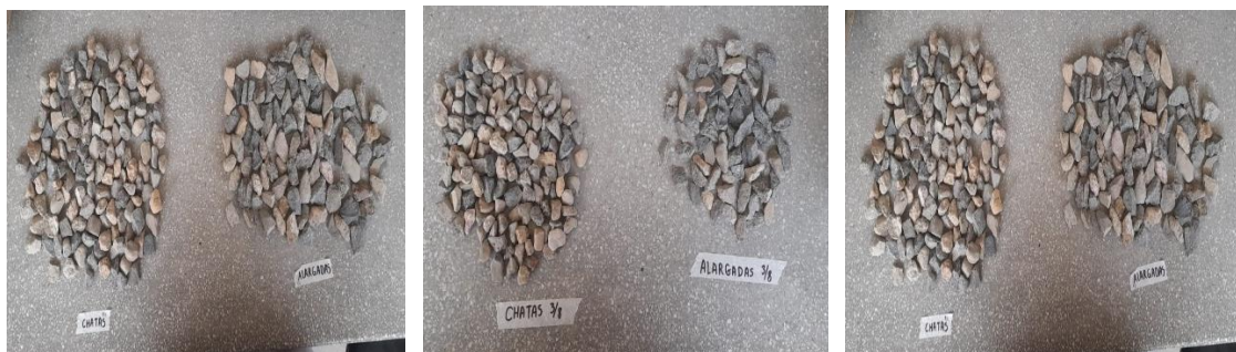
Ilustración 23: Clasificación de las partículas chatas y alargada
