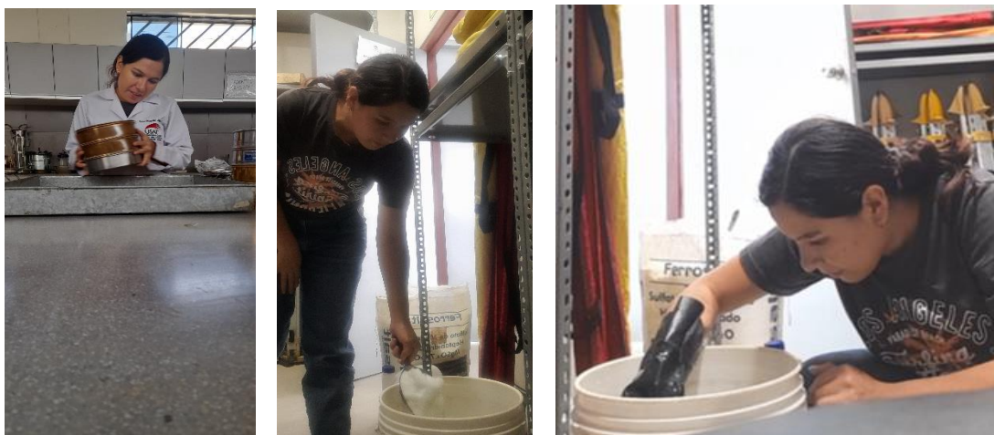
Ilustración 15: Preparación de la muestra y la solución con sulfato de magnesio
