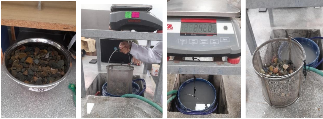
Ilustración 30: Preparación y pesado del agregado grueso para el ensayo de peso específico y absorción
