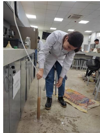
Ilustración 8: Realización del ensayo de equivalente de arena
