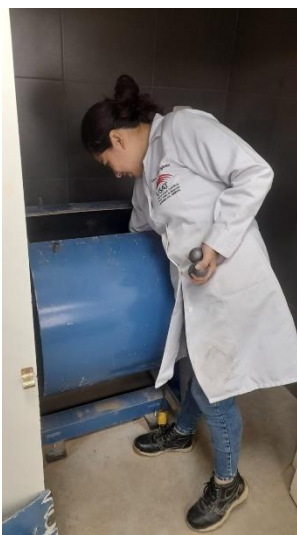
Ilustración 3: Realizando el ensayo de abrasión en la máquina de los ángeles
