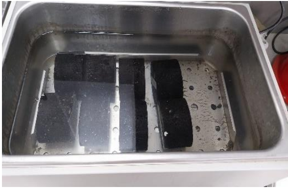
Ilustración 50: Briquetas en baño maría y rotura final
