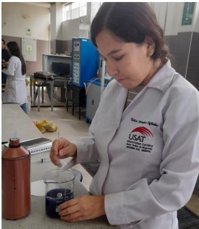
Ilustración 9: Realización del ensayo de azul de metileno
