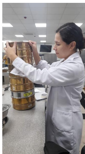
Ilustración 14: Realización del ensayo de análisis granulométrico
