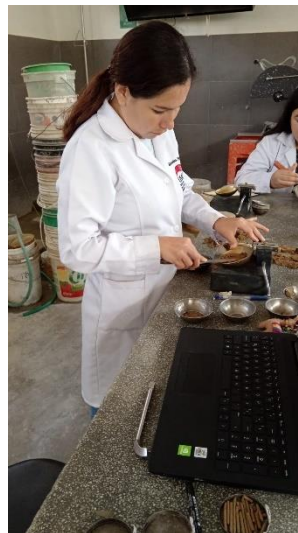
Ilustración 10: Realización del ensayo de límite líquido y límite plástico
