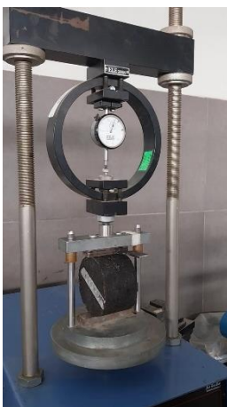
Ilustración 51: Rotura de briquetas en ensayo IDT
