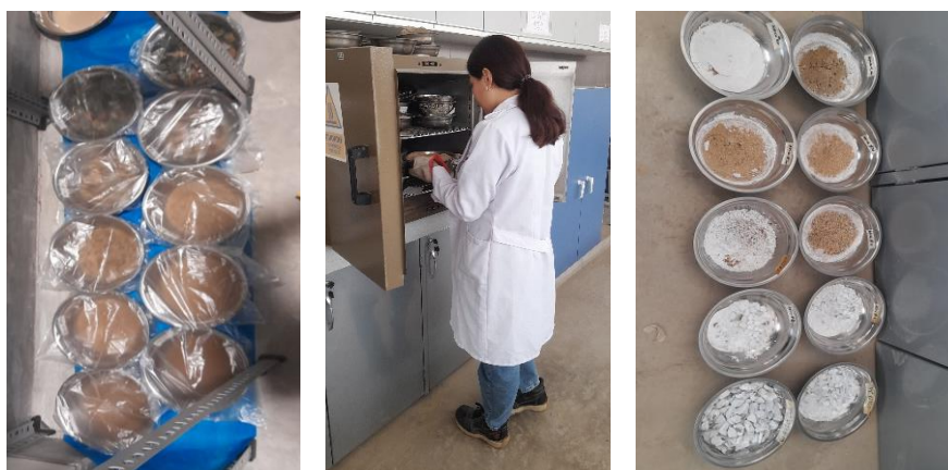
Ilustración 17: Muestras extraídas del horno después de su primer ciclo en sulfato de magnesio
