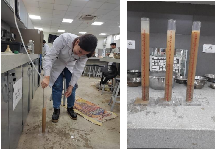
Ilustración 33: Lavado, llenado de probeta y muestras en reposo listas para medición Ensayo de azul de metileno - AASHTO TP 57
