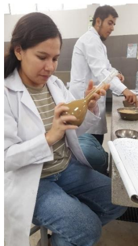
Ilustración 13: Realización del ensayo de peso específico y absorción del agregado fino
