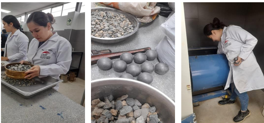
Ilustración 20: Preparación de la muestra y máquina de los ángeles para el ensayo de abrasión
