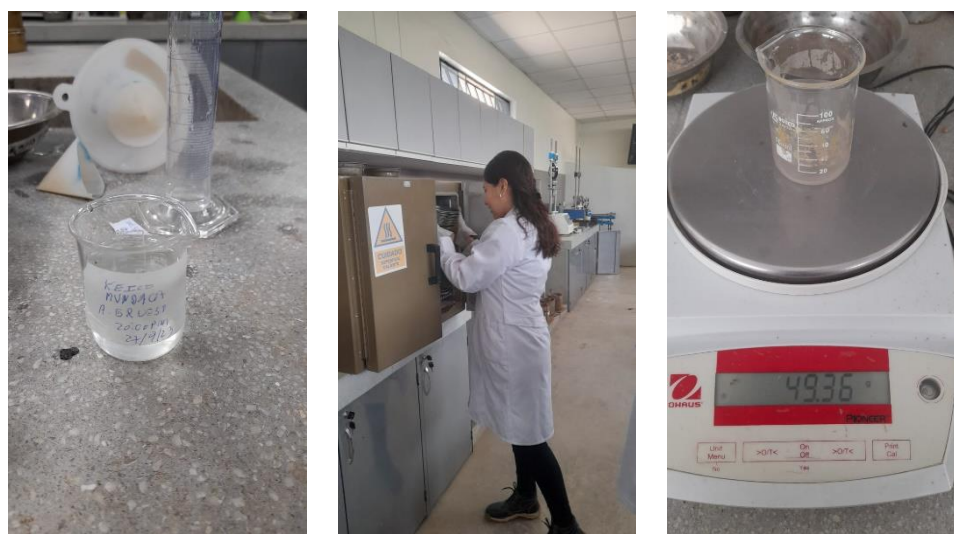
Ilustración 26: Muestra de agregado antes y después de sacado del horno
