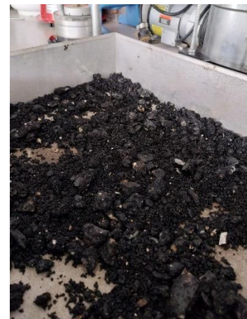
Ilustración 46: Calentar las briquetas y desmoronarla
