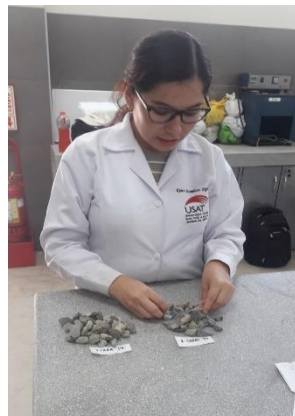
Ilustración 5: Realización del ensayo de caras fracturadas del agregado grueso
