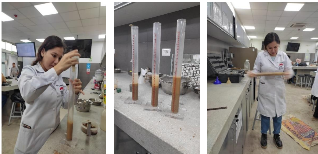
Ilustración 32: Vaciando el agregado a la probeta y agitación
