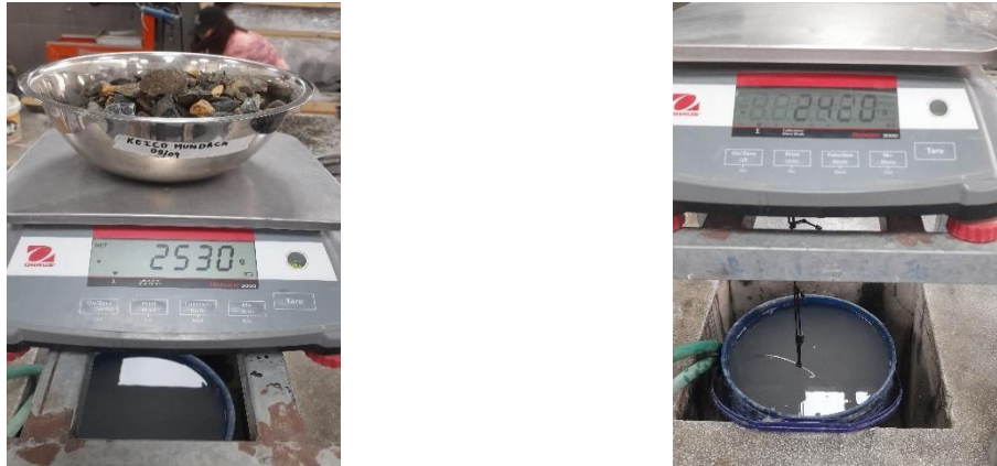
Ilustración 7: Realización del ensayo de peso específico y absorción del agregado grueso
