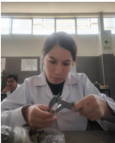
Ilustración 4: Realización del ensayo de partículas chatas y alargadas
