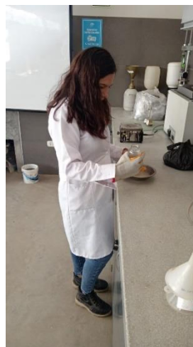
Ilustración 12: Realización del ensayo de sales solubles totales al agregado fino
