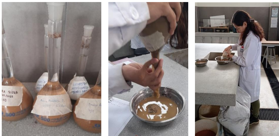
Ilustración 28: Vaciado y extracción de agua superficial de la muestra
