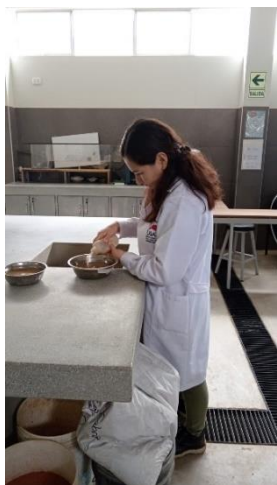
Ilustración 13: Realización del ensayo de peso específico y absorción del agregado fino
