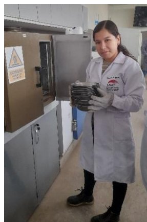
Ilustración 11: Realización del ensayo de durabilidad al sulfato magnesio del agregado fino
