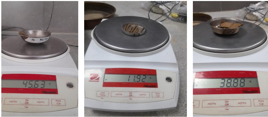
Ilustración 39: Muestras de límites líquido y plástico
