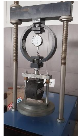
Ilustración 51: Rotura de briquetas en ensayo IDT
