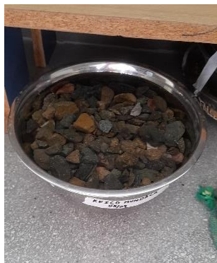
Ilustración 6: Realización del ensayo de sales solubles totales al agregado grueso
