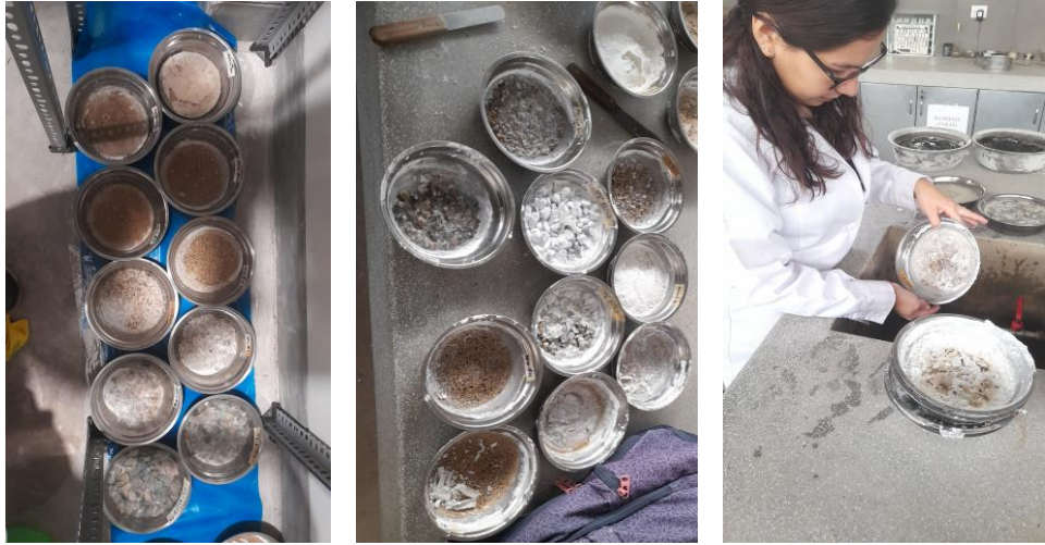
Ilustración 18: Muestras después de su último ciclo y remojo para diluir el sulfato de magnesio
