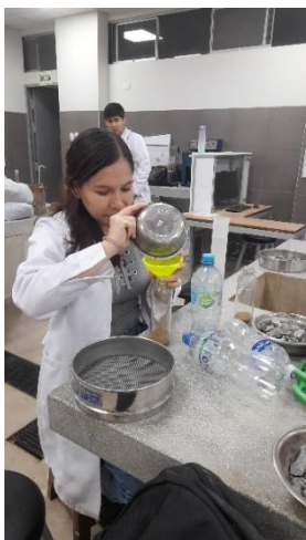
Ilustración 12: Realización del ensayo de sales solubles totales al agregado fino
