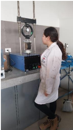
Ilustración 51: Rotura de briquetas en ensayo IDT
