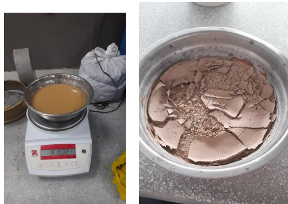
Ilustración 29: Muestra antes y después de estar 24 horas en el horno
