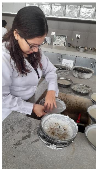
Ilustración 2: Realización del ensayo de durabilidad al sulfato magnesio
