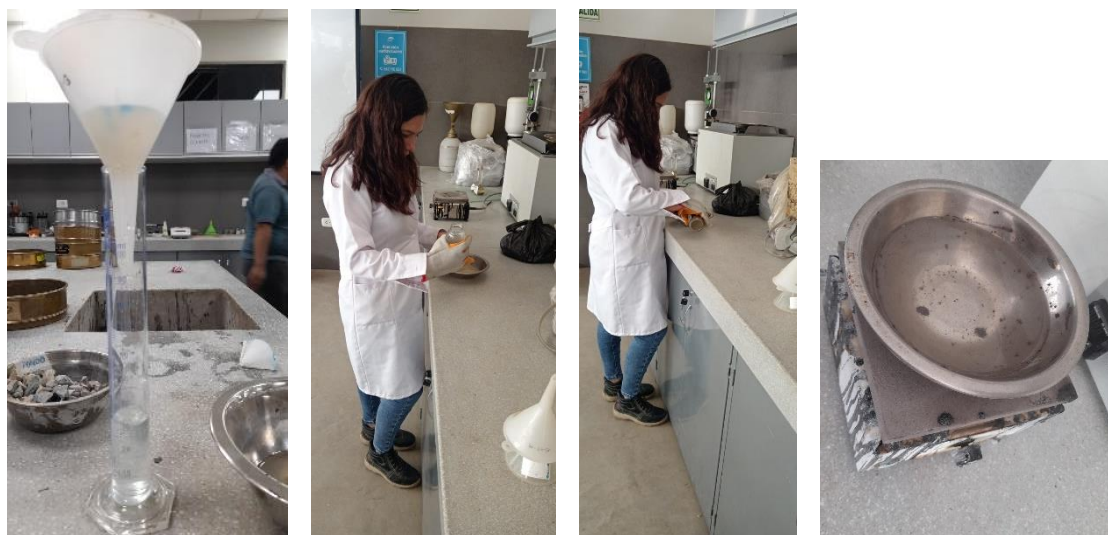
Ilustración 25: Vaciado, filtración y hervor de agua de agregados
