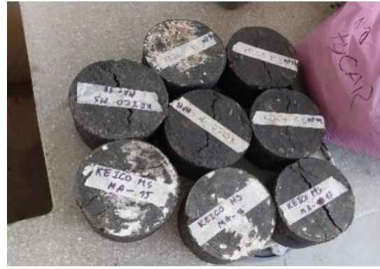
Ilustración 50: Briquetas en baño maría y rotura final
