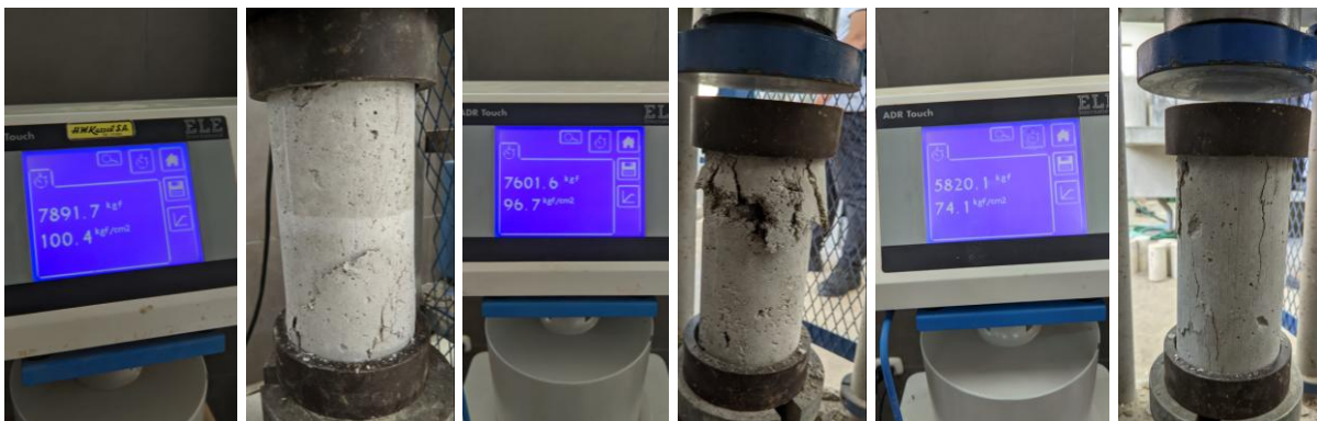
Anexo N° 38: Estructura interna del concreto con 15% de adición de vermiculita expandida
