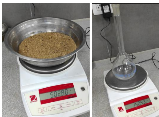
Figura 20: Peso de la muestra de AF y peso de la fiola.
