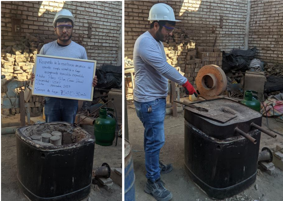
Anexo N° 41: Panel fotográfico de uso del horno artesanal para 30 minutos – 750°C
