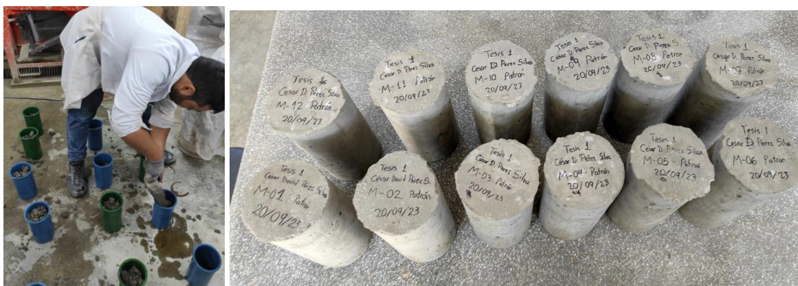
Figura 42: Procedimiento de elaboración de probetas cilíndricas de concreto.
