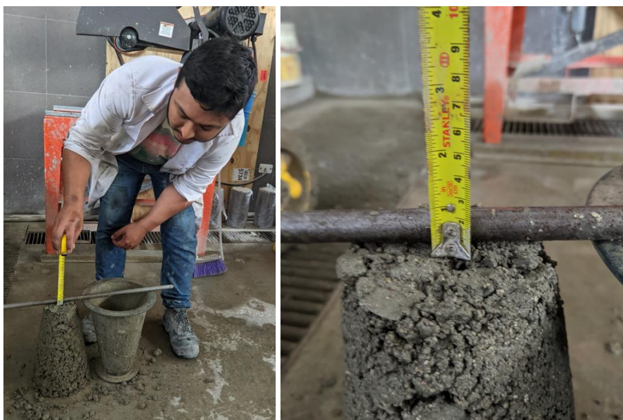
Figura 37: Medición del asentamiento para el concreto con 15% de VE.
