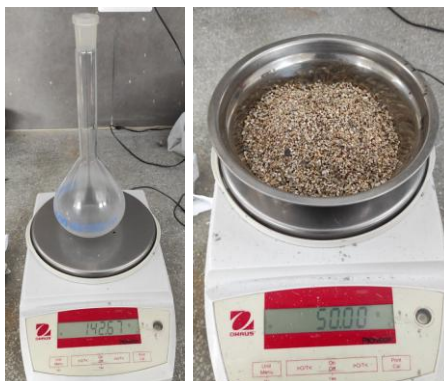
Figura 29: Peso de la fiola y peso inicial de la muestra de VE.
