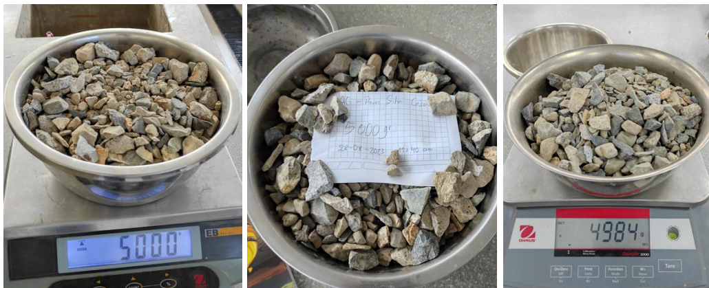
Figura 23: Peso de la muestra de AG antes y después de meterlo al horno.
