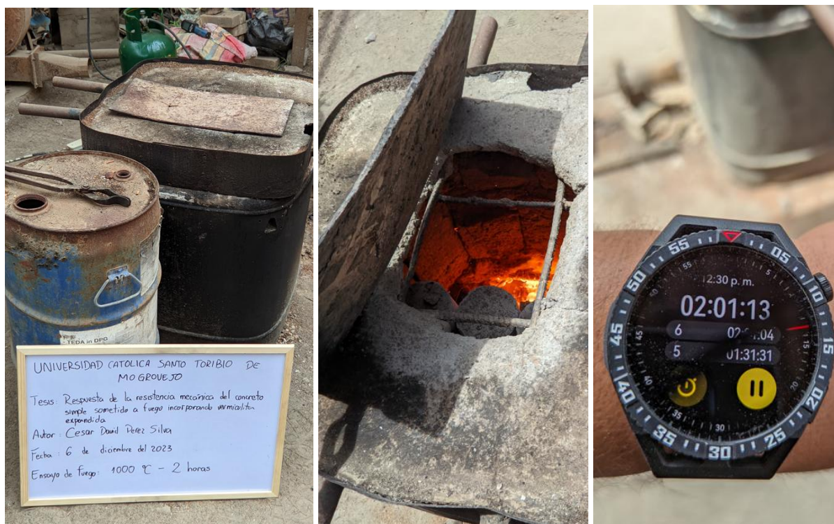
Anexo N° 43: Panel fotográfico de uso del horno artesanal para 2 horas – 1000°C
