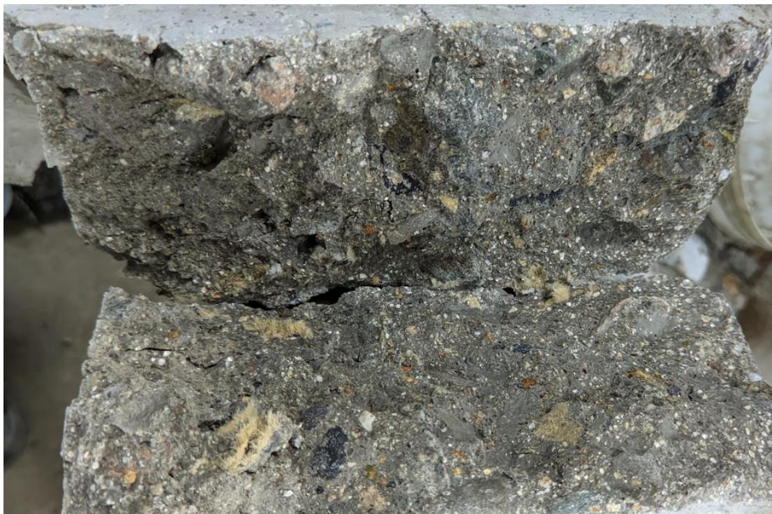
Anexo N° 36: Panel fotográfico de la estructura del concreto con 10% de adición de vermiculita expandida
