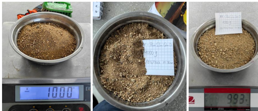
Figura 24: Peso de la muestra de AF antes y después de meterlo al horno.
