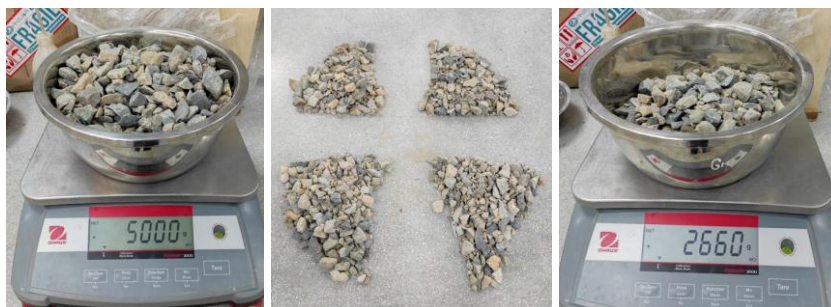
Figura 6: Pesado y cuarteo de la muestra de AG utilizada.
