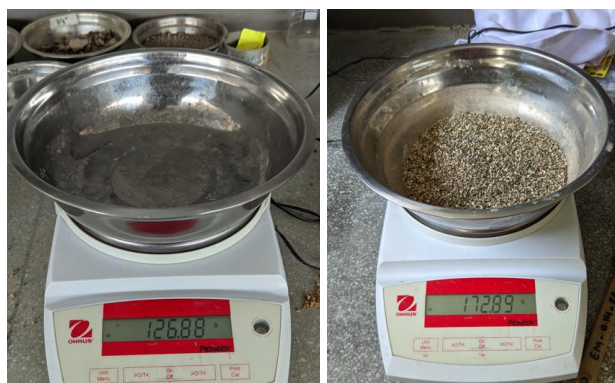
Figura 31: Peso del recipiente y peso de la muestra de VE después de meterlo al horno.
