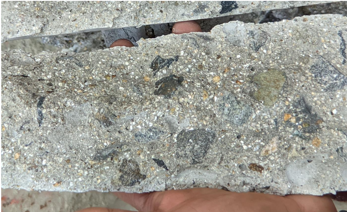
Anexo N° 38: Estructura interna del concreto con 15% de adición de vermiculita expandida
