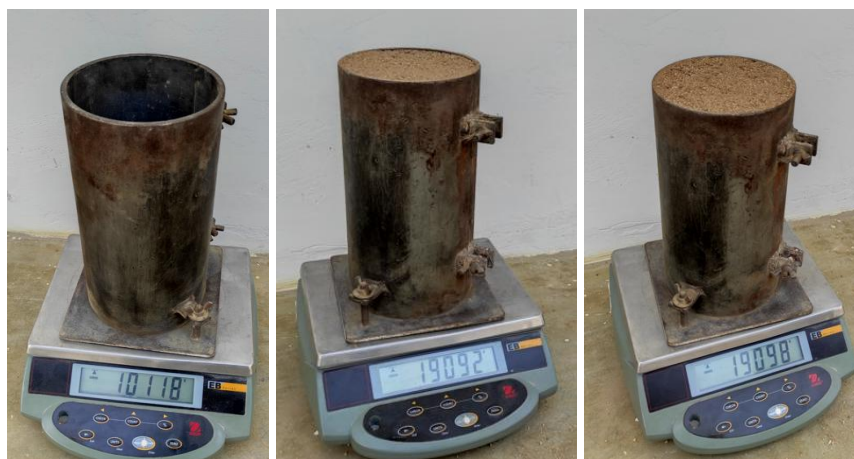
Figura 15: Peso del molde y del AF para el ensayo de peso unitario seco suelto.
