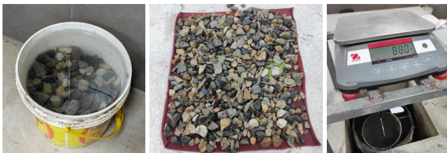
Figura 17: Muestra de AG saturada, muestra secada superficialmente y peso de la canastilla.
