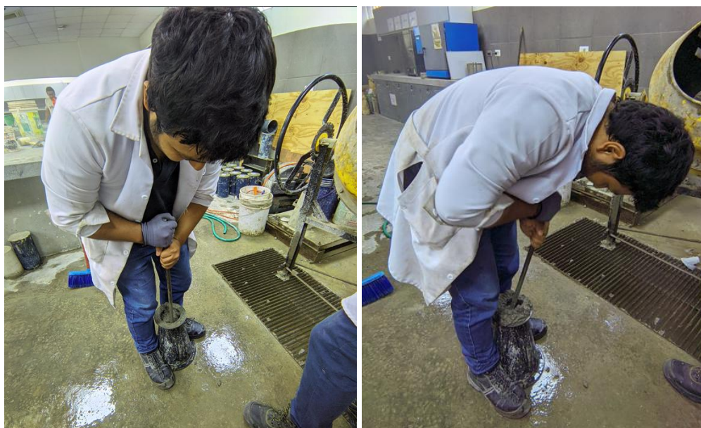
Figura 33: Procedimiento del ensayo de trabajabilidad (slump).
