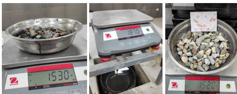
Figura 19: Pesos de la muestra 02 de AG para en ensayo de peso específico y absorción antes de sumergir, sumergido y secado al horno, respectivamente.
