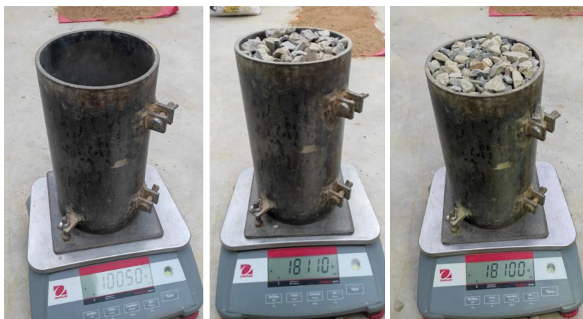
Figura 13: Peso del molde y del AG para el ensayo de peso unitario seco suelto.
