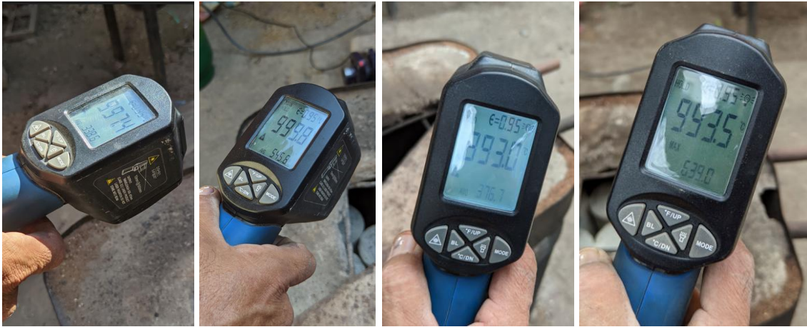
Anexo N° 40: Panel fotográfico de uso del horno artesanal para 15 minutos – 600°C
