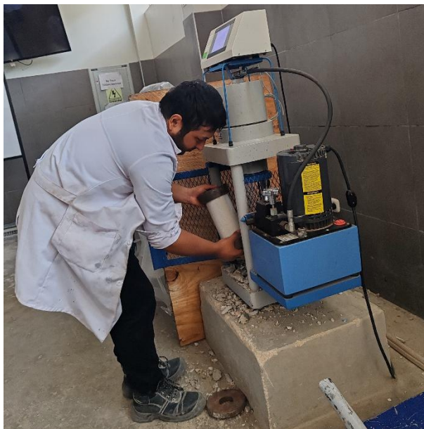
Figura 43: Colocación de muestra de concreto en la máquina para ensayo de resistencia a compresión.
