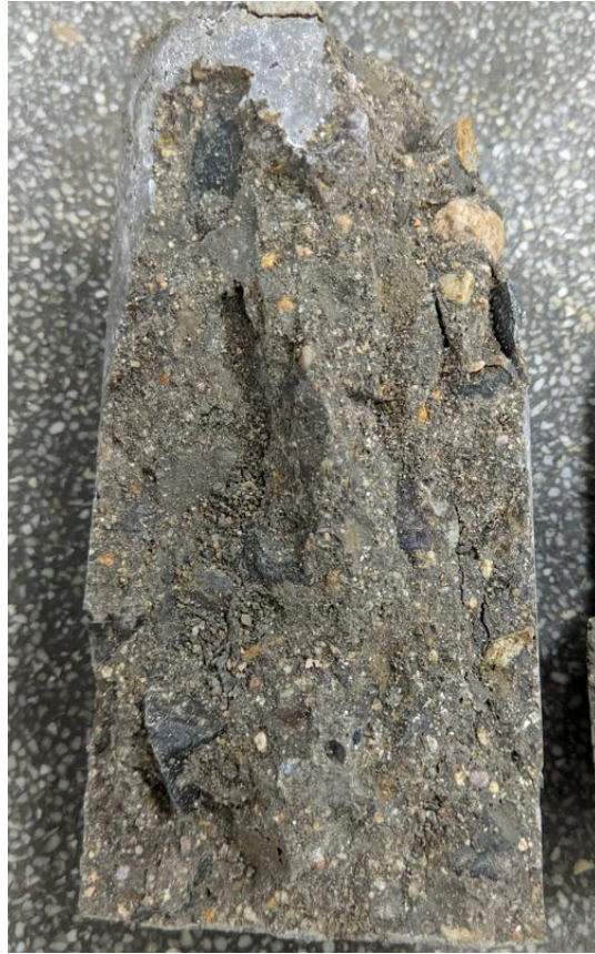
Anexo N° 34: Panel fotográfico de la estructura del concreto con 5% de adición de vermiculita expandida
