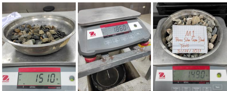
Figura 18: Pesos de la muestra 01 de AG para en ensayo de peso específico y absorción antes de sumergir, sumergido y secado al horno, respectivamente.
