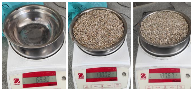
Figura 28: Peso del recipiente, peso de la muestra 02 de VE antes y después del horno, respectivamente.
