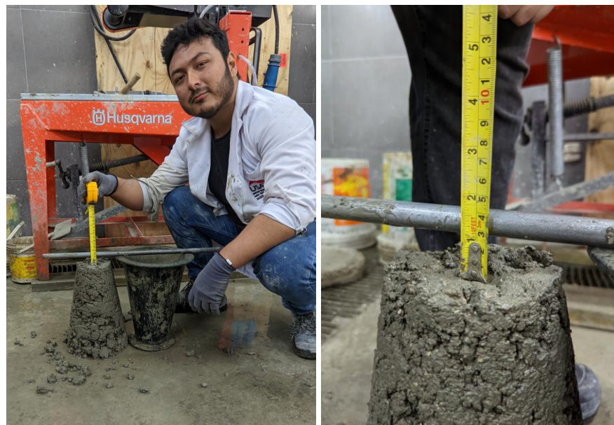
Figura 35: Medición del asentamiento para el concreto con 5% de VE.
