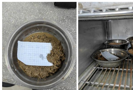
Figura 10: Muestra húmeda colocada en el horno
