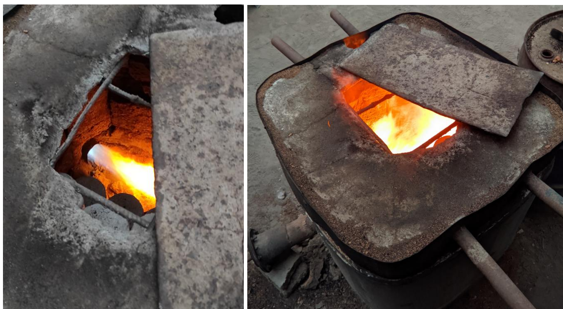
Figura 50: Vista del interior del horno artesanal en funcionamiento desde la escotilla por la que se tomaban las lecturas de temperatura.
