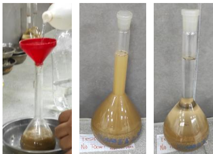
Figura 21: Introducción del agua y arena en la fiola, material dentro de la fiola y material después de 24 horas, respectivamente.
