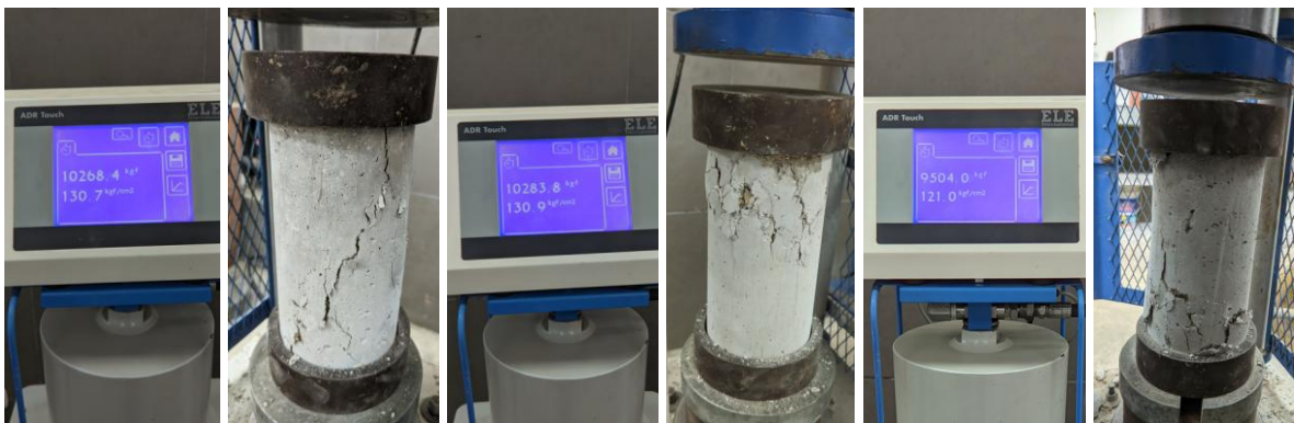
Anexo N° 36: Panel fotográfico de la estructura del concreto con 10% de adición de vermiculita expandida
