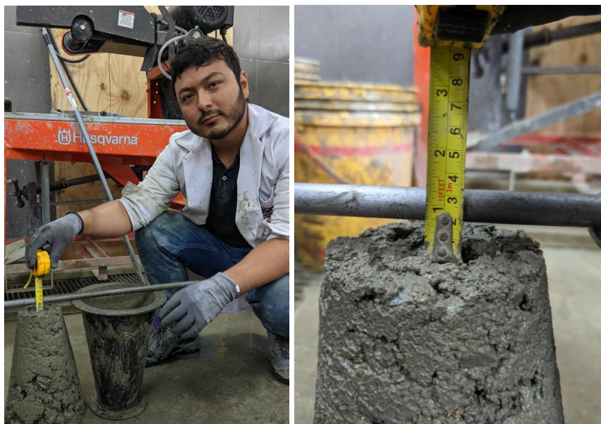
Figura 36: Medición del asentamiento para el concreto con 10% de VE.
