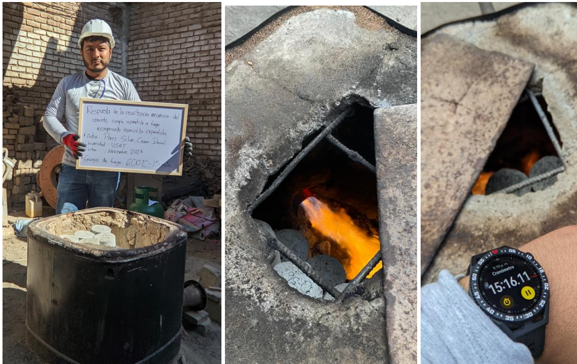
Anexo N° 40: Panel fotográfico de uso del horno artesanal para 15 minutos – 600°C
