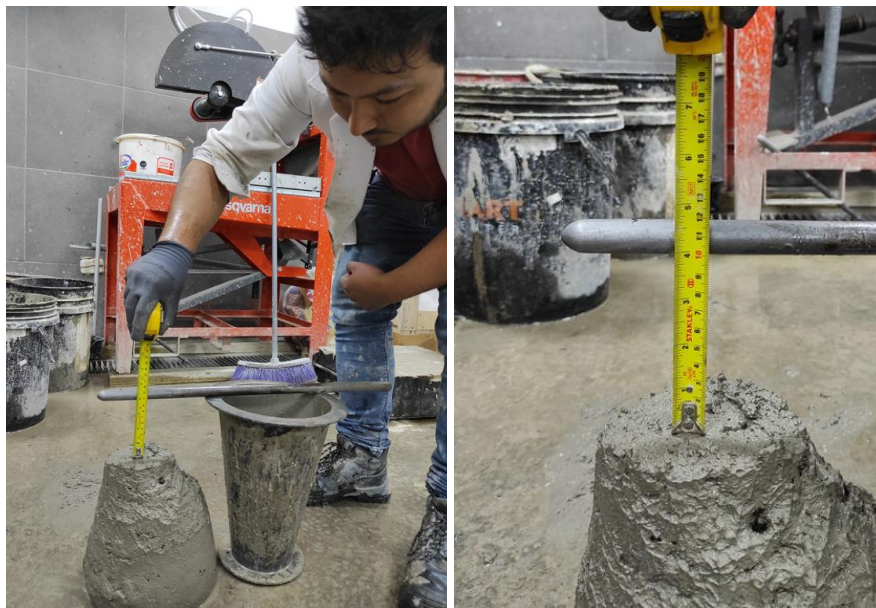
Figura 34: Medición del asentamiento para el concreto patrón.
