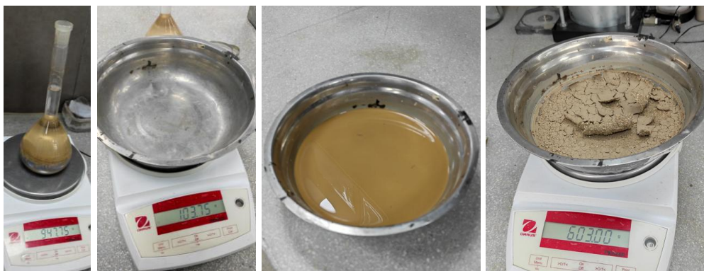
Figura 22: Introducción del agua y arena en la fiola, material dentro de la fiola y material después de 24 horas, respectivamente.
