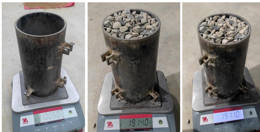
Figura 14: Peso del molde y del AG para el ensayo de peso unitario seco compactado.
