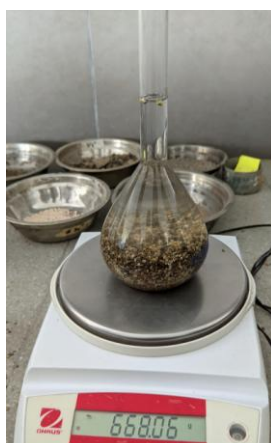
Figura 30: Peso de la muestra de VE + agua + fiola
