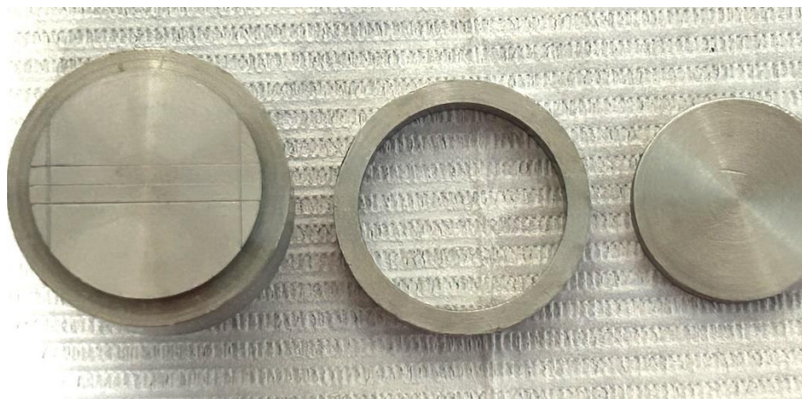
Figura 2: Dispositivo de acero inoxidable diseñado según especificaciones de ADA N°19
