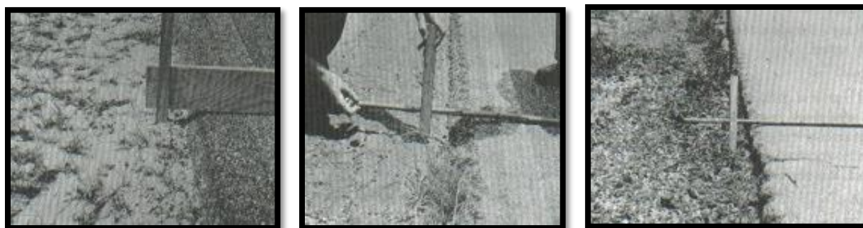
Ilustración 10. Desnivel Carril/Berma: L, M y H
