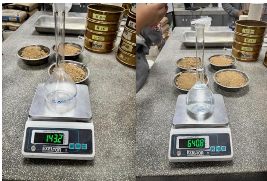
Fig. 21. Peso de la fiola sola y con agua
