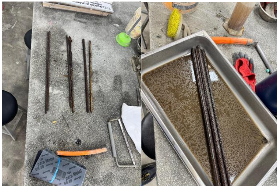
Fig. 40. Limpieza de los aceros corroídos
