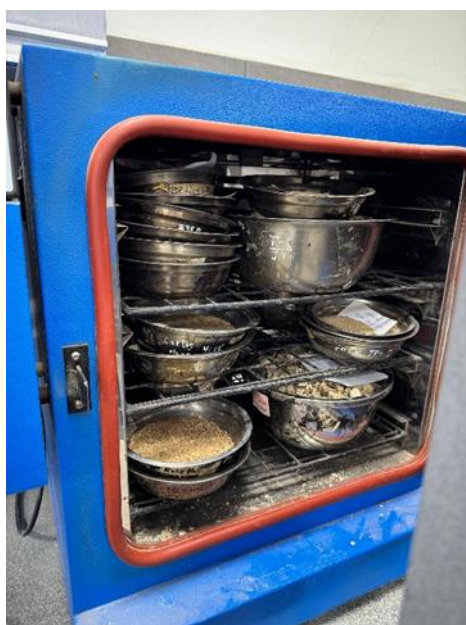
Fig. 18. Muestra puesta en horno
