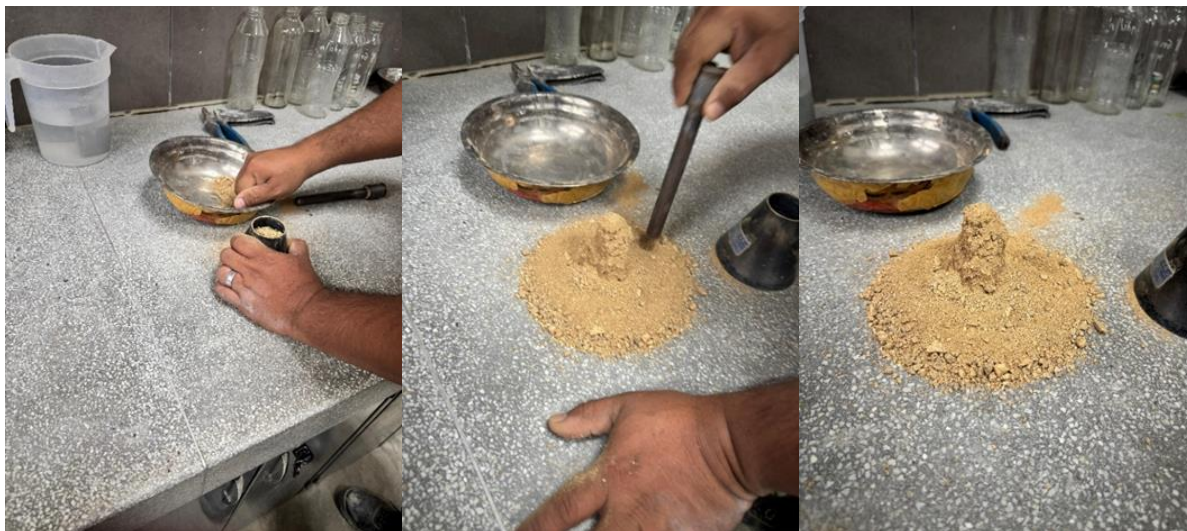
Fig. 20. Muestra puesta en el cono de absorción de arena
