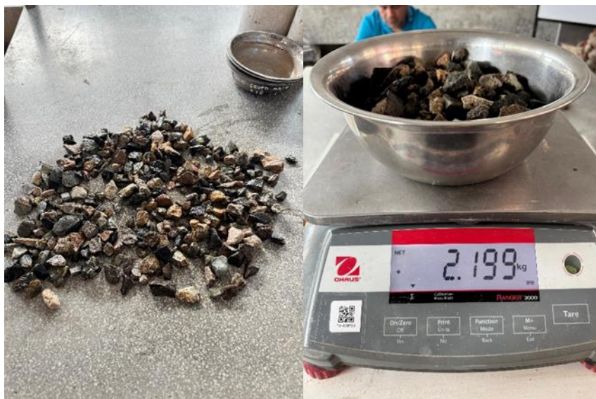
Fig. 16. Secado y pesado de la muestra
