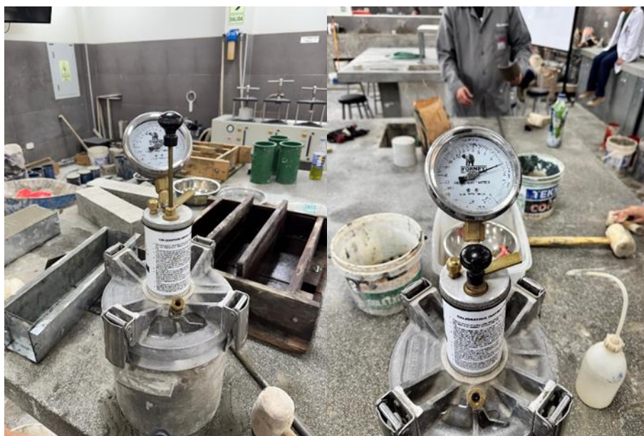
Fig. 30. Contenido de Aire en el Concreto
