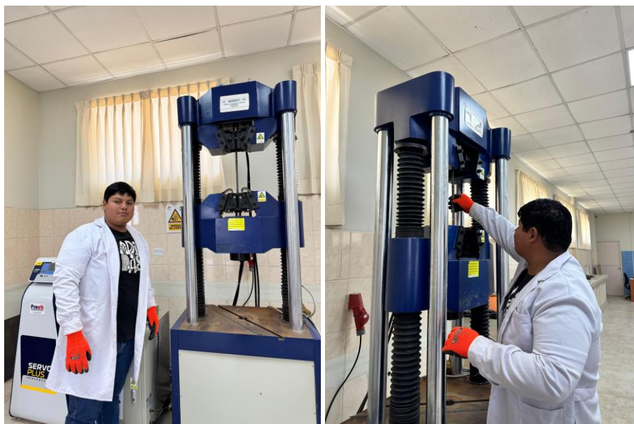
Fig. 47. Preparación y ejecución del ensayo a tracción del acero de refuerzo corroído.
