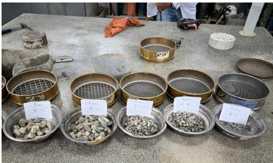
Fig. 9. Muestras retenidas de cada tamiz agregado grueso
