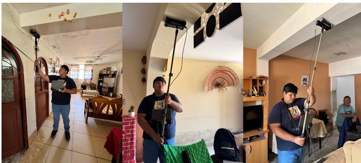
Fig. 37. Escaneo para determinar diámetros de aceros de las viviendas
