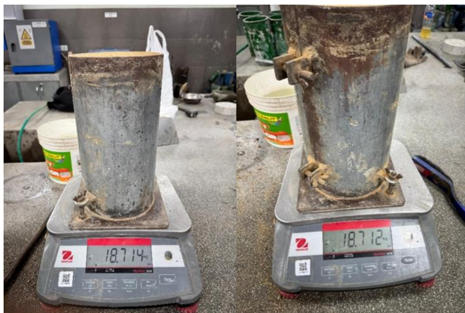
Fig. 11. Comparación de peso sueltos del agregado fino
