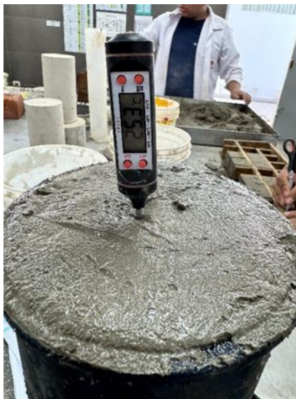
Fig. 31. Temperatura del concreto en estado fresco.
