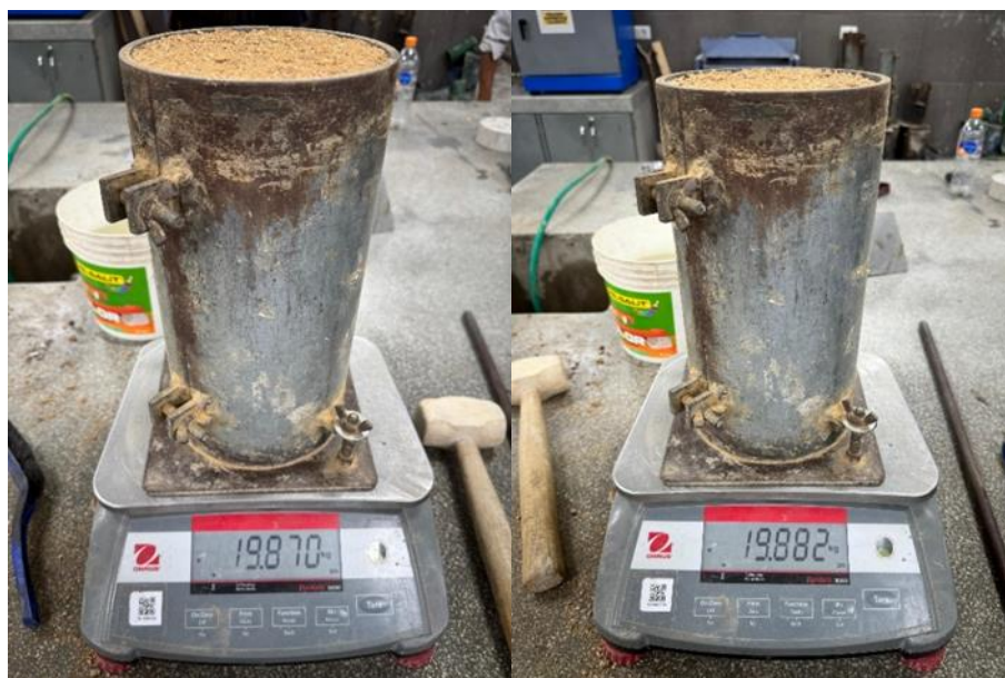
Fig. 13. Comparación de pesos compactados del agregado fino
