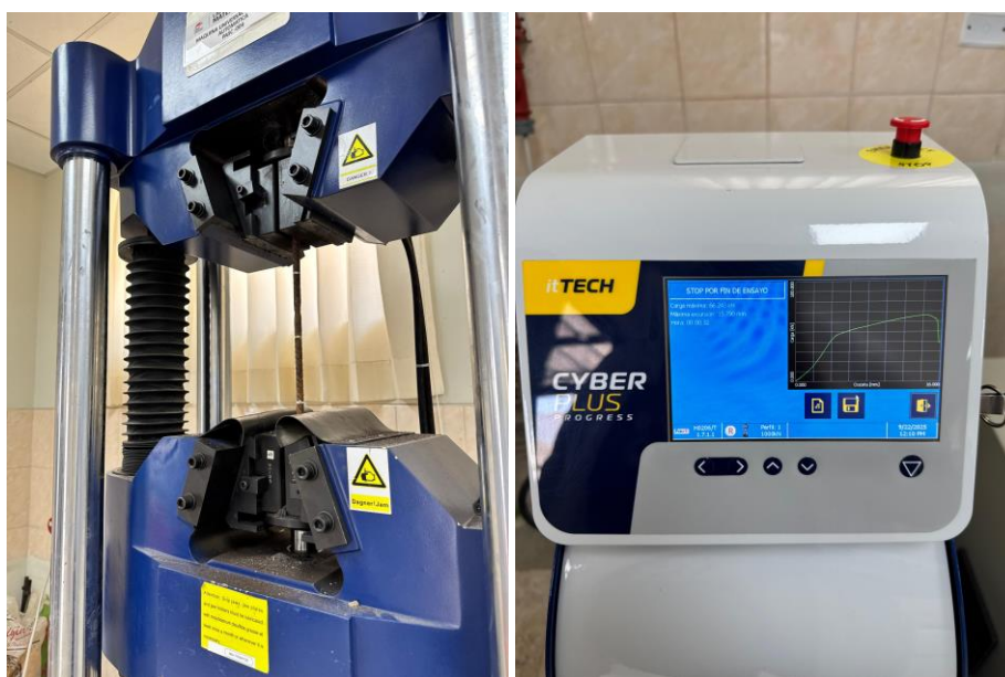
Fig. 48. Registro de resultados del ensayo a tracción del acero corroído.
