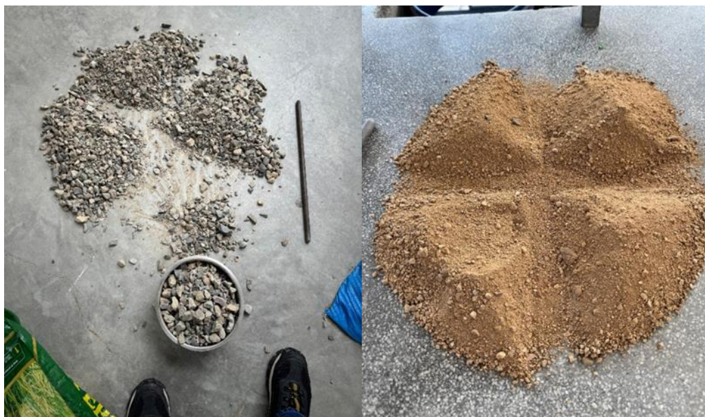
Fig. 6. Cuarteo de agregado fino y grueso.
