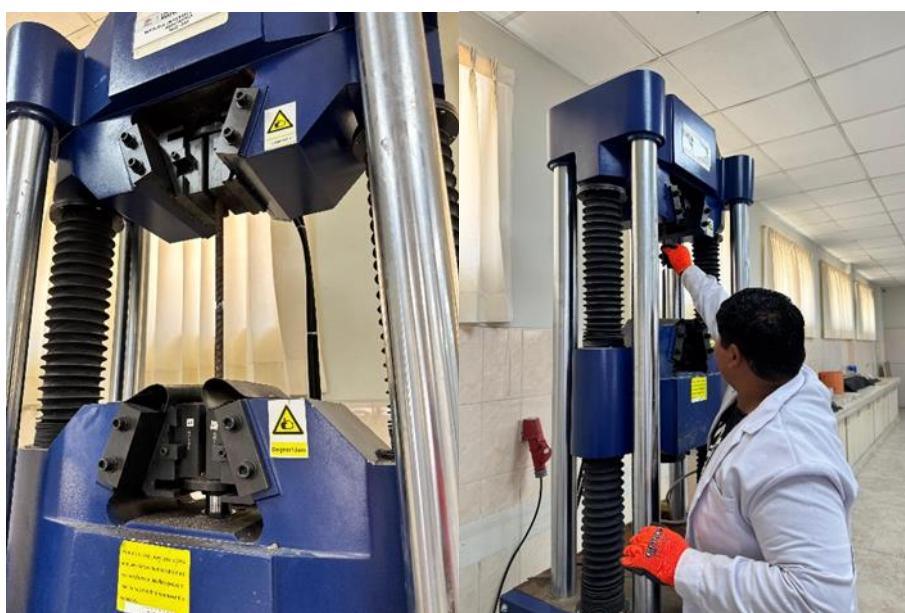
Fig. 43. Ensayo de tracción acero de viviendas.
