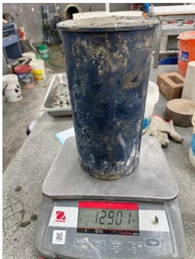
Fig. 32. Densidad del concreto
