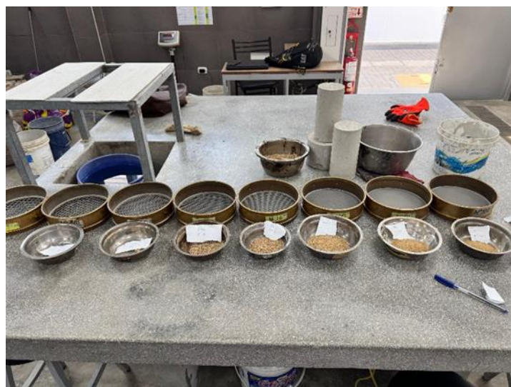
Fig. 8. Muestras retenidas de cada tamiz agregado fino
