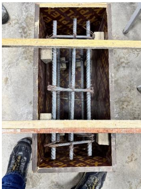
Fig. 28. Viga lista para llenado
