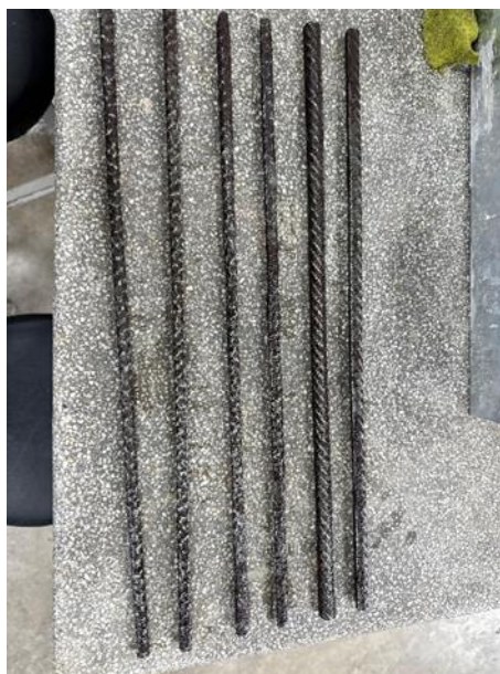
Fig. 41. Aceros después de su limpieza
