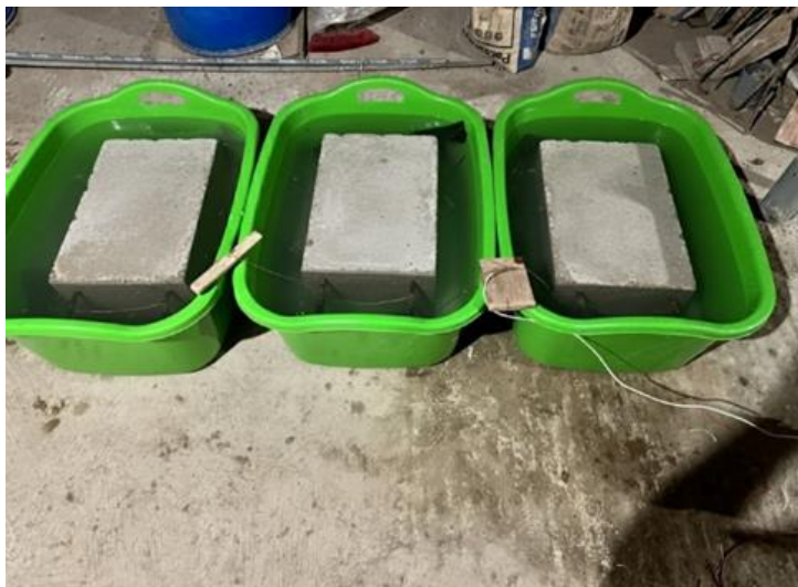
Fig. 44. Viga experimental sometida a corrosión
