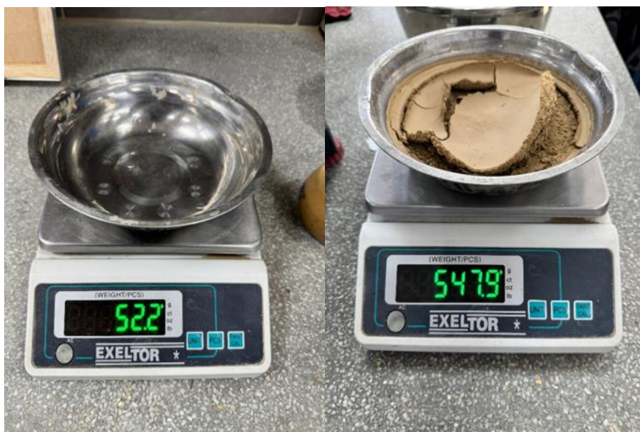
Fig. 25. Peso de tara y peso de tara más muestra seca
