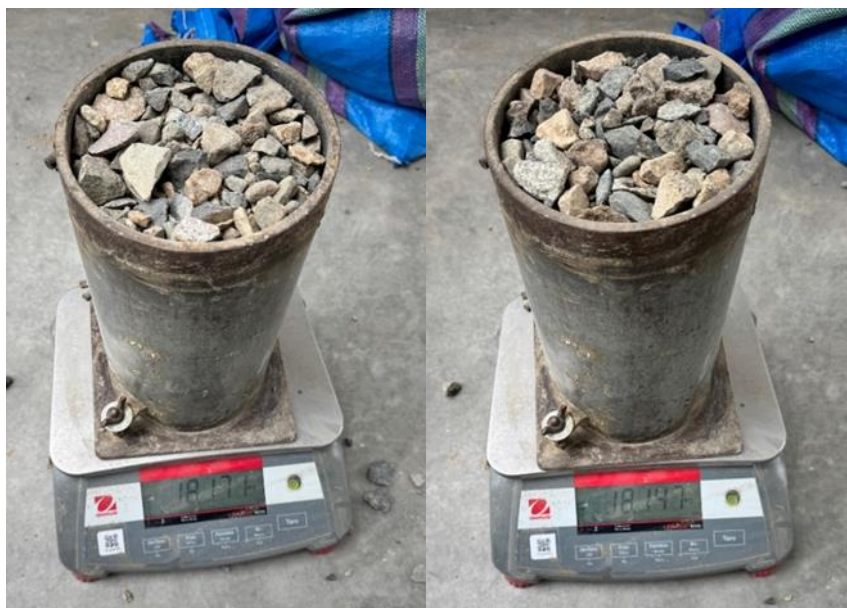
Fig. 12. Comparación de peso sueltos del agregado grueso
