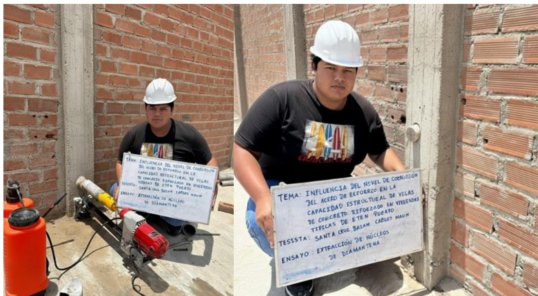
Fig. 39. Extracción de corazones de diamantina.
