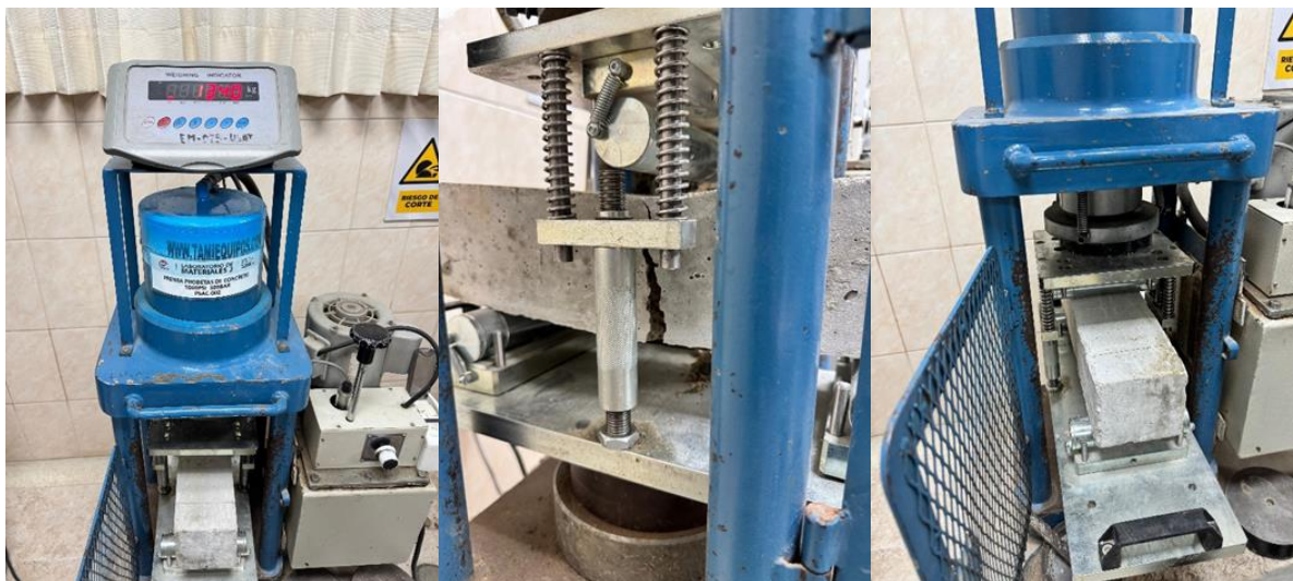
Fig. 36. Ensayo a Flexión de vigas
