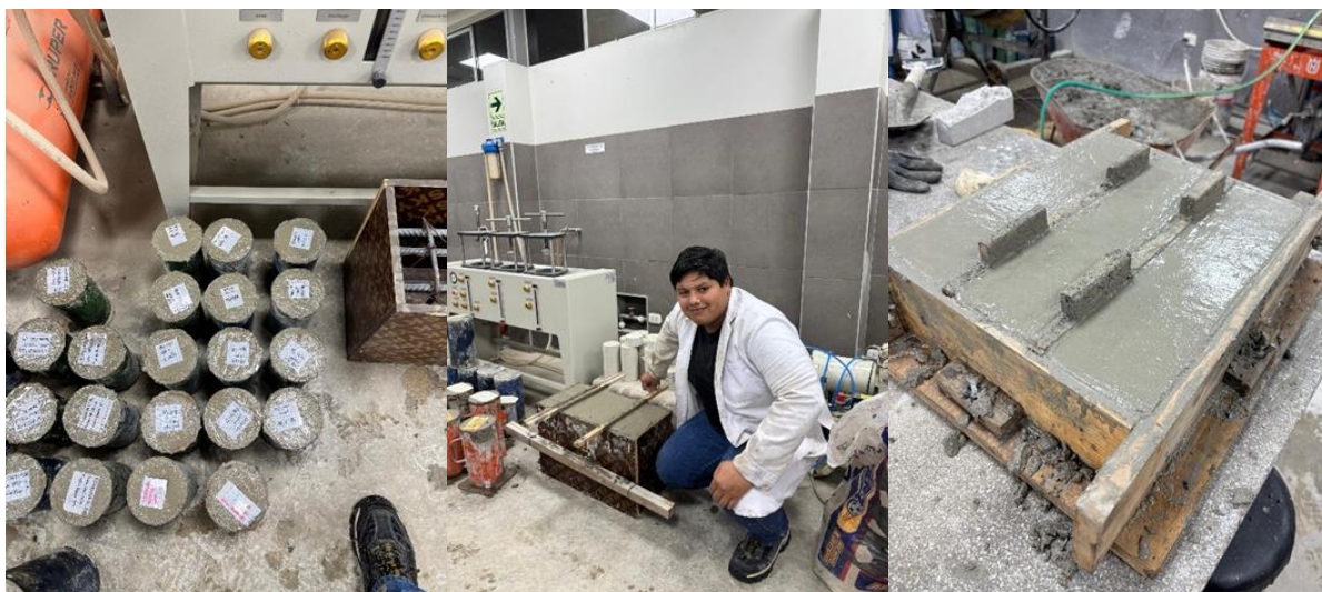
Fig. 33. Llenado de probetas y viga experimental
