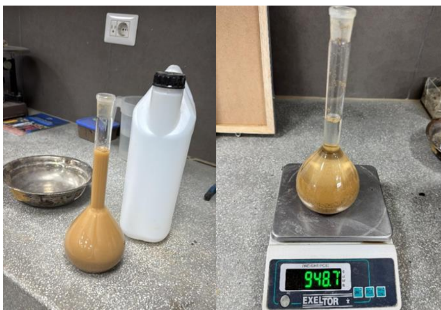
Fig. 23. Peso de la fiola con agua más agregado fino
