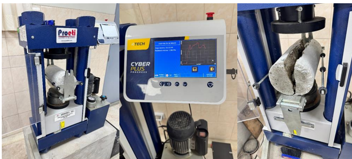
Fig. 35. Ensayo a Tracción en pruebas cilíndricas.
