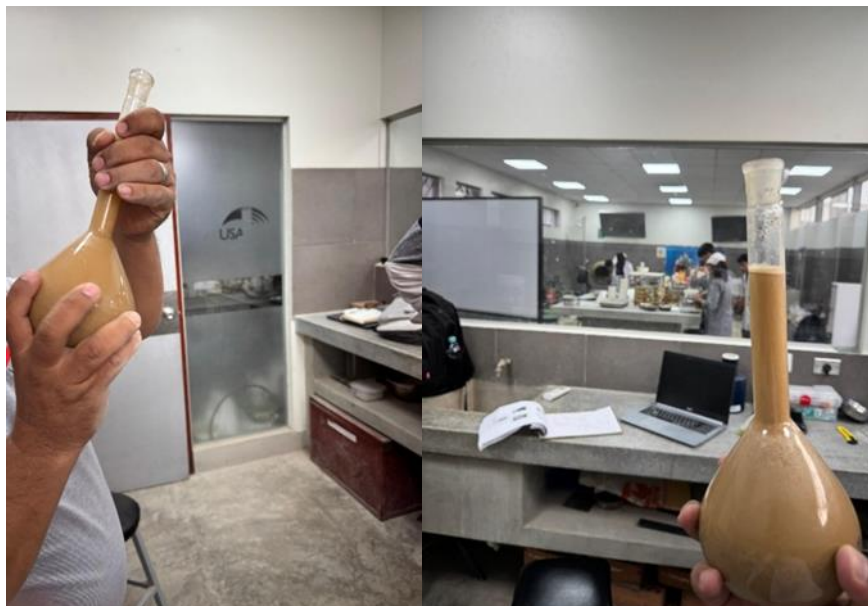
Fig. 22. Rodamiento manual de la fiola
