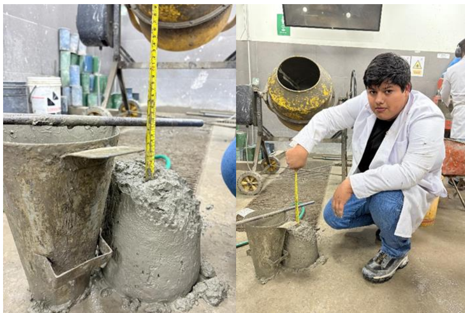
Fig. 29. Comprobación de slum de diseño
