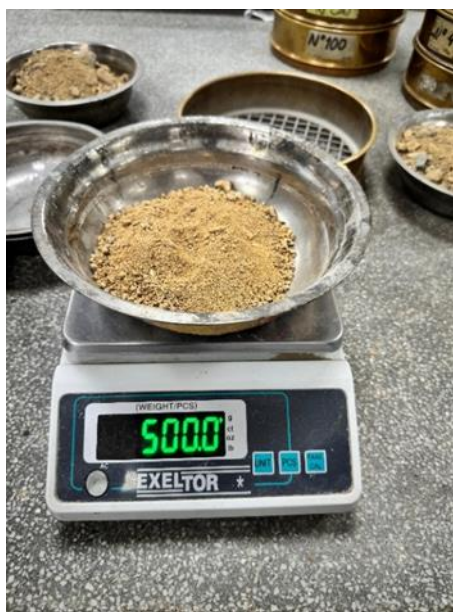
Fig. 19. Peso de la muestra de 500g para peso específico del agregado fino
