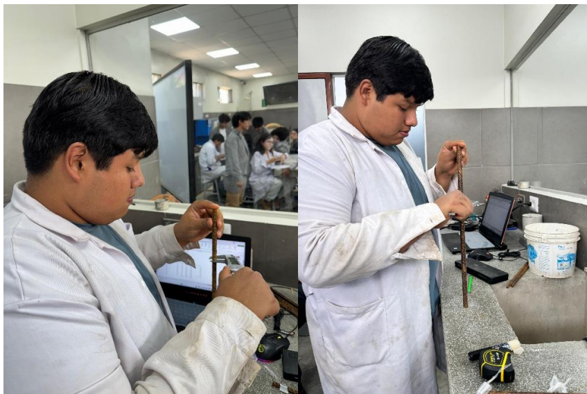
Fig. 46. Medición de diámetro residual del acero.
