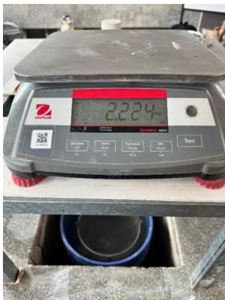
Fig. 17. Peso de la canastilla más la muestra sumergida
