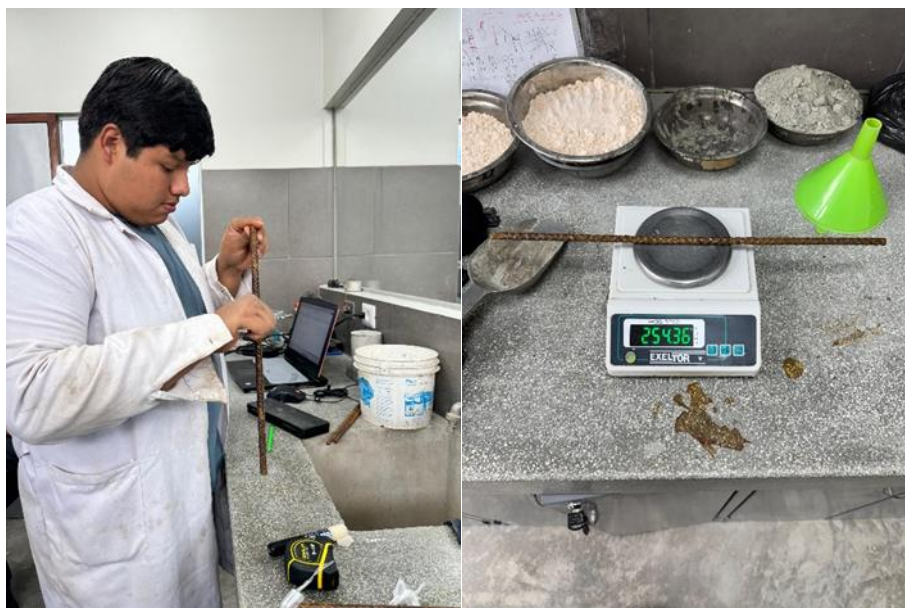
Fig. 42. Toma de diámetros y pesaje del acero
