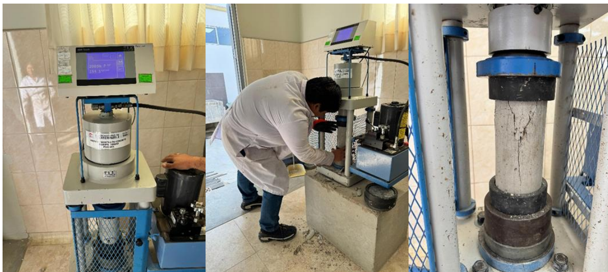
Fig. 34. Ensayo de resistencia a la compresión
