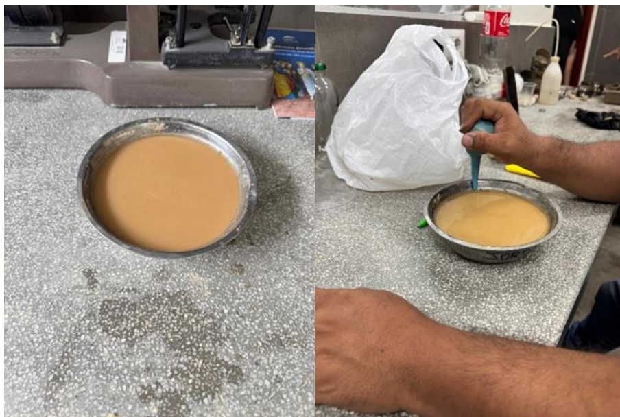
Fig. 24. Vaciado de la muestra y eliminación del agua excedente
