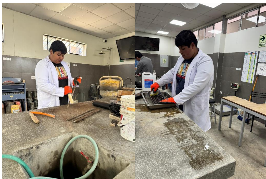
Fig. 45. Limpieza de aceros corroídos.
