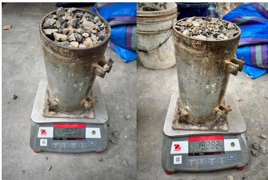
Fig. 14. Comparación de pesos compactados del agregado grueso
