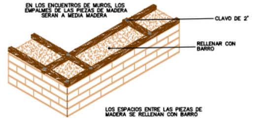
DETALLE DE VIGA COLLAR ESC: 1/20
