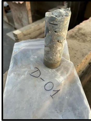
Fig. 98. Testigo D-01 de diamantina sin cortar.
