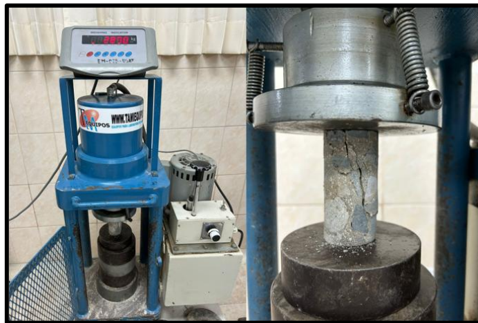
Fig. 101. Rotura de testigo D-01.
