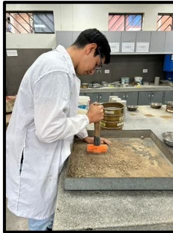
Fig. 63. Apisonado de bloque de adobe.
