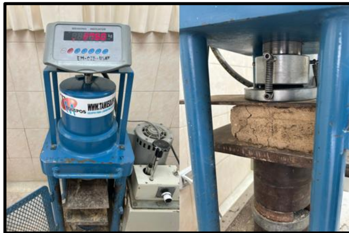
Fig. 68. Resistencia a la compresión de bloque 02.
