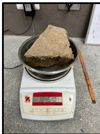
Fig. 62. Pesaje de bloque de adobe seco.
