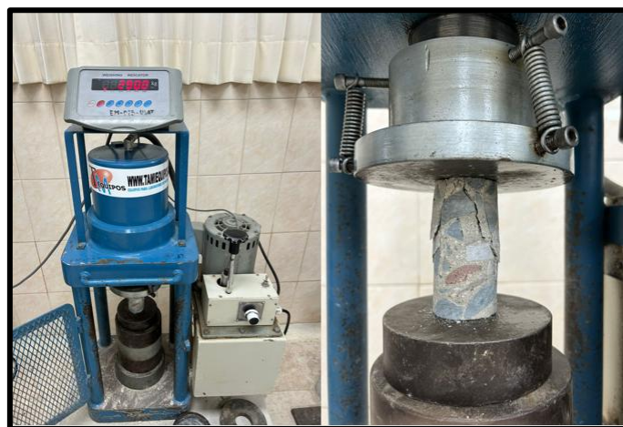
Fig. 101. Rotura de testigo D-01.
