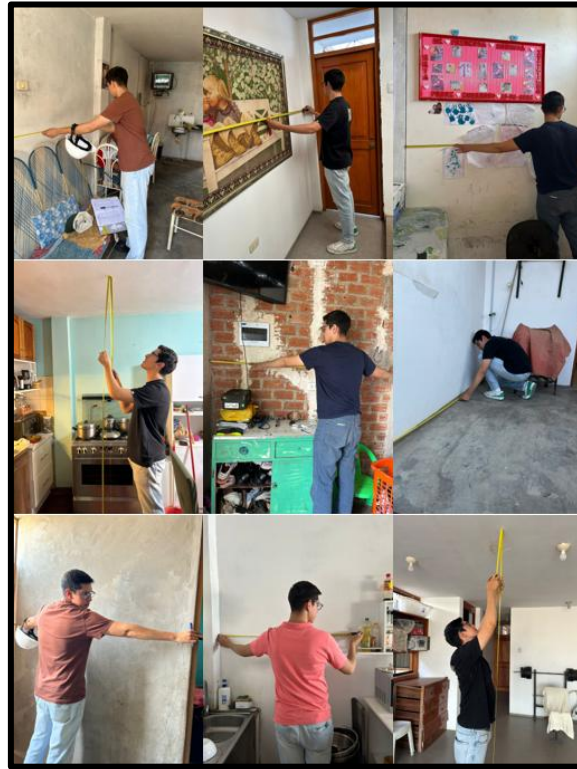
Fig. 45. Medición de muros portantes en edificaciones de albañilería.
