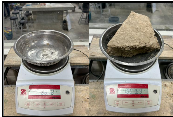
Fig. 61. Pesaje de bloque de adobe húmedo.
