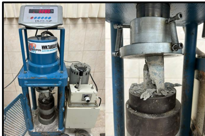
Fig. 103. Rotura de testigo D-03.
