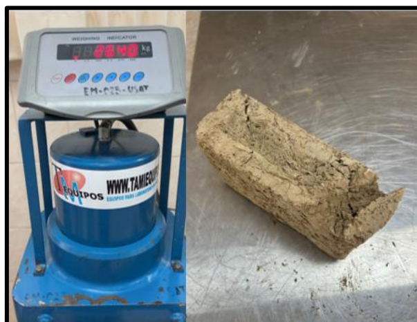
Fig. 69. Resistencia a la compresión de bloque 03.
