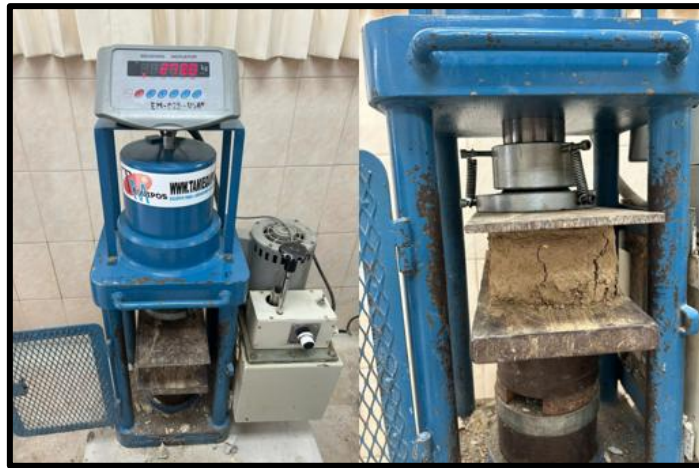
Fig. 67. Resistencia a la compresión de bloque 01.
