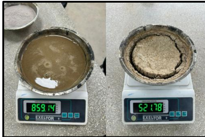
Fig. 65. Muestra de adobe antes y después del horno.
