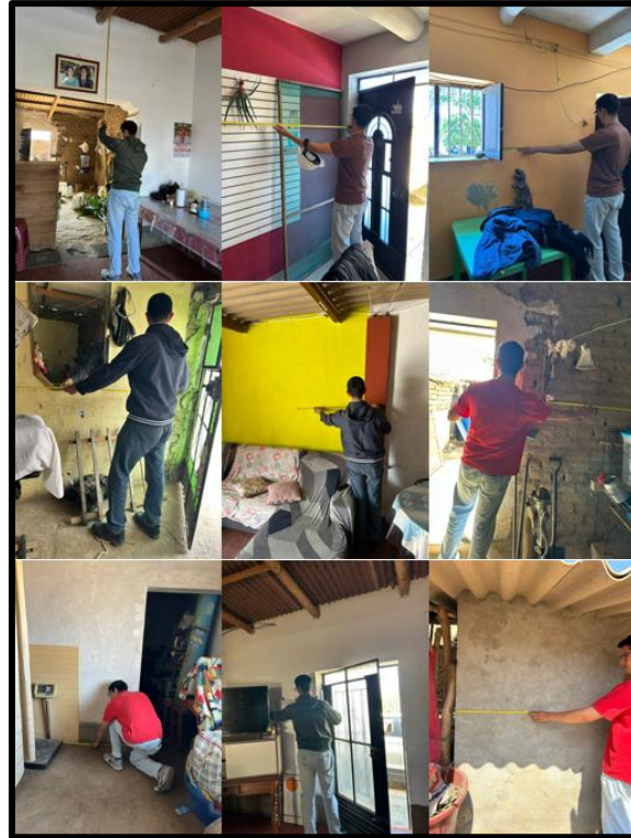
Fig. 44. Medición de muros portantes en edificaciones de adobe.
