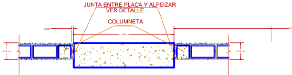
DETALLE TIPICO ENCUENTRO PLACA - MURO
