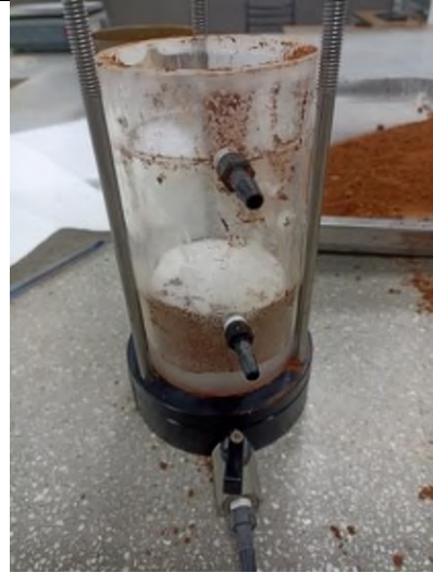
Colocación de papel filtro y piedra porosa
