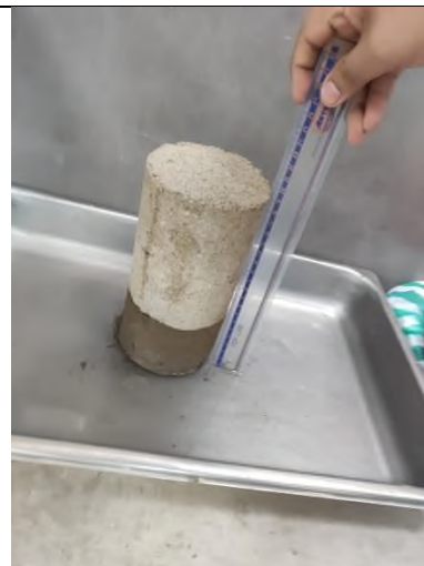
Ensayo de Ascension capilar de materiales compactado
