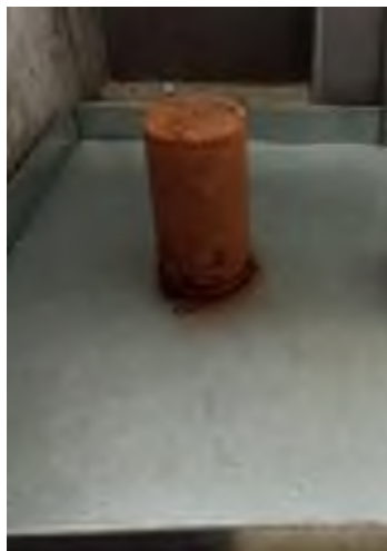
Fig. 51. Colocación en una capa de agua de 2cm. Fuente: Propia
