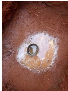
Fig. 33. Saturación de la Calicata – Suelo Tipo SC. Fuente: Propia
