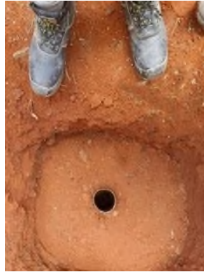
Fig. 32. Ensayo de Permeabilidad en Campo – Suelo Tipo SC. Fuente: Propia
