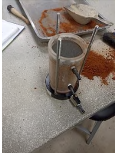
Fig. 41. Colocación de Piedra Porosa. Fuente: Propia
