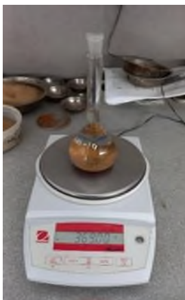
Fig. 21. G. Especifica – Suelo Tipo SC. . Fuente: Propia.
