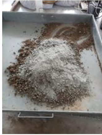
Fig. 48. Proceso de Mezclado con Solidry. Fuente: Propia
