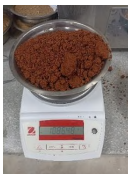
Fig. 11. Peso de Tara + Muestra Húmeda Suelo Tipo SC. Fuente: Propia.
