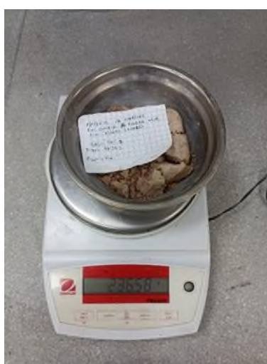
Fig. 66. Material de Arrastre sin Estabilizadores Suelo Tipo GP-GM. Fuente: Propia
