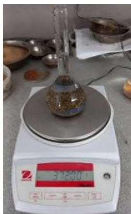
Fig. 20. G. Especifica – Suelo Tipo SP-SM. Fuente: Propia.
