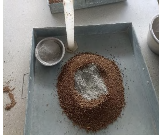
Mezclado con estabilizantes
