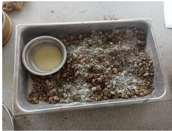
Fig. 38. Mezclado de Suelo con Consolid. Fuente: Propia
