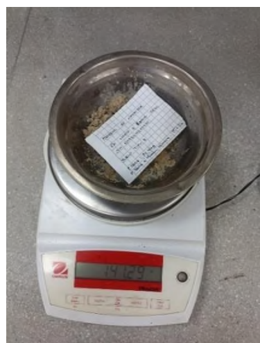
Fig. 69. Material de Arrastre con Estabilizadores Suelo Tipo GP-GM. Fuente: Propia
