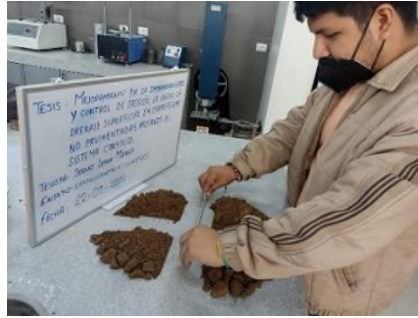
Fig. 13. Cuarteo de la Muestra Representativo. Fuente: Propia.
