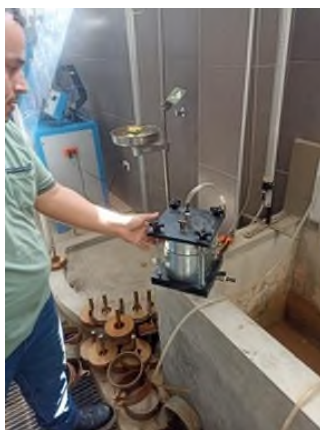
Fig. 36. Instalación del Permeámetro. Fuente: Propia
