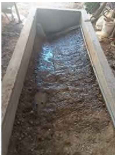
Fig. 63. Proceso de escurrimiento superficial (GP-GM). Fuente: Propia
