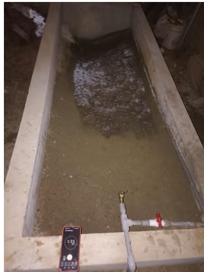
Fig. 61. Proceso de escurrimiento superficial (SP-SM). Fuente: Propia
