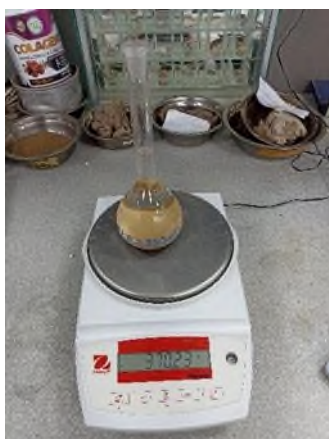
Fig. 22. G. Especifica – Suelo Tipo GP-GM. . Fuente: Propia
