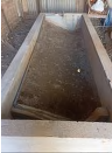
Fig. 60. Preparación de modelación de Cuneta (GP-GM). Fuente: Propia
