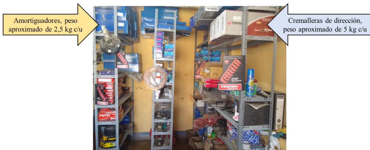
Figura 15. Riesgo por almacenar mercancía pesada en la parte superior
